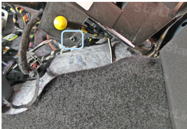
Фото 1.7. Саморез крепления перчаточного ящика снизу
