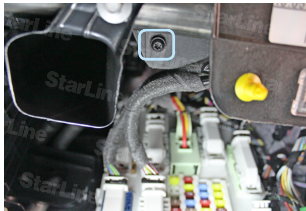
Фото 1.8. Саморез крепления перчаточного ящика снизу
