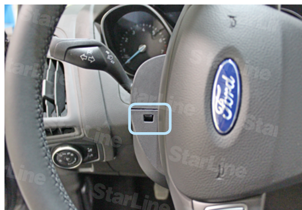
Фото 2.2. Крепление верхней части рулевого кожуха слева
