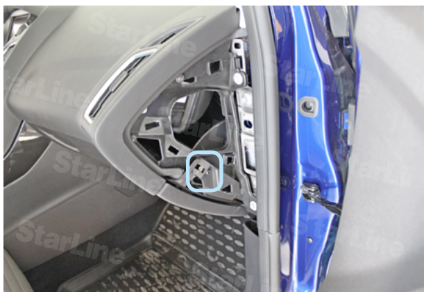
Фото 1.3. Боковая накладка передней панели снята. Саморез
