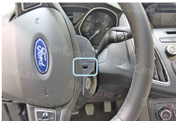
Фото 2.3. Крепление верхней части рулевого кожуха справа
