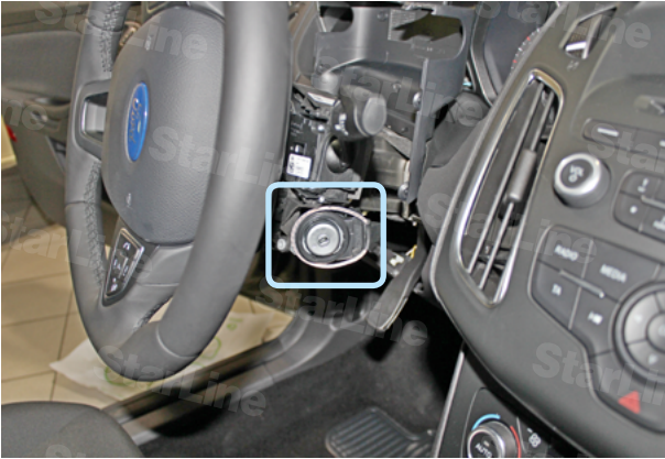
Фото 12. Антенна модуля обхода штатного иммобилайзера
