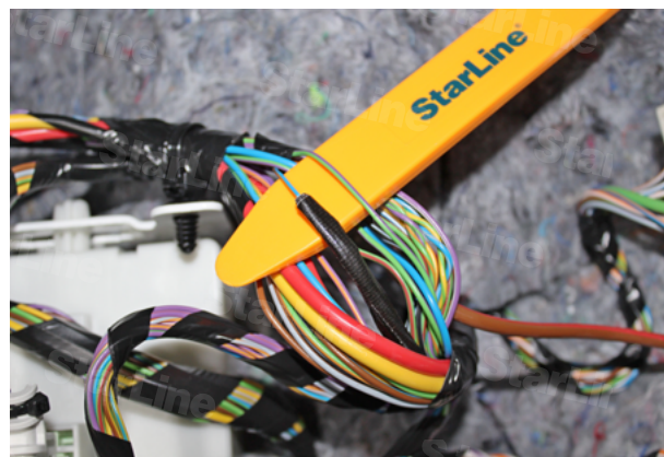
Фото 10.2. Имитация нажатия педали сцепления (сине-оранжевый и зелёно-фиолетовый)
