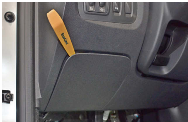
Фото 1.2. Снять крышку монтажного блока предохранителей
