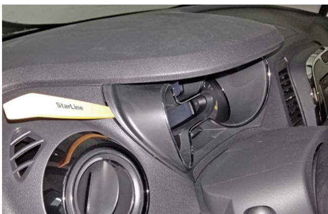
Фото 1.9. Снять декоративную накладку панели приборов
