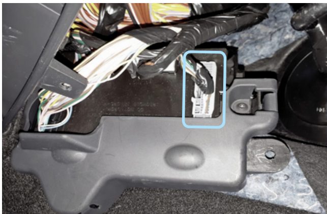
Фото 3.10. Местоположение серого разъёма S2
