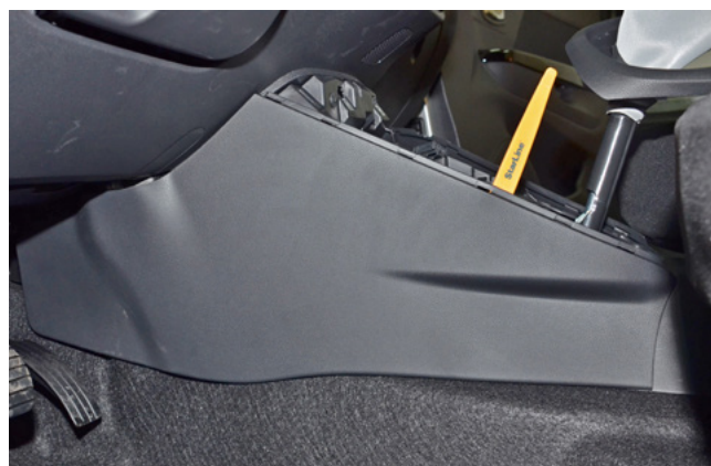
Фото 1.6. Снять боковую накладку центрального тоннеля
