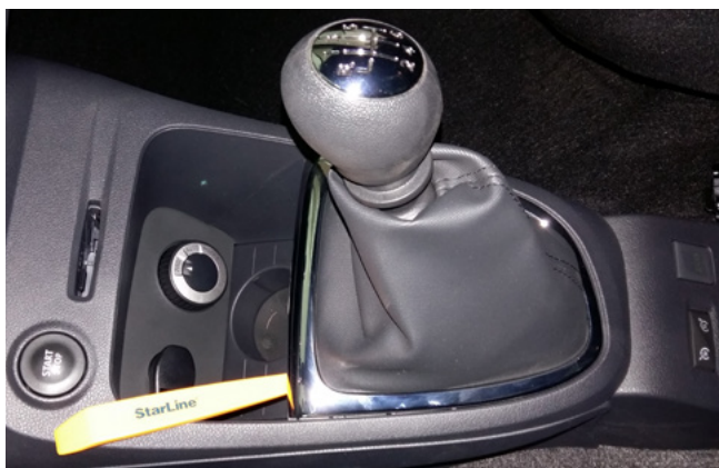
Фото 1.3. Снять декоративную накладку чехла рычага коробки передач
