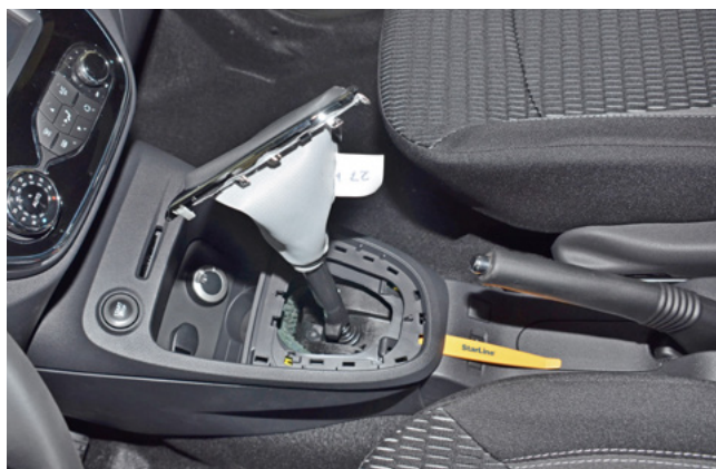
Фото 1.4. Снять верхнюю накладку центрального тоннеля
