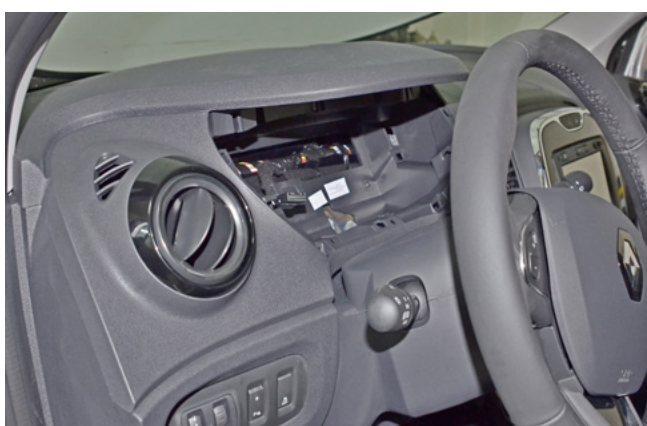
Фото 1.11. Панель приборов снята
