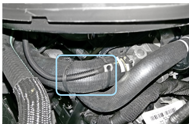
Фото 2.6. Крепление датчика температуры двигателя
