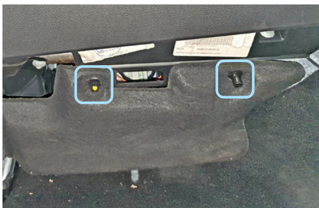
Фото 1.5. Клипсы крепления декоративной накладки под блоком GEM
