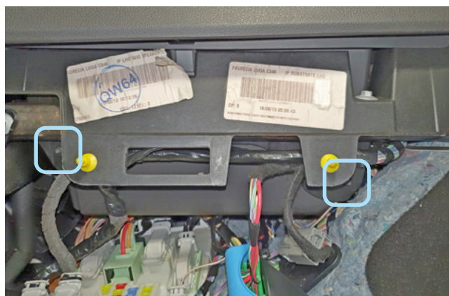
Фото 1.6. Саморезы крепления перчаточного ящика снизу
