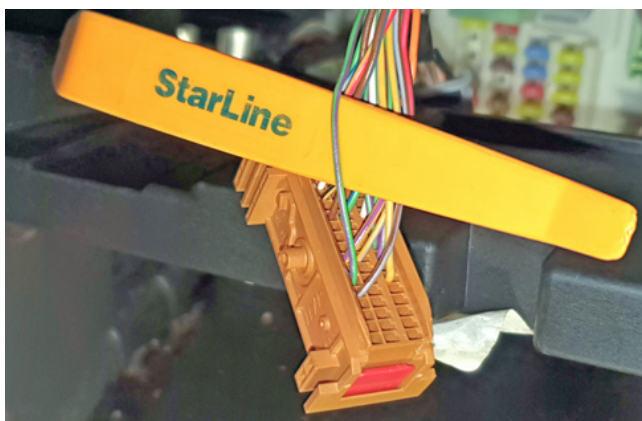
Фото 3.7. Концевик двери водителя (зелёно-фиолетовый)
