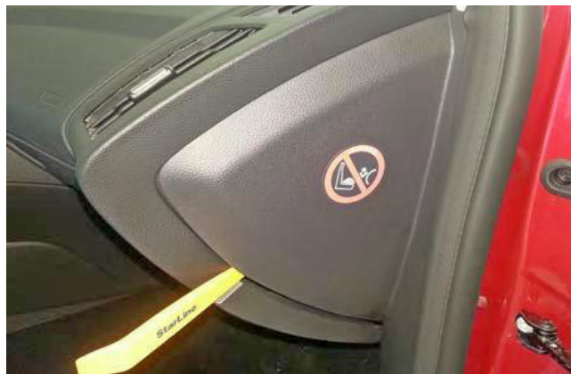
Фото 1.2. Снять боковую накладку передней панели
