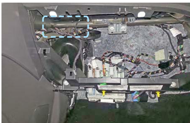
Фото 2.8. Пример расположения центрального блока охранно-телематического комплекса
