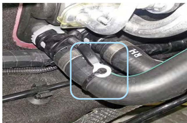
Фото 2.5. Крепление датчика температуры двигателя
