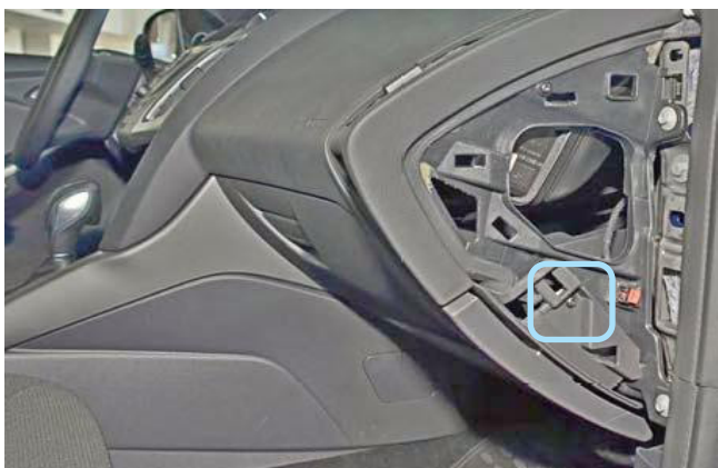
Фото 1.3. Боковая накладка снята. Саморез
