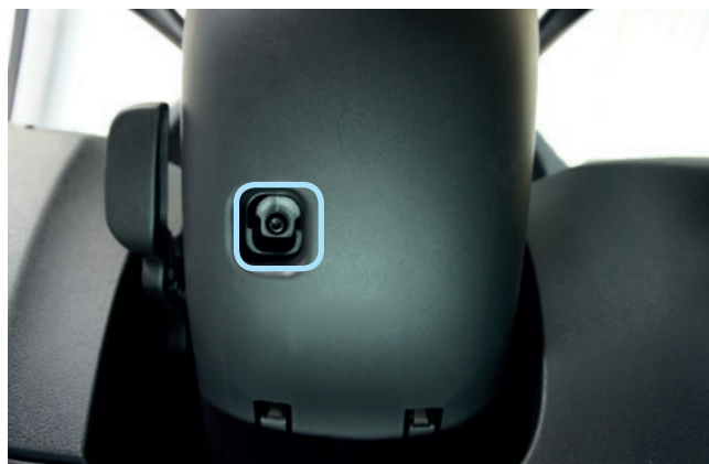
Фото 1.2. Винт крепления нижней части кожуха
