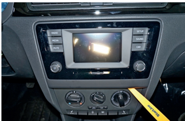
Фото 1.5. Снять декоративную накладку
