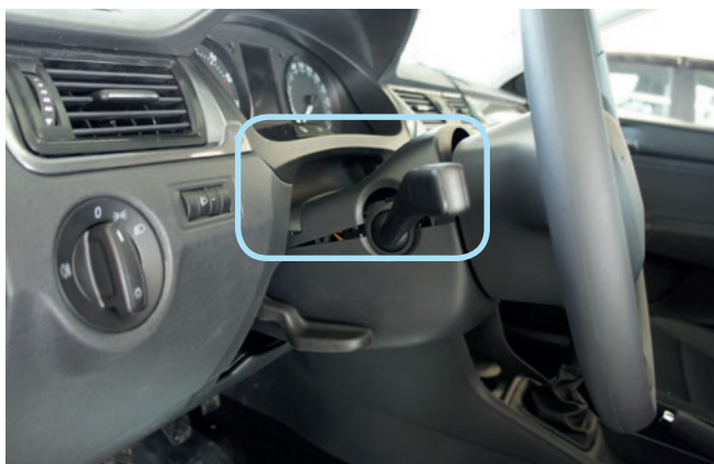
Фото 1.1. Верхняя часть кожуха рулевого вала
