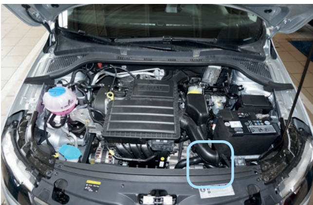
Фото 2.3. Место установки датчика температуры двигателя
