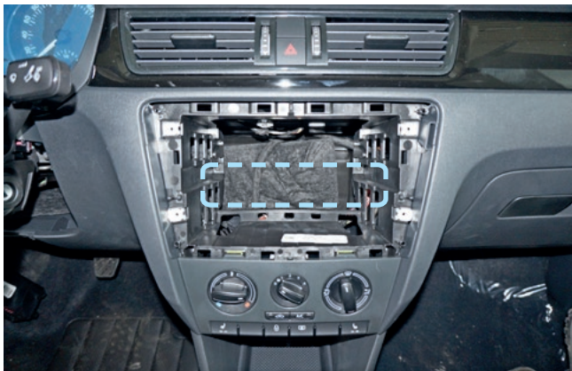
Фото 2.7. Пример расположения центрального блока охранно-телематического комплекса
