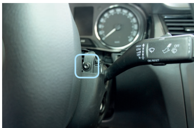
Фото 1.4. Винт крепления нижней части кожуха
