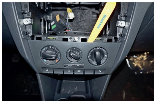
Фото 1.8. Снять декоративную накладку блока управления климат-контролем
