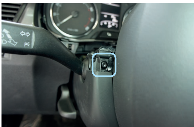
Фото 1.3. Винт крепления нижней части кожуха
