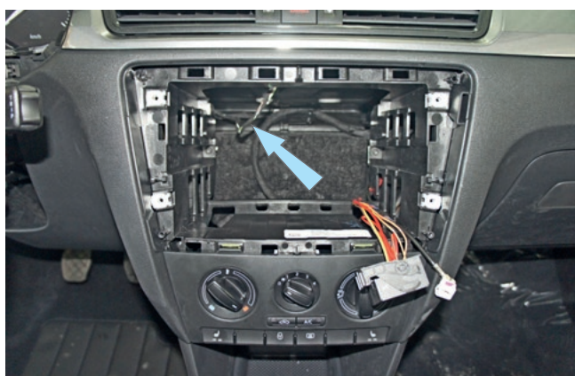
Фото 3.6. Местоположение жгута разъёма кнопки аварийной сигнализации
