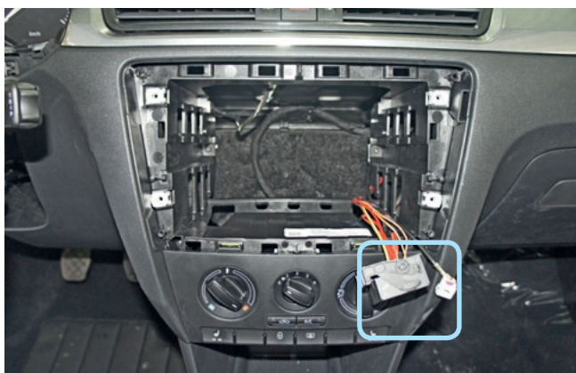
Фото 3.2. Местоположение разъёма магнитолы
