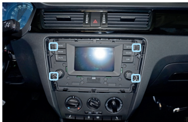
Фото 1.6. Декоративная накладка снята. Саморезы
