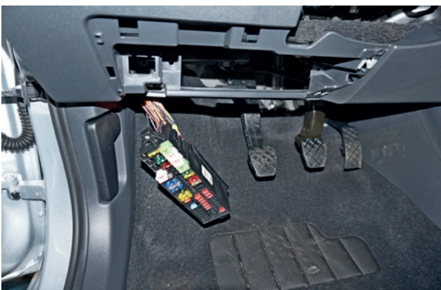
Фото 1.14. Монтажный блок предохранителей снят
