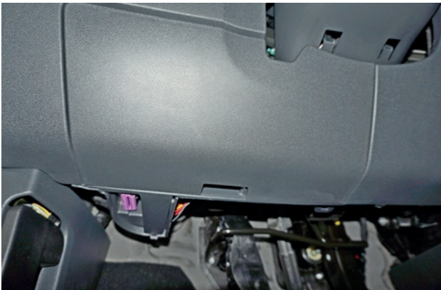
Фото 1.12. Крышка монтажного блока предохранителей
