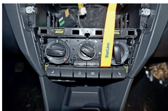
Фото 1.10. Снять блок кнопок
