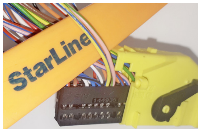
Фото 3.4. Шина CAN-A (розово-зелёный и жёлто-синий)
