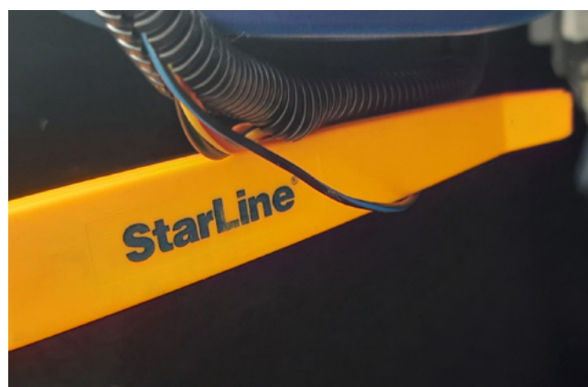
Фото 3.10. Концевик багажника (сине-чёрный)
