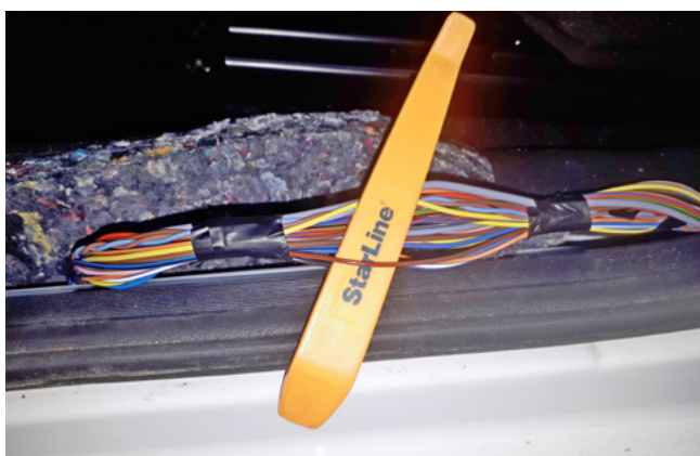
Фото 3.7. Концевик двери водителя (коричнево-красный)
