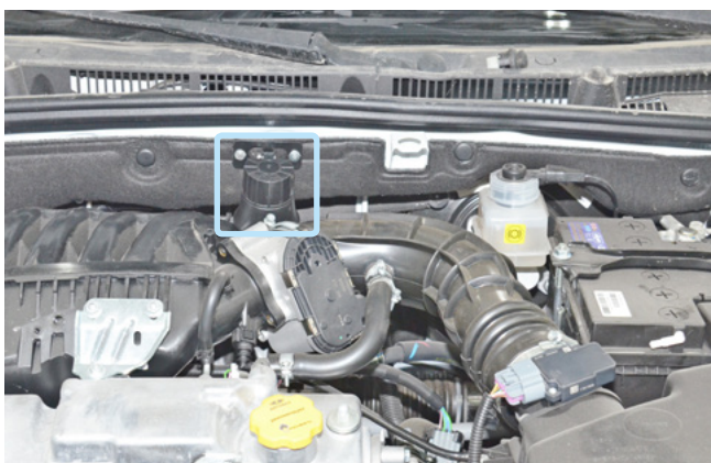
Фото 2.2. Возможное место установки сирены
