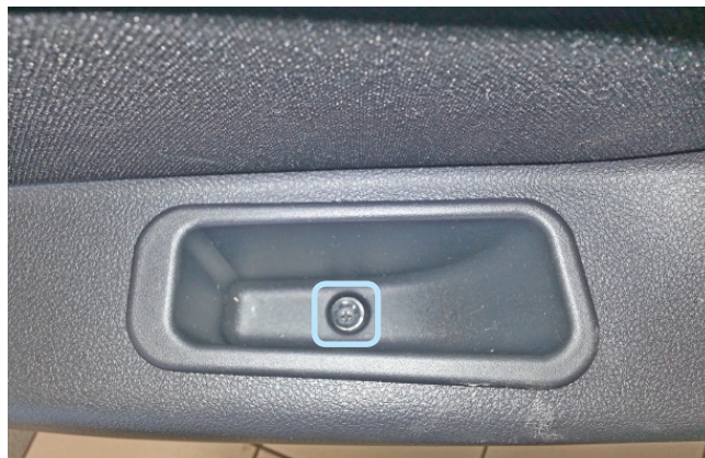
Фото 3.12. Саморез крепления обшивки двери водителя
