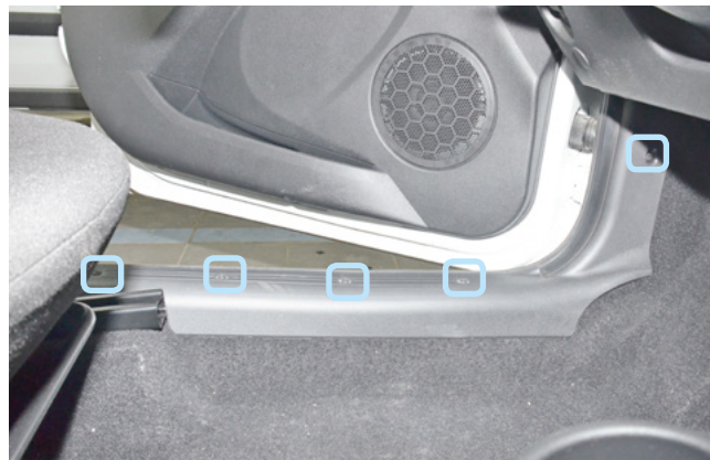
Фото 1.2. Саморезы декоративной накладки порога
