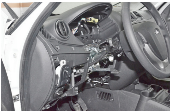
Фото 1.12. Панель приборов снята
