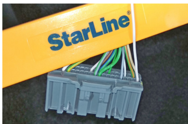
Фото 3.7. Контроль концевика капота (белый)
