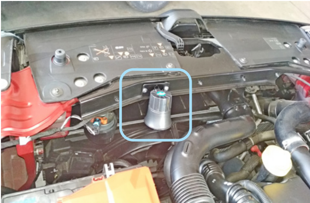
Фото 2.2. Возможное место установки сирены
