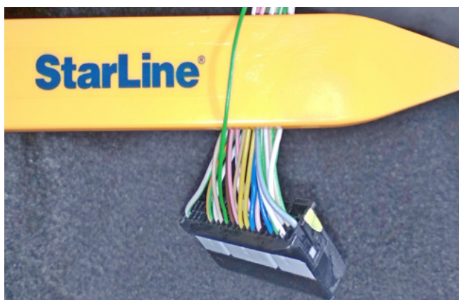
Фото 3.5. Концевик двери водителя (зелёный)
