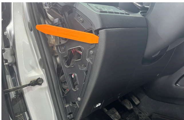
Фото 1.3. Боковая накладка снята. Снять крышку блока предохранителей
