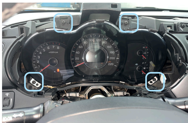
Фото 1.14. Саморезы крепления панели приборов
