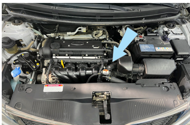
Фото 2.4. Место установки датчика температуры двигателя
