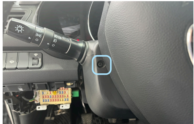
Фото 1.8. Саморез крепление кожуха рулевого вала. Слева
