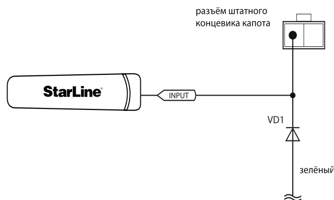
Схема 1. Подключение к штатному концевика капота
