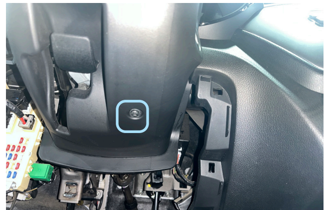
Фото 1.10. Саморез крепление кожуха рулевого вала. Снизу
