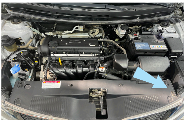
Фото 2.6. Возможное место установки концевика капота
