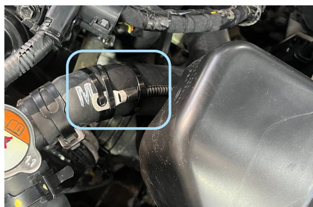
Фото 2.5. Установка датчика температуры двигателя
