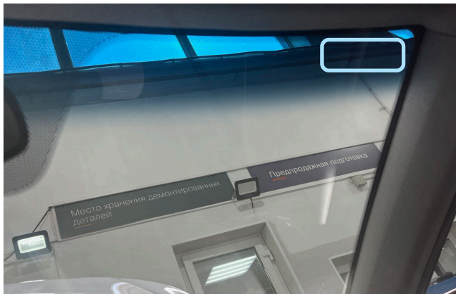
Фото 2.1. Возможное место установки антенны (Трансивера)
