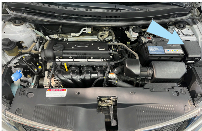
Фото 2.7. Возможное место установки подкапотного блока R6
