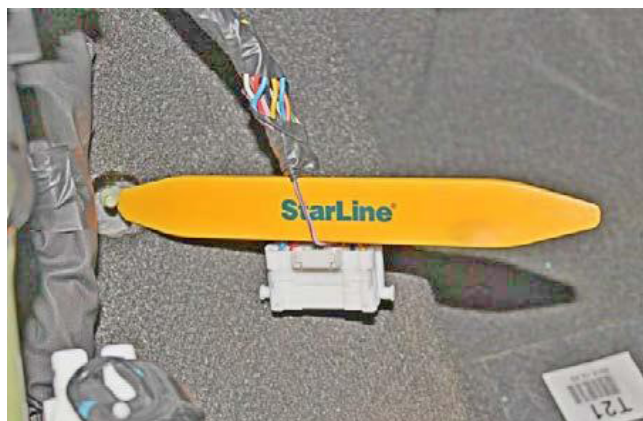
Фото 3.5. Контроль концевиков дверей (розово-чёрный)
