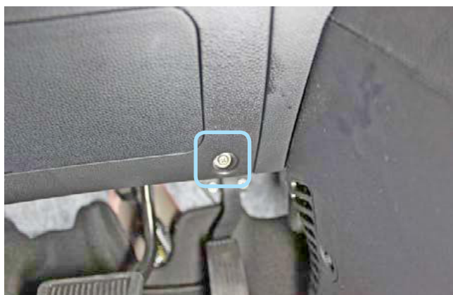
Фото 1.5. Саморез крепления накладки под рулевой колонкой справа
