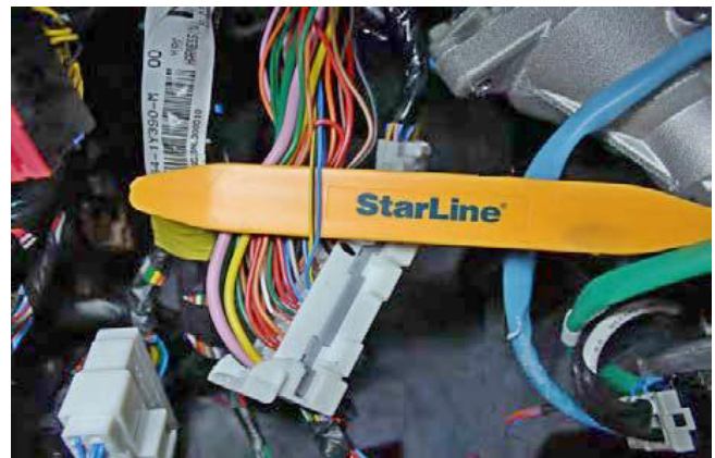
Фото 3.12. Управление центральным замком (синий и жёлто-чёрный)
