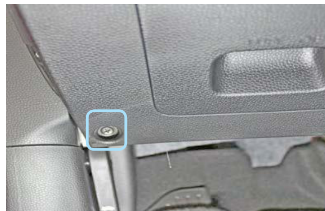
Фото 1.4. Саморез крепления накладки под рулевой колонкой слева
