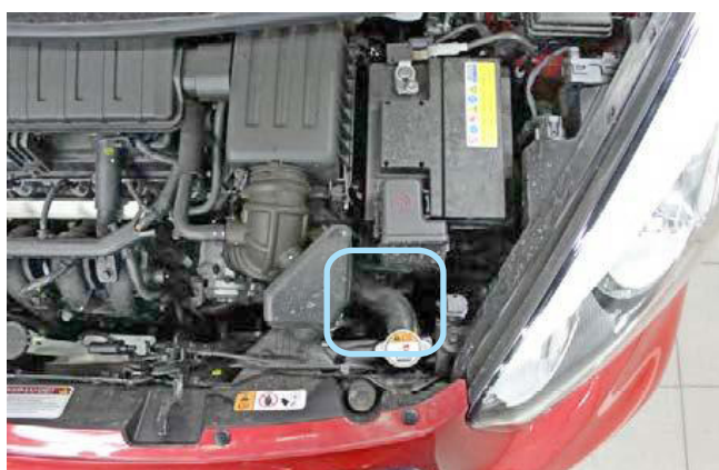
Фото 2.5. Место установки датчика температуры двигателя
