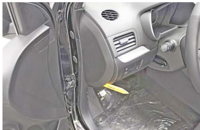
Фото 1.2. Снять левую боковую накладку передней панели
