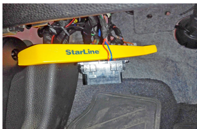
Фото 3.3. Шина CAN-A (красный и синий)
