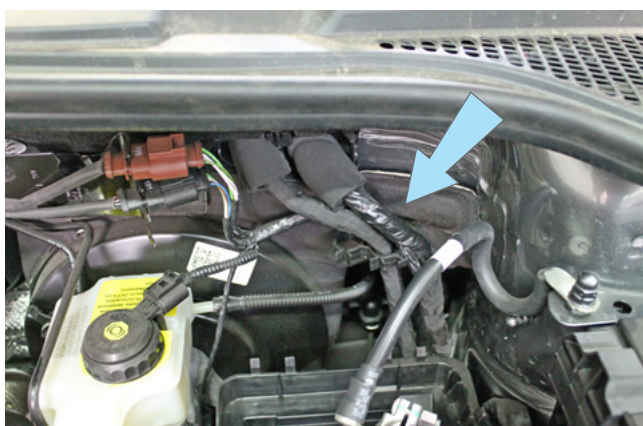
Фото 2.8. Жгут за аккумуляторной батареей
