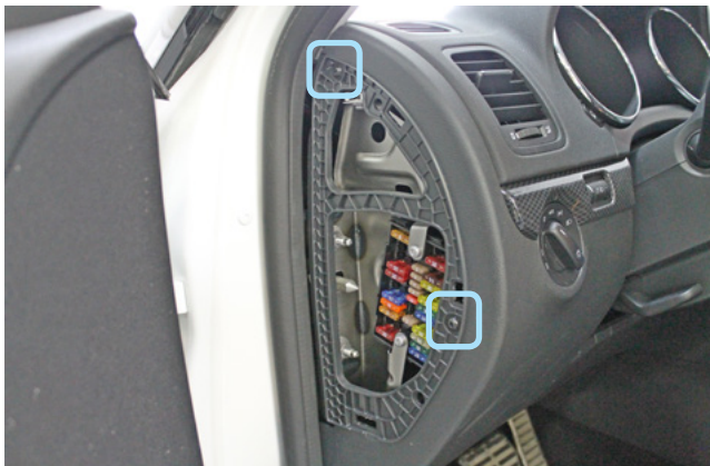
Фото 1.3. Боковая накладка передней панели снята. Саморезы
