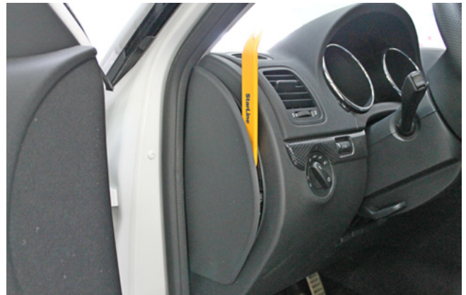
Фото 1.2. Снять левую боковую накладку передней панели
