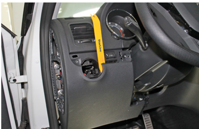
Фото 1.11. Снять пластиковую накладку под рулевой колонкой
