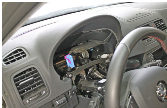
Фото 1.18. Панель приборов снята
