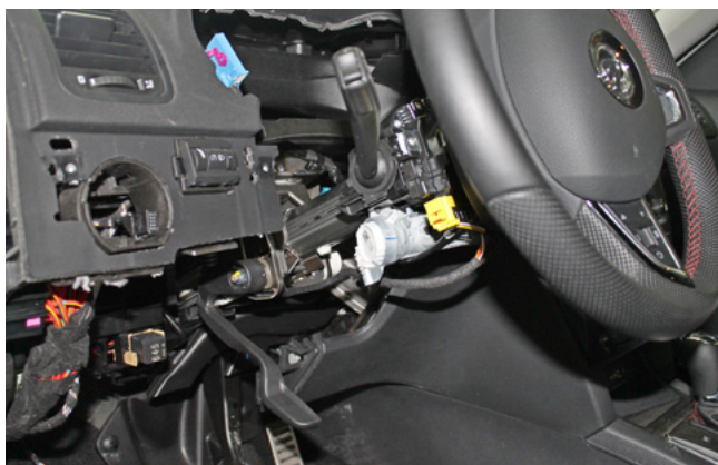
Фото 1.23. Нижняя часть кожуха рулевого вала снята
