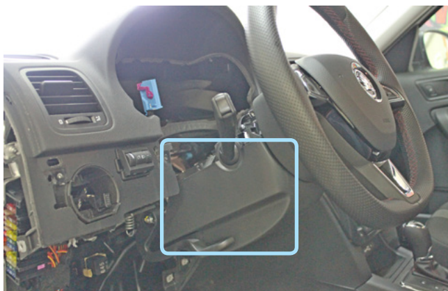
Фото 1.19. Нижняя часть кожуха рулевого вала
