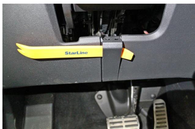
Фото 1.8. Снять пластиковую заглушку под рулевой колонкой
