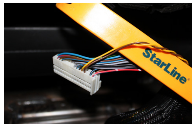
Фото 3.5. Шина CAN-B (коричневый и жёлтый)
