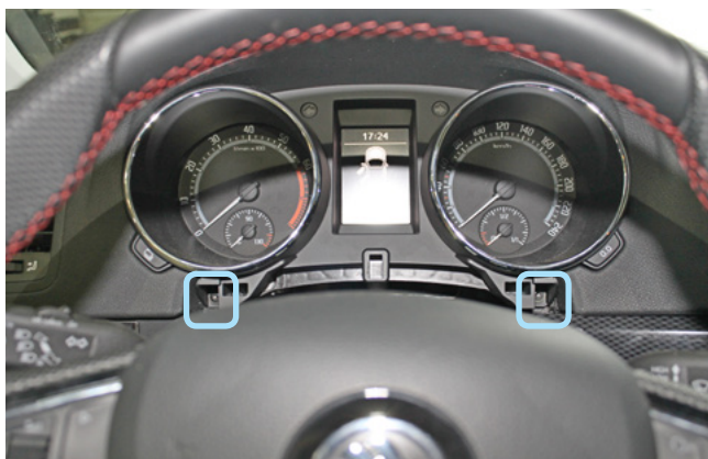
Фото 1.17. Саморезы крепления панели приборов
