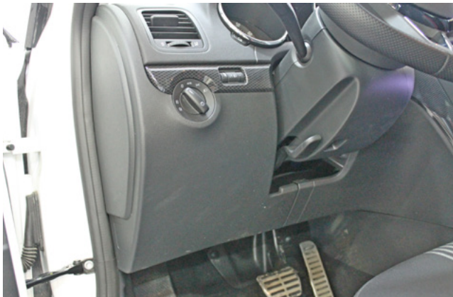
Фото 1.1. Пластиковая накладка под рулевой колонкой. Общий вид
