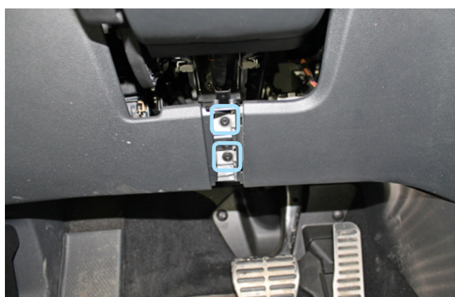
Фото 1.9. Пластиковая заглушка под рулевой колонкой снята. Саморезы
