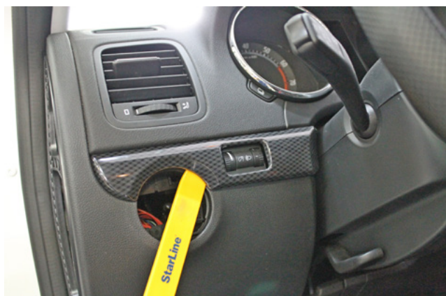
Фото 1.6. Снять пластиковую накладку над переключателем света
