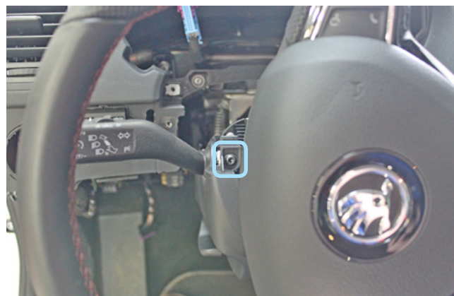
Фото 1.20. Винт крепления нижней части кожуха рулевого вала слева
