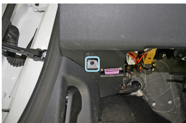
Фото 1.10. Саморез крепления пластиковой наклейки
