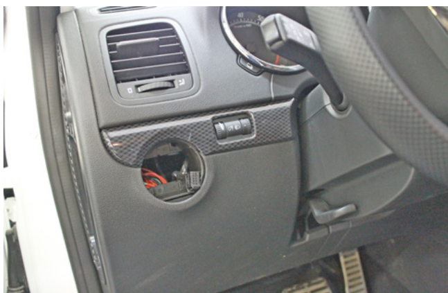
Фото 1.5. Переключатель света снят
