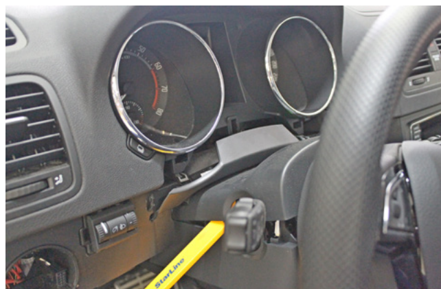
Фото 1.16. Снять верхнюю часть кожуха рулевого вала
