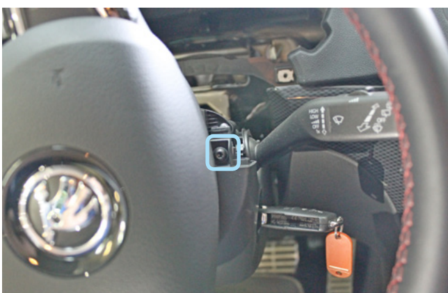
Фото 1.21. Винт крепления нижней части кожуха рулевого вала справа
