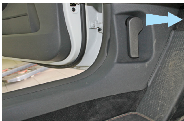
Фото 1.25. Сдвинуть фиксатор ручки отпирания капота в направлении стрелки
