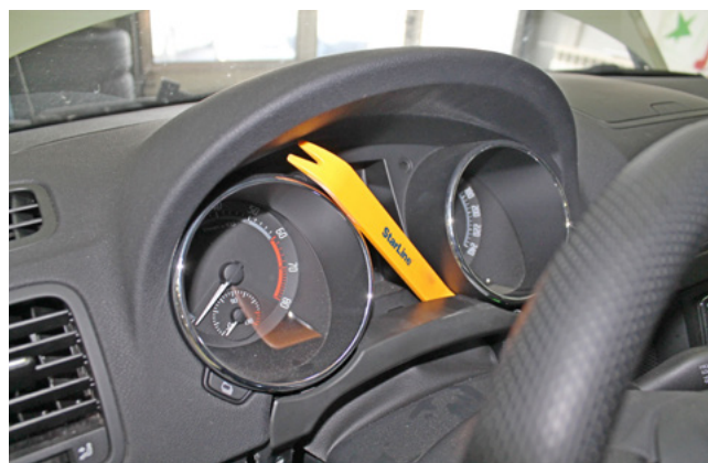
Фото 1.14. Снять декоративную накладку снизу панели приборов
