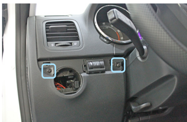
Фото 1.7. Пластиковая накладка над переключателем света снята. Саморезы
