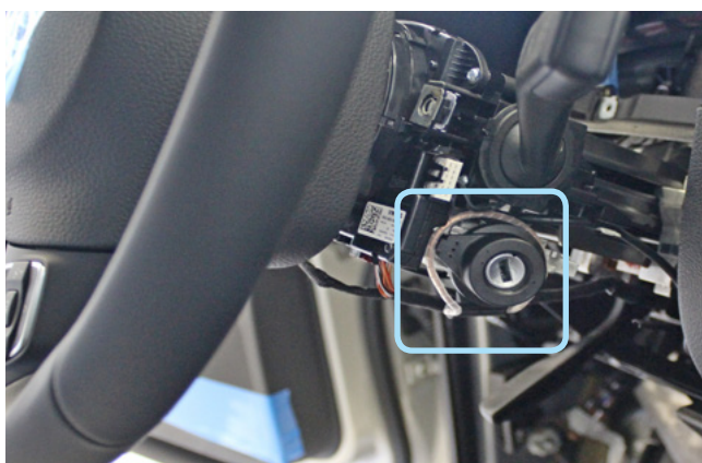
Фото 3.14. Антенна модуля обхода штатного иммобилайзера на замке зажигания
