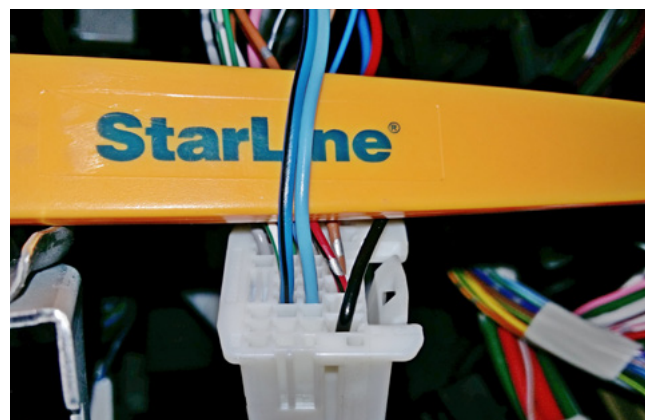
Фото 3.7. Управление центральным замком (синий и сине-чёрный)
