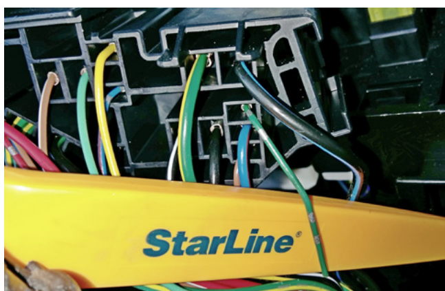
Фото 2.11. Подключение цепи зажигания (зелёный)
