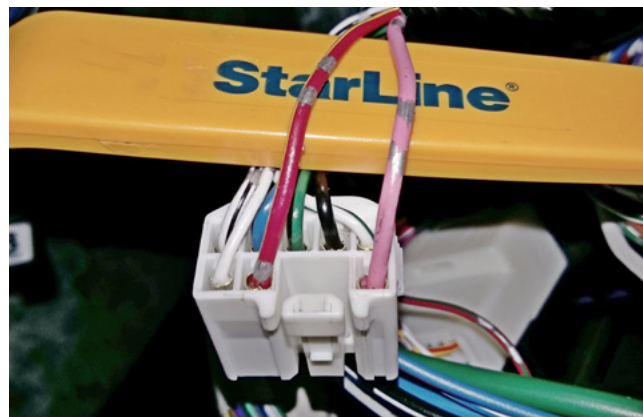
Фото 3.9. Управление световыми сигналами (розовый и красно-жёлтый)
