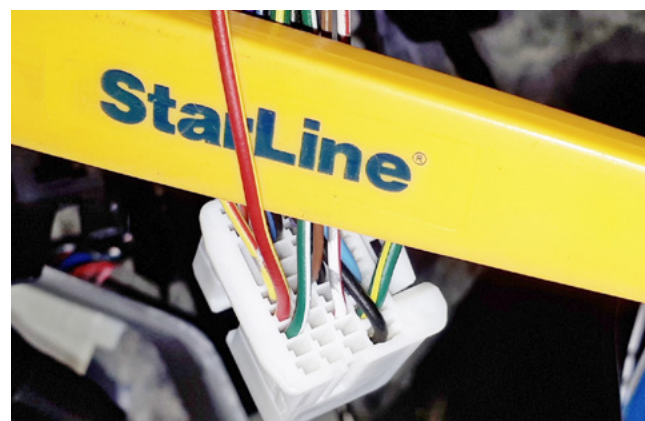
Фото 3.5. Шина данных штатного иммобилайзера (красно-жёлтый)
