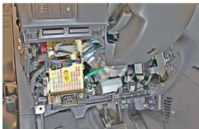
Фото 1.6. Накладка под рулевой колонкой снята
