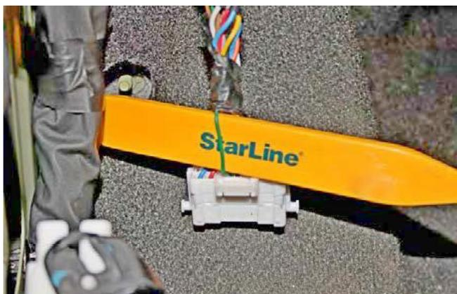
Фото 3.6. Контроль концевика багажника (зелёный)
