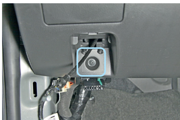
Фото 1.5. Саморез крепления наклейки под рулевой колонкой
