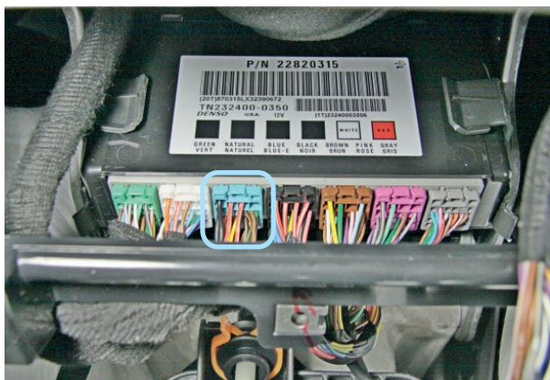
Фото 14.1. Местоположение синего (BLUE) разъёма блока BCM
