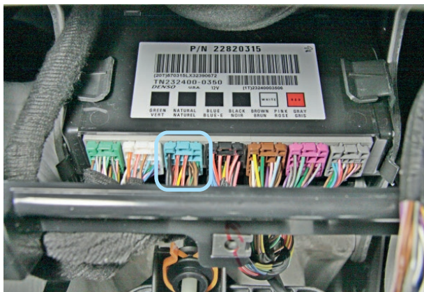
Фото 8.1. Местоположение синего (BLUE) разъёма блока BCM
