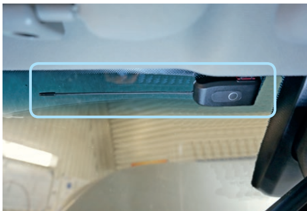
Фото 4.1. Возможное место установки антенного модуля
