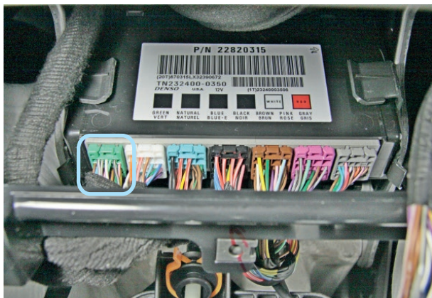
Фото 10.1. Местоположение зелёного (GREEN) разъёма блока BCM
