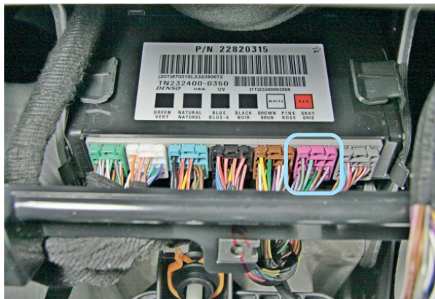
Фото 12.1. Местоположение розового (PINK) разъёма блока BCM
