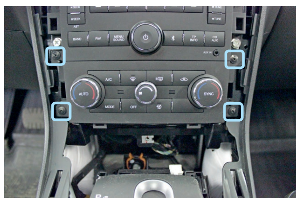
Фото 2.4. Саморезы крепления блока управления климат-контролем
