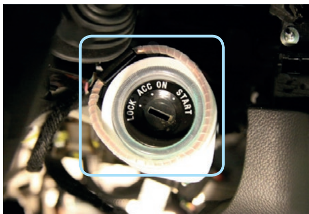
Фото 13. Расположение антенны модуля BP-03 на замке зажигания
