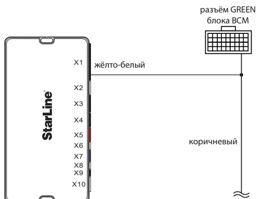
Схема 1. Управление световыми сигналами
