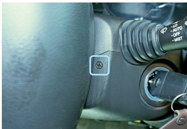
Фото 3.3. Саморез крепления кожуха рулевого вала
