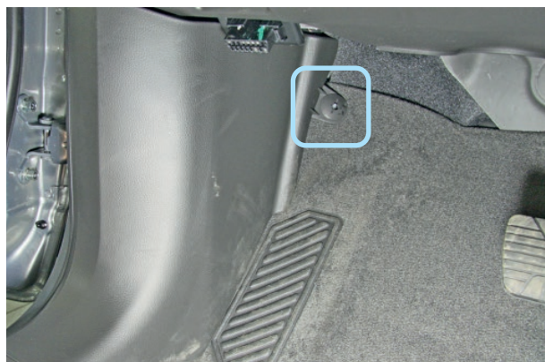
Фото 1.3. Клипса крепления наклейки кик-панели
