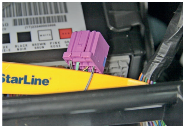
Фото 12.2. Концевик двери водителя (серо-чёрный)
