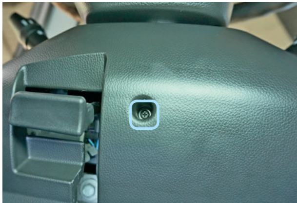
Фото 3.1. Винт крепления кожуха рулевого вала
