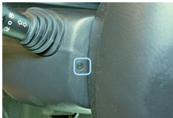
Фото 3.2. Саморез крепления кожуха рулевого вала
