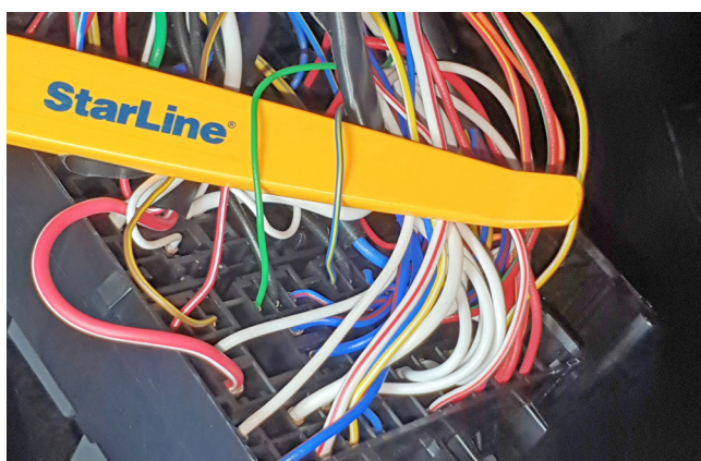
Фото 3.7. Управление центральным замком (зелёный и сине-жёлтый)
