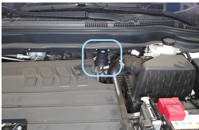
Фото 2.2. Возможное место установки сирены
