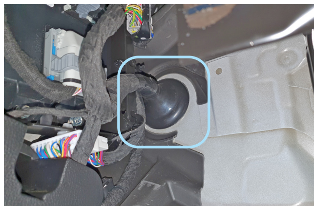
Фото 2.7. Штатный уплотнитель. Вид со стороны салона
