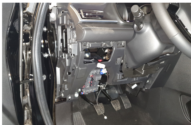
Фото 1.4. Пластиковая накладка под рулевой колонкой снята
