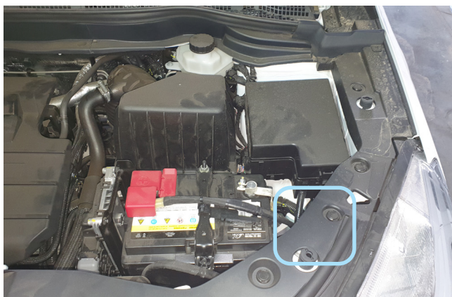
Фото 2.6. Возможное место установки концевика капота
