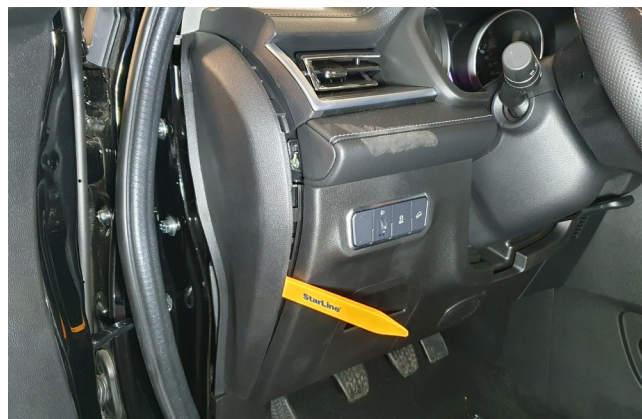
Фото 1.2. Снять боковую накладку передней панели
