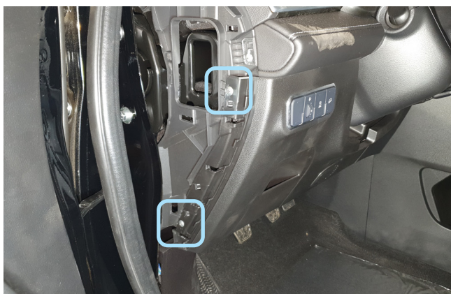
Фото 1.3. Накладка снята. Саморезы
