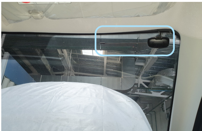
Фото 2.1. Возможное место установки антенного модуля
