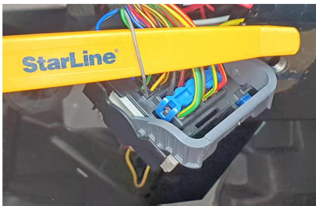
Фото 3.6. Альтернативное управление световыми сигналами (серый)
