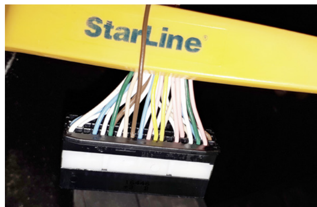
Фото 3.13. Имитация открытия двери водителя (коричневый)
