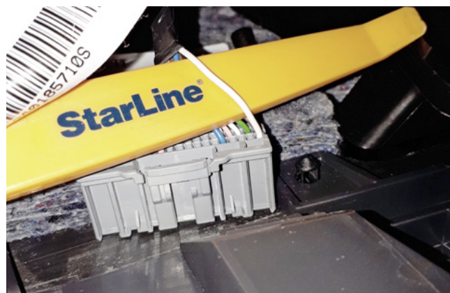
Фото 3.5. Контроль концевика капота (белый)
