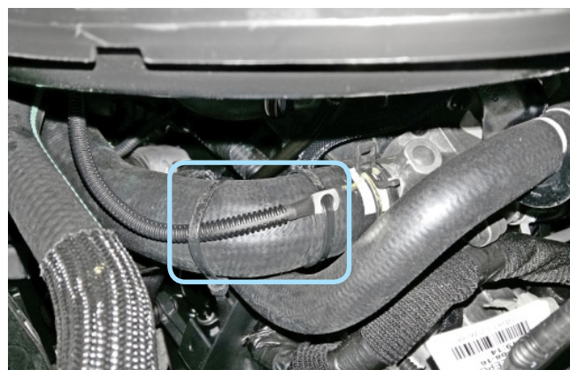
Фото 2.4. Крепление датчика температуры двигателя
