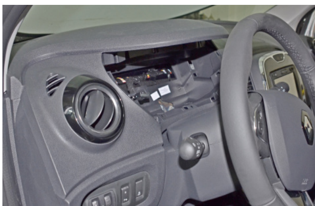
Фото 1.11. Панель приборов снята
