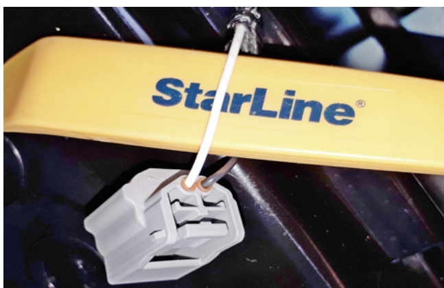
Фото 2.10. Контроль концевика капота (белый)
