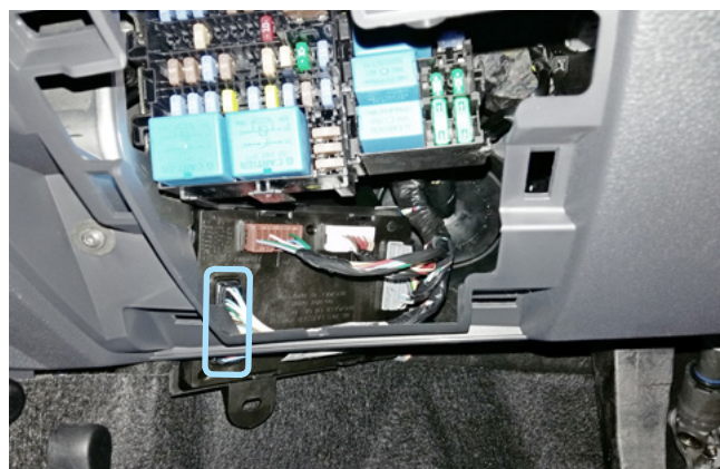
Фото 3.12. Местоположение серого разъёма S1
