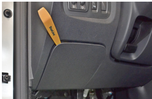
Фото 1.2. Снять крышку монтажного блока предохранителей
