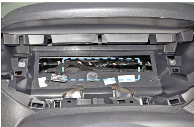
Фото 2.11. Пример расположения центрального блока охранно-телематического комплекса
