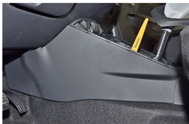
Фото 1.6. Снять левую накладку центрального тоннеля
