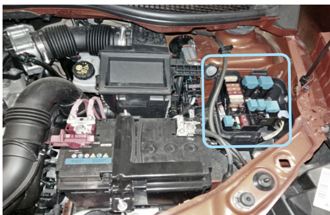
Фото 2.6. Возможное место установки подкапотного блока R6
