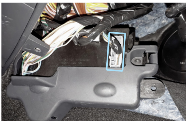
Фото 3.4. Местоположение разъёма S2
