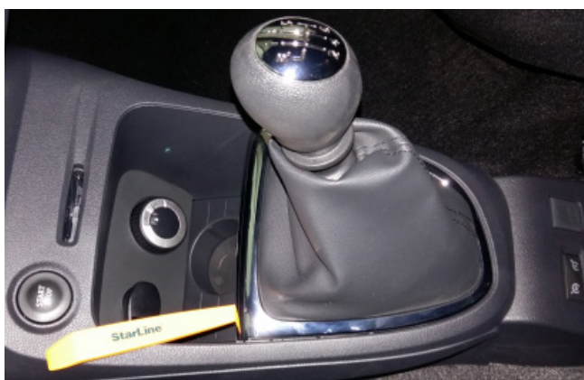
Фото 1.3. Снять декоративную накладку чехла рычага коробки передач
