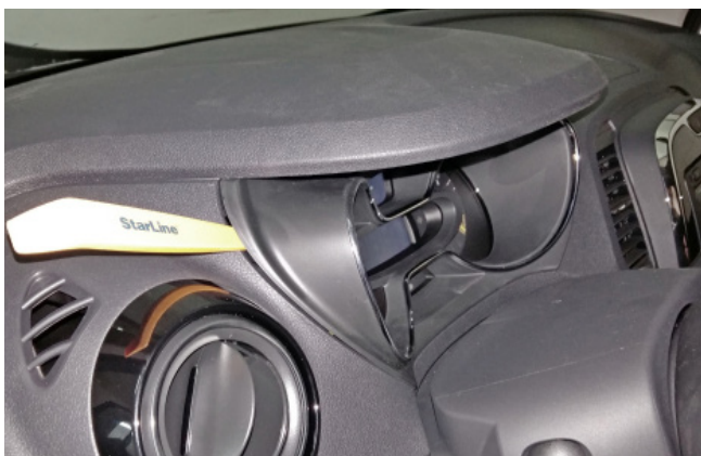
Фото 1.9. Снять декоративную накладку панели приборов
