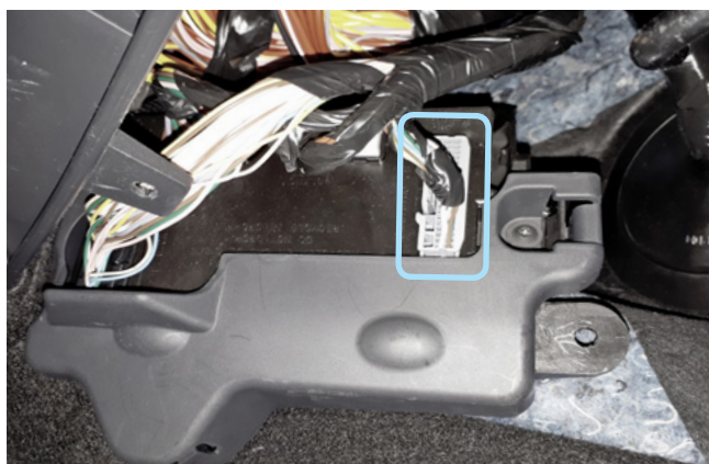
Фото 3.10. Местоположение серого разъёма S2
