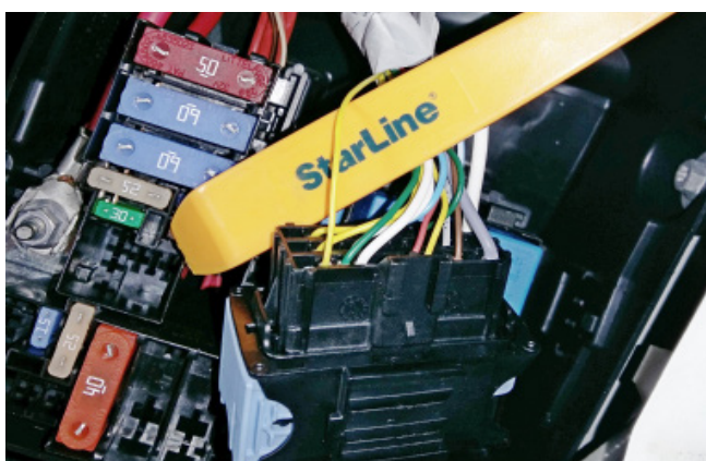
Фото 2.8. Подключение цепи зажигания (жёлтый)
