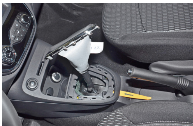
Фото 1.4. Снять накладку центрального тоннеля
