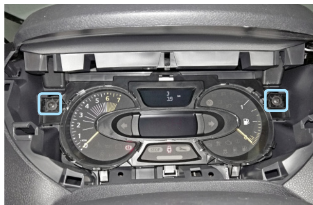
Фото 1.10. Саморезы панели приборов
