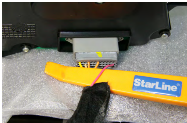
Фото 3.6. Контроль концевиков дверей и багажника (розовый)
