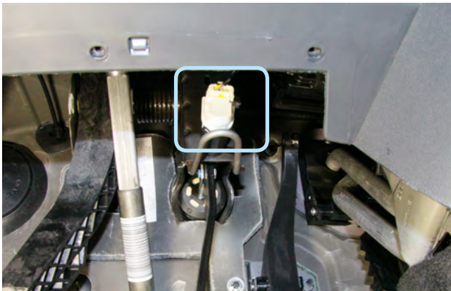
Фото 3.11. Местоположение разъёма педали тормоза
