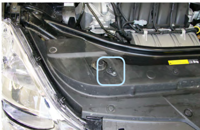
Фото 2.5. Возможное место установки концевика капота
