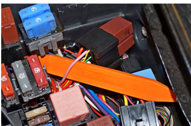
Фото 2.9. Подключение цепи зажигания (розовый)
