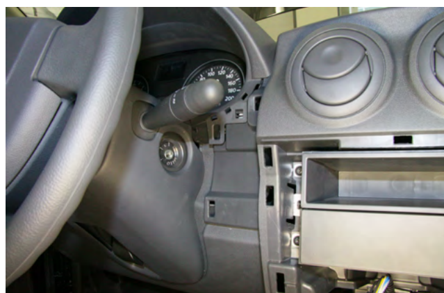
Фото 1.6. Декоративная накладка справа от рулевой колонки снята
