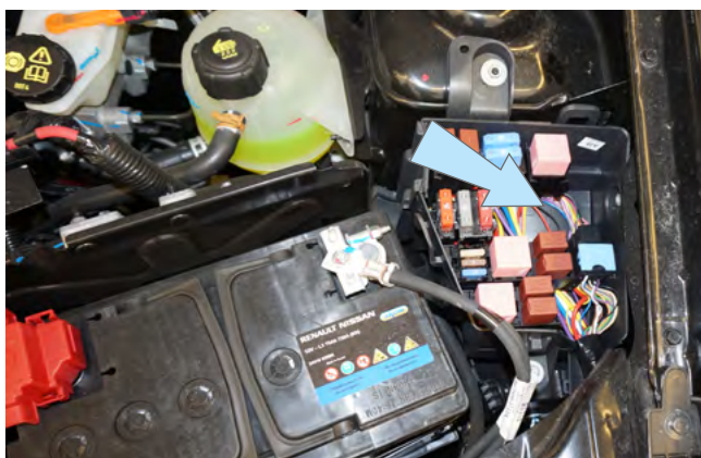
Фото 2.7. Возможное место установки подкапотного блока R6
