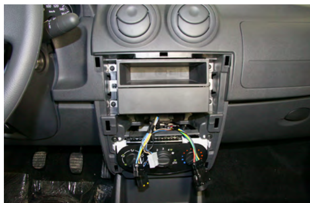
Фото 1.4. Декоративная накладка центральной консоли снята
