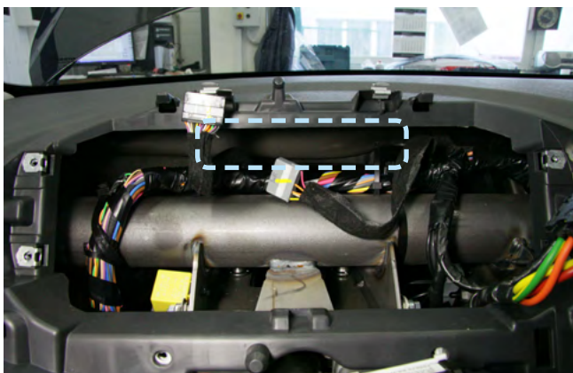
Фото 2.11. Пример расположения центрального блока охранно-телематического комплекса
