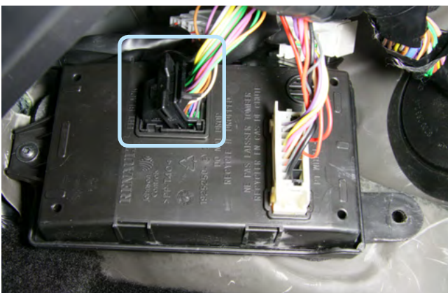
Фото 3.13. Местоположение разъёма блока BCM
