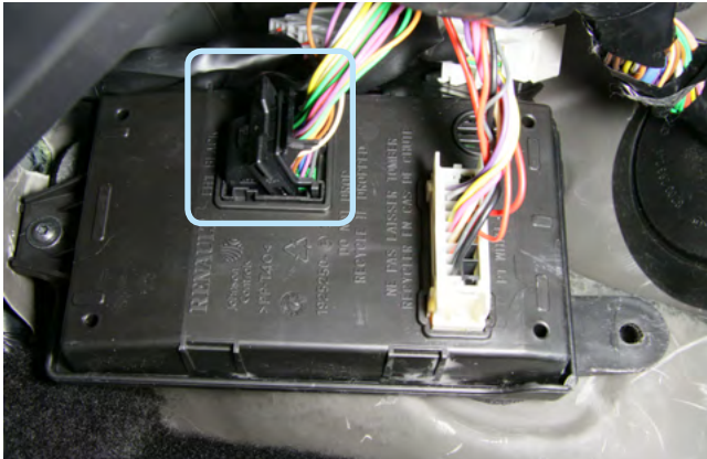
Фото 3.9. Местоположение разъёма блока BCM
