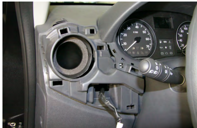
Фото 1.2. Декоративная накладка с воздуховодом снята
