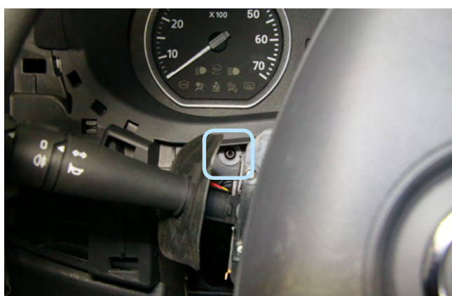
Фото 1.11. Саморез крепления накладки панели приборов
