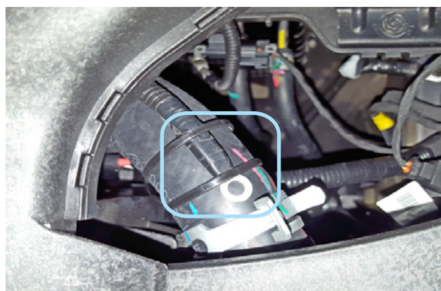
Фото 2.6. Крепление датчика температуры двигателя
