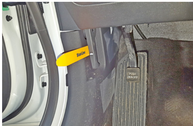
Фото 1.2. Снять ручку отпирания капота
