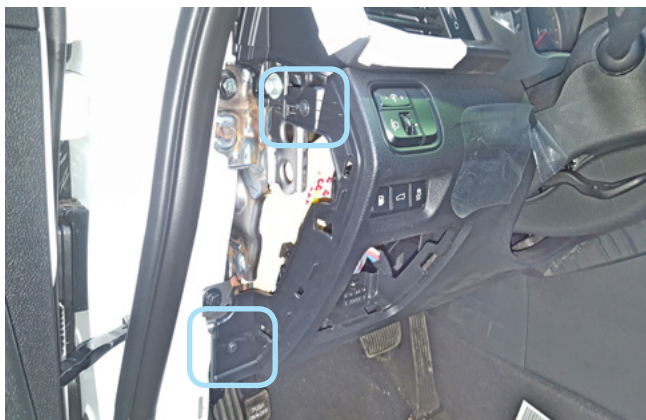
Фото 1.7. Накладка снята. Саморезы
