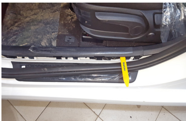
Фото 1.3. Снять накладку порога двери водителя
