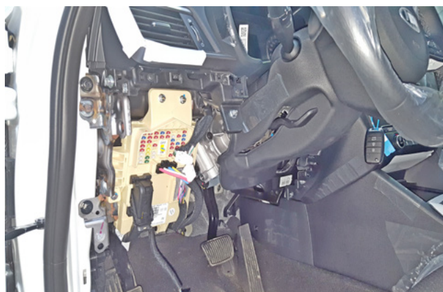
Фото 1.10. Пластиковая накладка под рулевой колонкой снята
