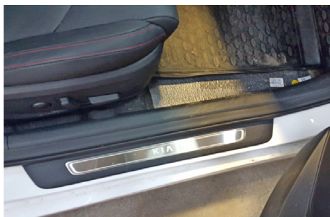
Фото 1.16. Накладка порога двери пассажира снята
