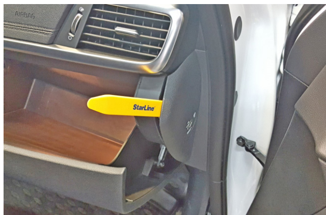
Фото 1.14. Снять правую боковую накладку передней панели
