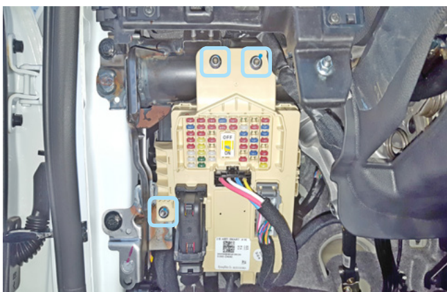
Фото 1.11. Крепление монтажного блока предохранителей
