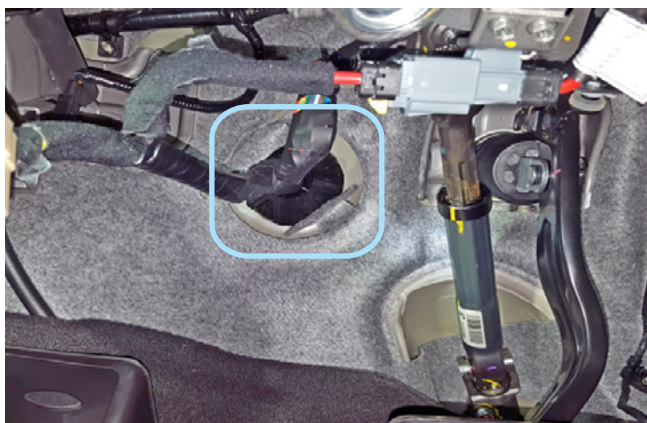
Фото 2.7. Штатный уплотнитель. Вид со стороны салона
