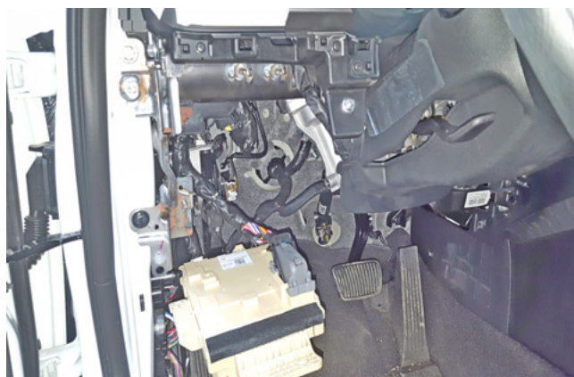
Фото 1.12. Монтажный блок предохранителей снят
