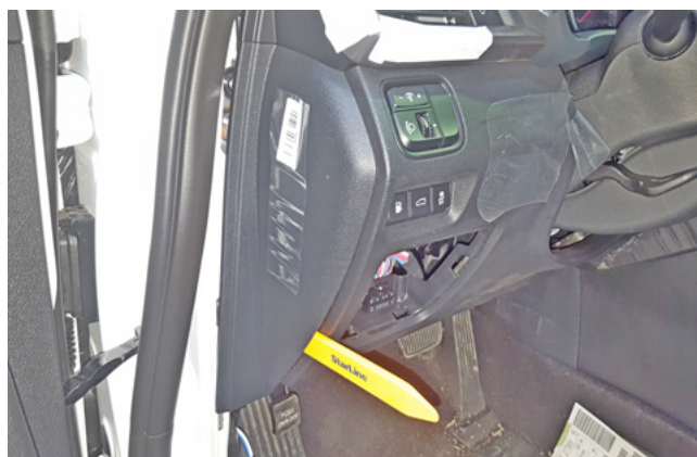
Фото 1.6. Снять боковую накладку передней панели
