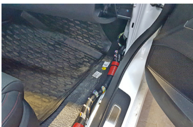
Фото 1.17. Накладка правой кик-панели снята
