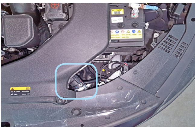
Фото 2.5. Место установки датчика температуры двигателя
