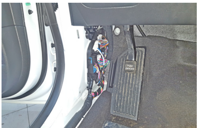
Фото 1.5. Накладка левой кик-панели снята
