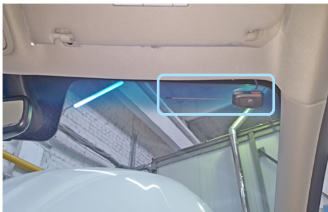
Фото 2.1. Возможное место установки антенного модуля
