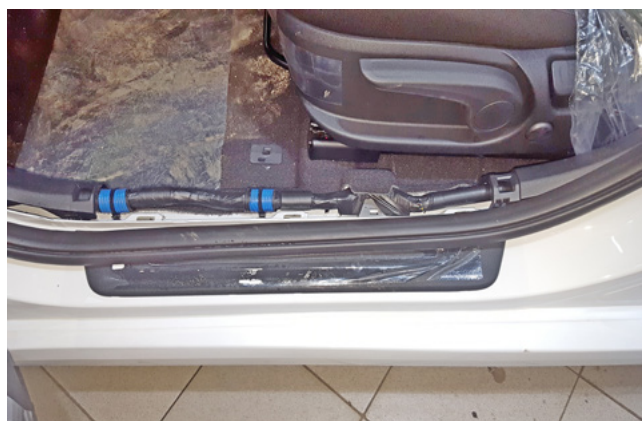
Фото 1.4. Накладка порога двери водителя снята
