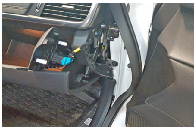
Фото 1.15. Правая боковая накладка передней панели снята
