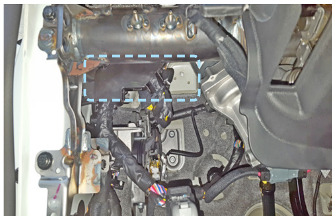
Фото 2.9. Пример расположения центрального блока охранно-телематического комплекса
