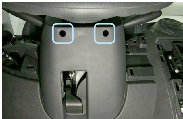
Фото 1.8. Саморезы крепления нижней части кожуха рулевого вала
