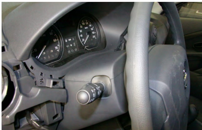
Фото 1.7. Кожух рулевого вала. Общий вид
