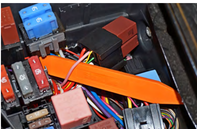
Фото 2.9. Подключение цепи зажигания (розовый)
