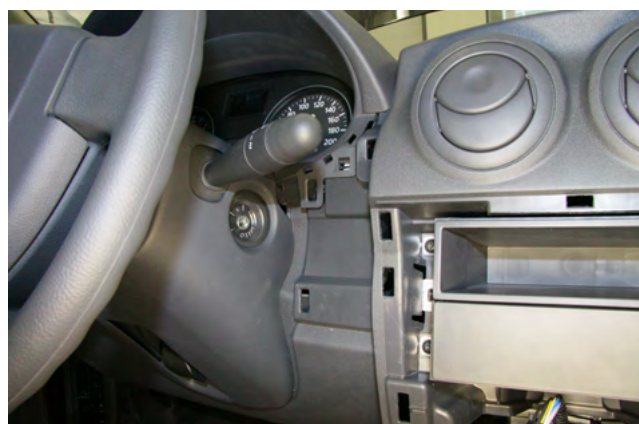
Фото 1.6. Декоративная накладка справа от рулевой колонки снята
