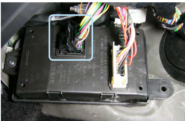
Фото 3.13. Местоположение разъёма блока BCM
