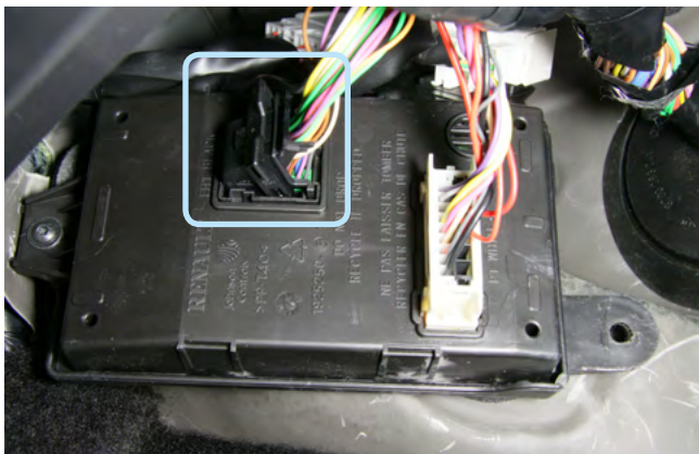
Фото 3.9. Местоположение разъёма блока BCM
