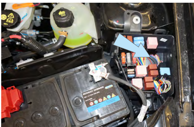
Фото 2.7. Возможное место установки подкапотного блока R6
