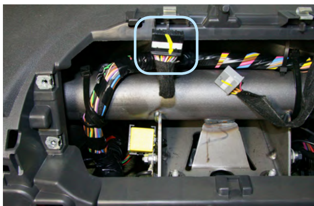
Фото 3.2. Местоположение чёрного разъёма панели приборов
