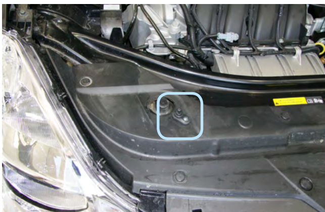
Фото 2.5. Возможное место установки концевика капота
