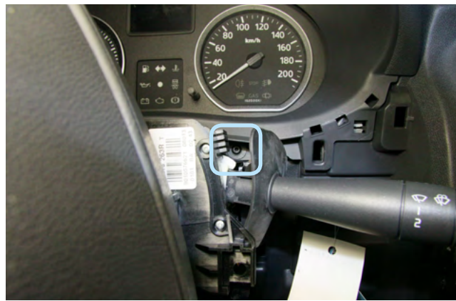
Фото 1.12. Саморез крепления накладки панели приборов
