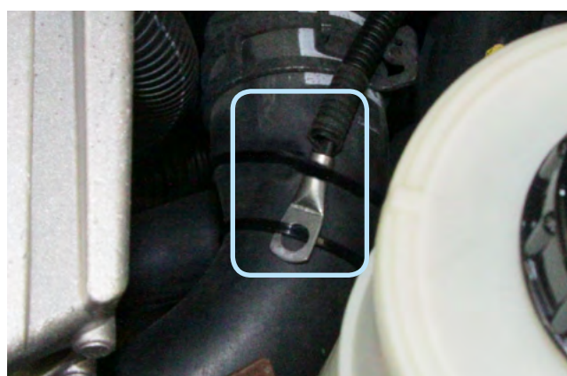
Фото 2.4. Крепление датчика температуры двигателя
