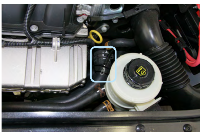
Фото 2.3. Место установки датчика температуры двигателя
