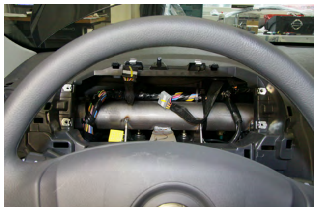
Фото 1.14. Панель приборов снята
