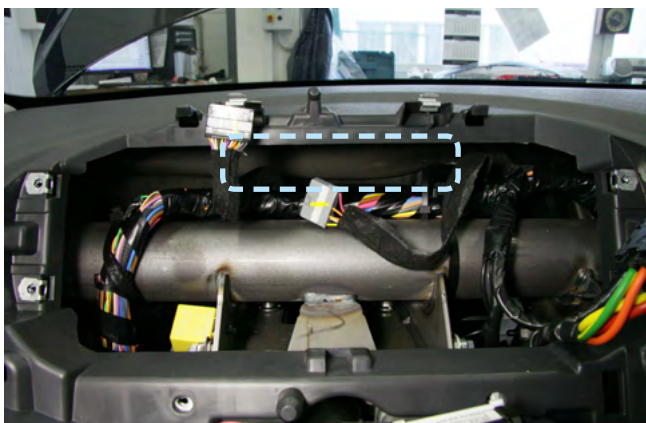
Фото 2.11. Пример расположения центрального блока охранно-телематического комплекса
