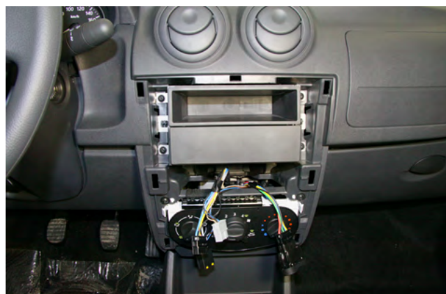
Фото 1.4. Декоративная накладка центральной консоли снята
