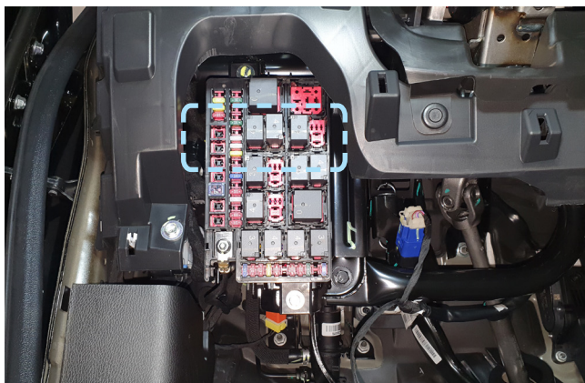
Фото 2.8. Пример расположения центрального блока охранно-телематического комплекса
