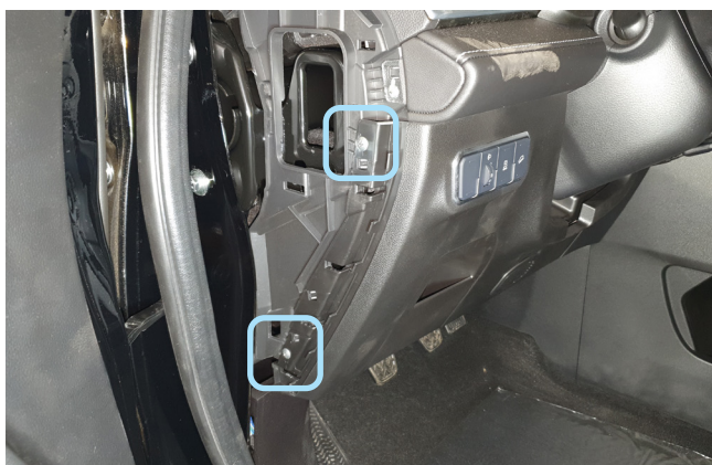
Фото 1.3. Накладка снята. Саморезы
