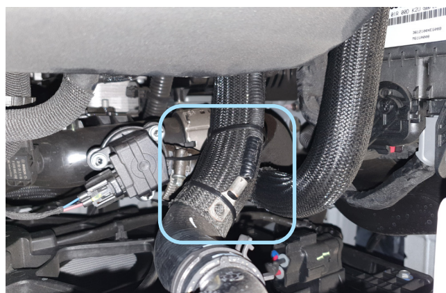
Фото 2.5. Крепление датчика температуры двигателя
