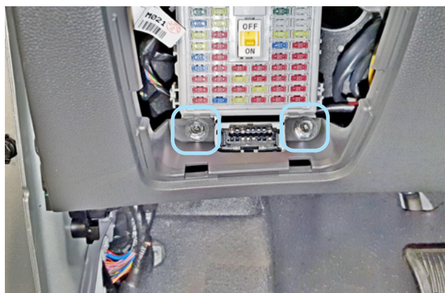
Фото 1.10. Болты крепления накладки под рулевой колонкой
