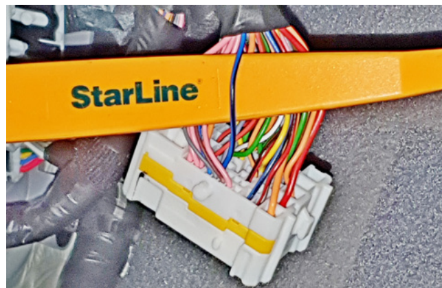
Фото 3.6. Шина данных штатного иммобилайзера (сине-чёрный)
