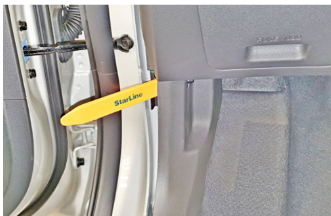
Фото 1.5. Снять накладку левой кик-панели
