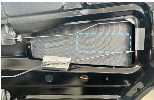
Фото 3.18. Возможное место установки привода
