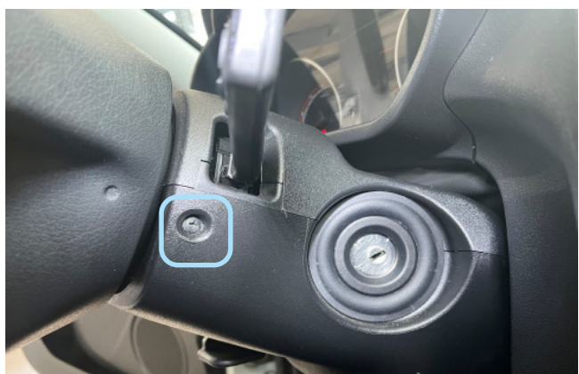
Фото 1.5. Саморез крепления кожуха рулевого вала. Справа
