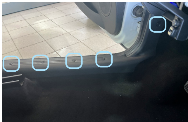
Фото 1.8. Саморезы крепления накладки порога водителя
