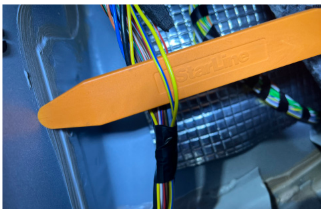
Фото 3.6. Провода управление центрального замка (жёлтый и жёлто-синий)
