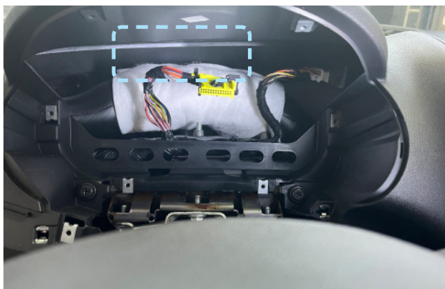
Фото 2.9. Пример расположения центрального блока охранно-телематического комплекса
