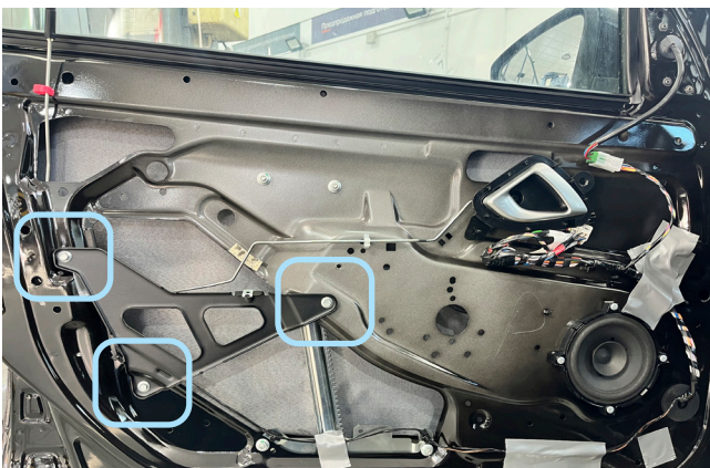
Фото 1.17. Обивка передней двери снята, открутить усилитель двери.
