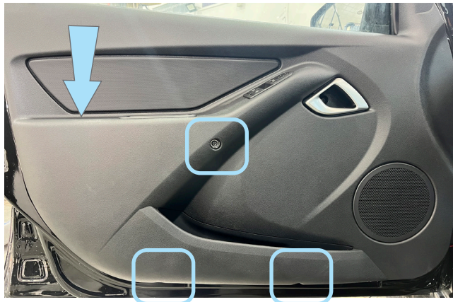
Фото 1.15. Центральная заглушка снята, саморезы крепления.
