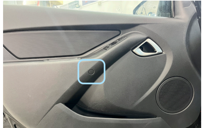
Фото 1.14. Снять центральную заглушку.
