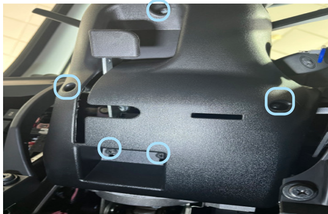
Фото 1.6. Саморезы крепления кожуха рулевого вала. Снизу
