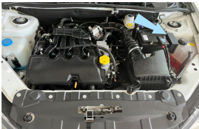
Фото 2.8. Возможное место установки подкапотного блока R6
