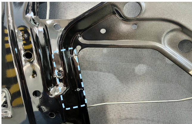
Фото 3.16. Возможное место установки привода
