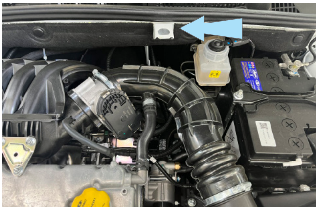
Фото 2.6. Место установки концевика капота
