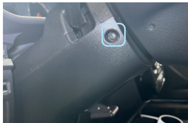
Фото 1.4. Саморез крепления кожуха рулевого вала. Слева
