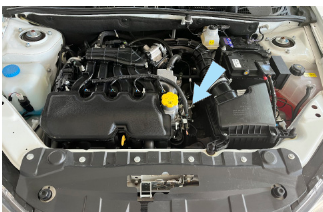
Фото 2.4. Место установки датчика температуры двигателя
