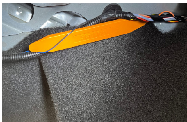
Фото 3.9. Концевик багажника (сине-чёрный)
