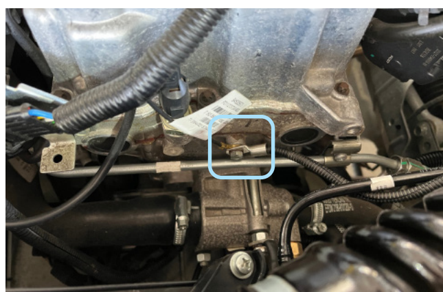
Фото 2.5. Установка датчика температуры двигателя
