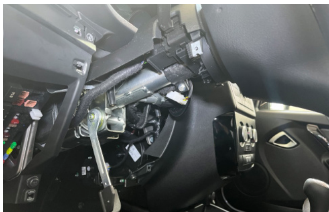
Фото 1.7. Кожух рулевого вала снят
