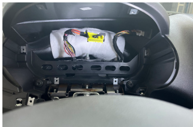
Фото 1.12. Приборная панель снята
