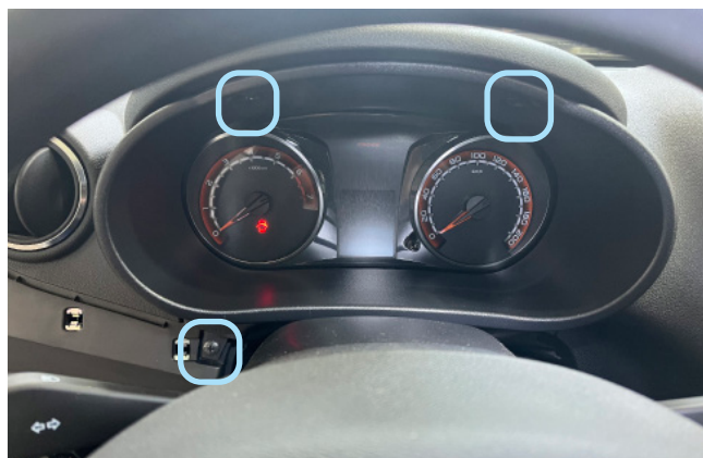
Фото 1.9. Саморезы крепления декоративной накладки
