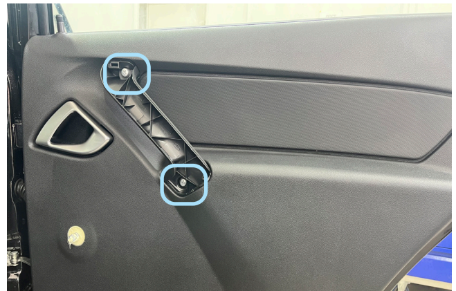
Фото 1.21. Накладка ручки двери и ручка стеклоподъ- ёмника снята, саморезы крепления ручки.
