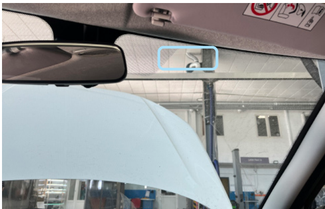
Фото 2.1. Возможное место установки антенного модуля
