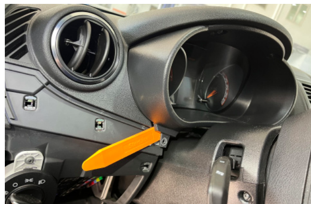
Фото 1.10. Снять декоративную накладку приборной панели
