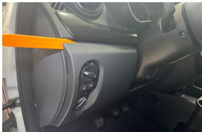
Фото 1.2. Снять пластиковую накладку
