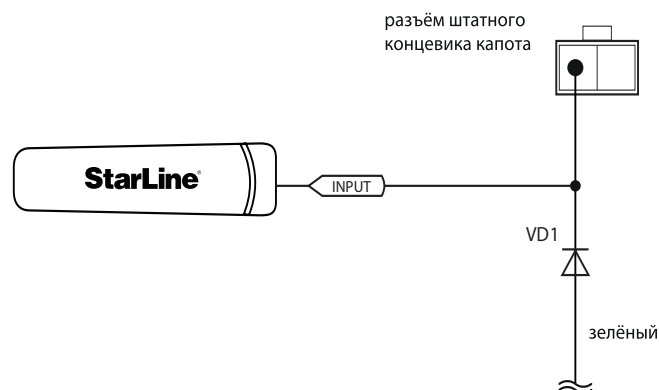
Схема 1. Подключение к концевика капота
