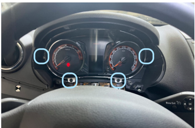
Фото 1.11 Декоративная накладка снята. Саморезы крепления панели приборов
