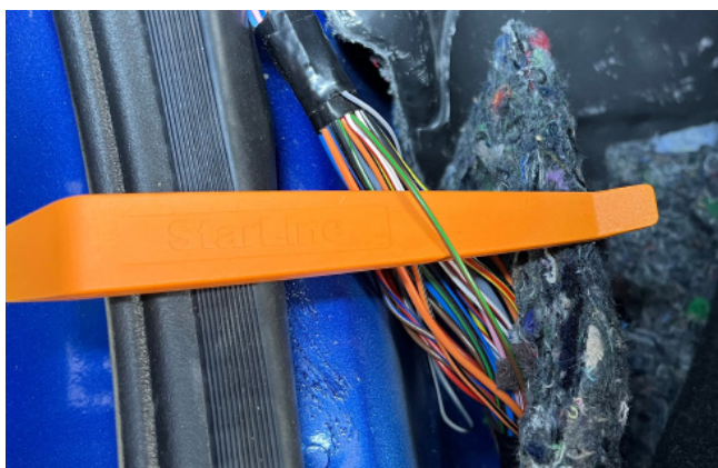
Фото 3.8. Концевик водительской двери (коричнево-зелёный, подключить при отсутствии коричнево-красного провода)
