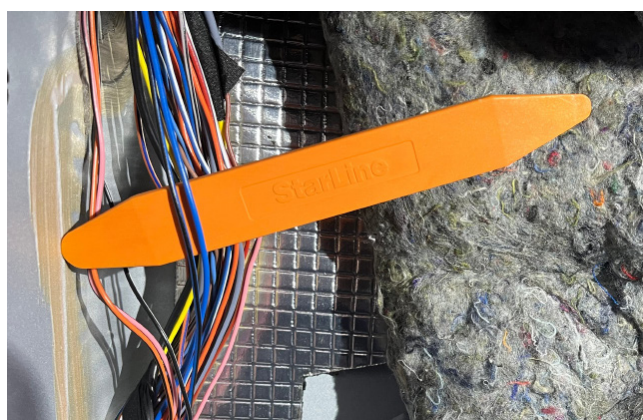
Фото 3.5. Световые сигналы (сине-чёрный и синий)
