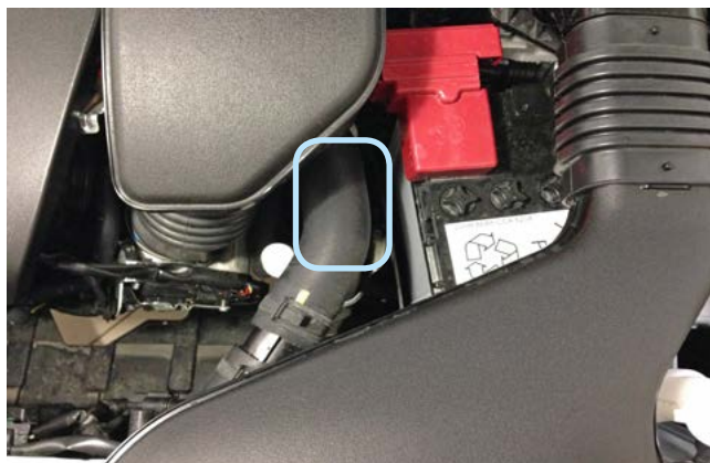
Фото 2.5. Место установки датчика температуры двигателя
