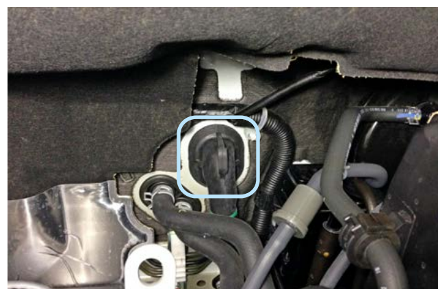
Фото 2.8. Штатный уплотнитель. Вид со стороны капота
