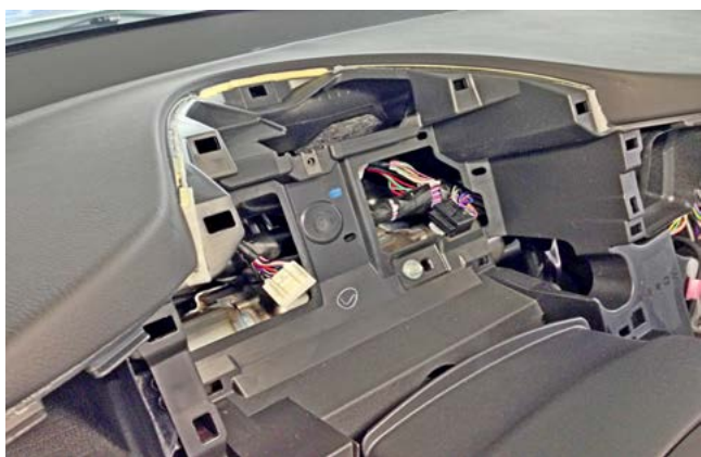
Фото 1.15. Панель приборов снята
