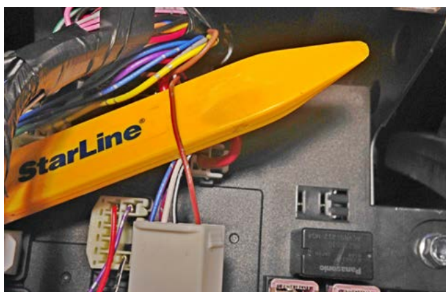
Фото 3.7. Разъём 1, зажигание (коричнево-красный)
