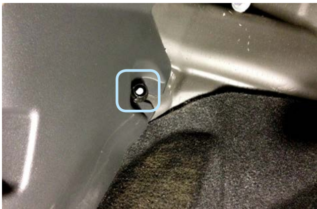
Фото 1.3. Клипса крепления накладки левой кик-панели
