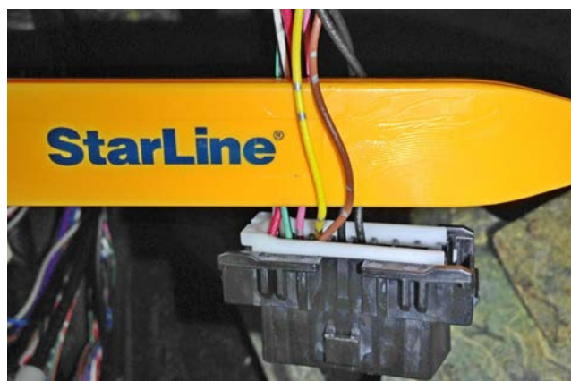
Фото 3.5. Шина CAN-B (коричневый и жёлтый)
