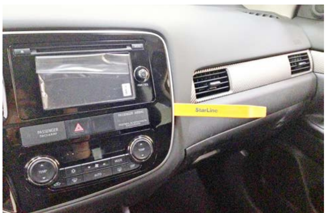
Фото 1.11. Снять декоративную накладку магнитолы
