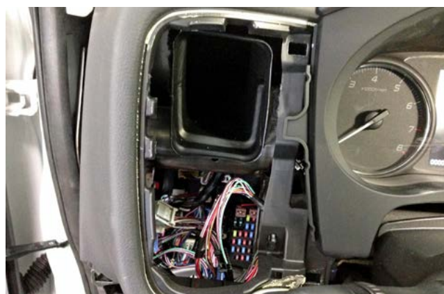
Фото 1.10. Левый воздуховод снят
