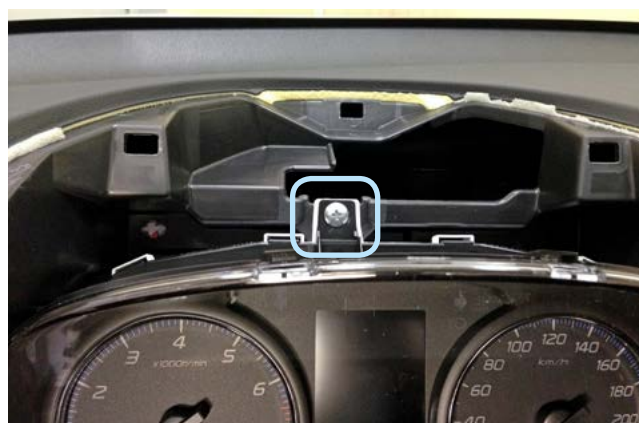
Фото 1.14. Саморез крепления панели приборов
