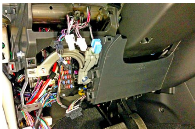
Фото 1.8. Декоративная накладка слева от рулевой колонки снята
