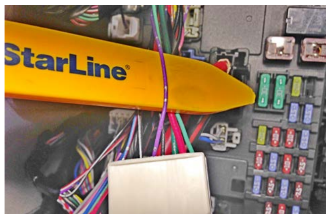
Фото 3.8. Разъём 2, стартер (фиолетовый)
