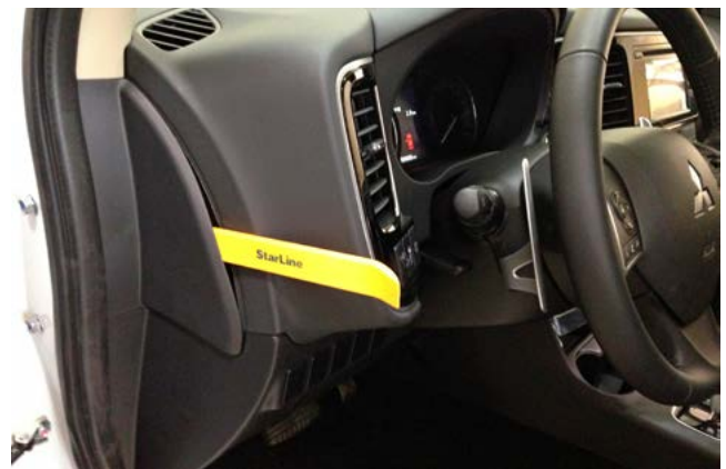
Фото 1.6. Снять левую боковую накладку передней панели
