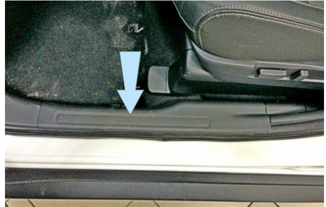
Фото 1.2. Снять накладку порога двери водителя
