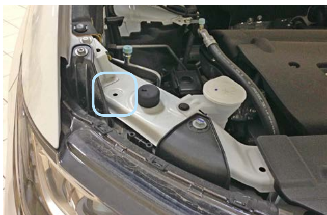
Фото 2.7. Возможное место установки концевика капота
