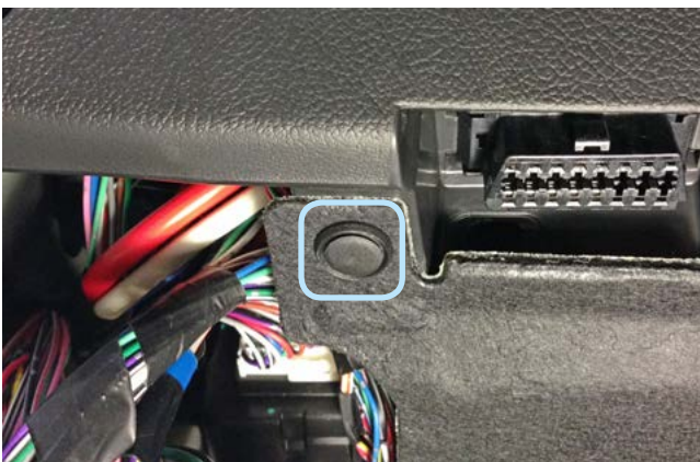
Фото 1.5. Клипса крепления накладки педального узла
