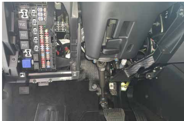
Фото 1.2. Накладка под рулевой колонкой снята
