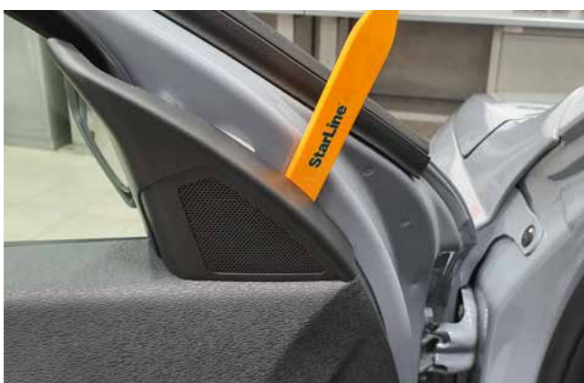
Фото 1.9. Снять пластиковую накладку динамика
