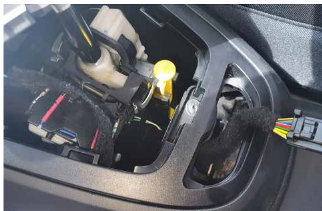
Фото 1.20. Накладка коробки передач снята
