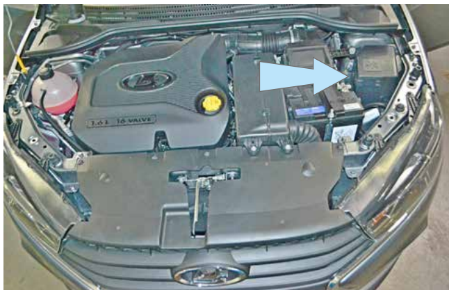
Фото 2.9. Возможное место установки подкапотного блока R6
