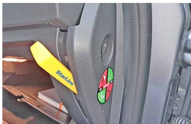
Фото 1.5. Снять правую накладку передней панели
