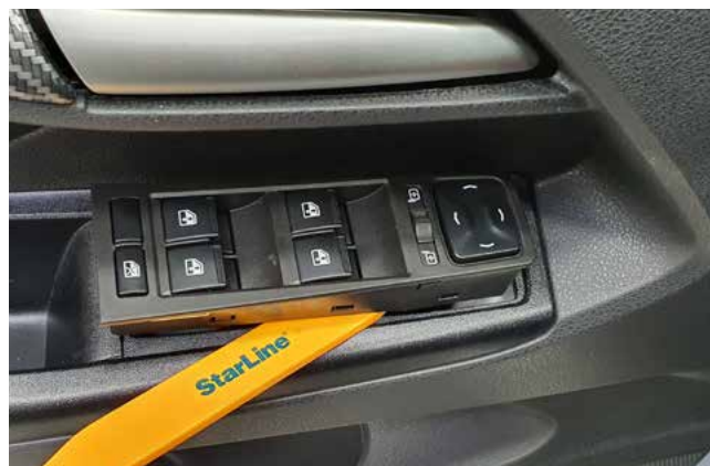
Фото 1.12. Снять блок кнопок двери водителя
