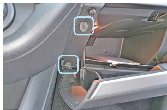
Фото 1.6. Саморезы крепления перчаточного ящика слева
