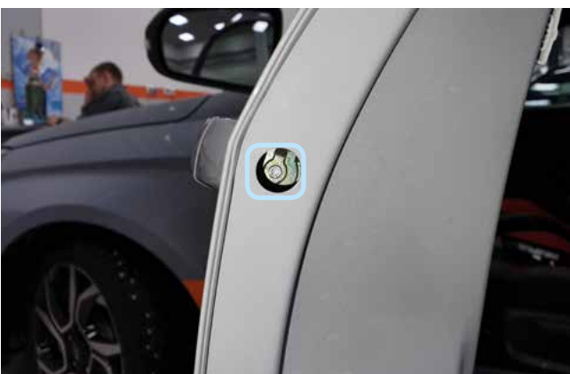
Фото 1.17. Саморез крепления ручки двери водителя
