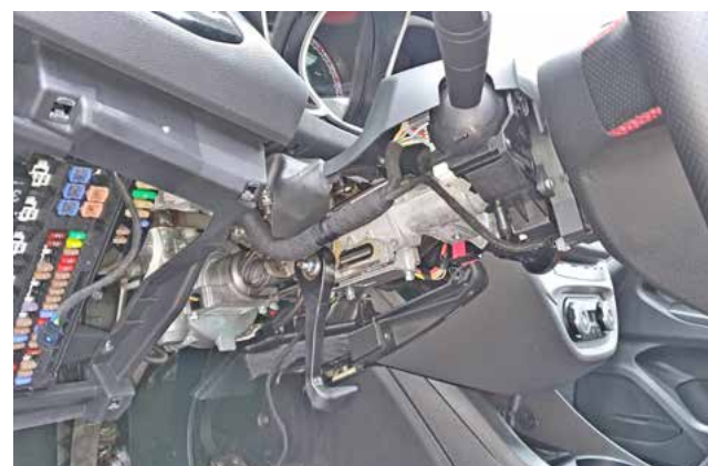
Фото 1.4. Нижняя часть кожуха рулевого вала снята
