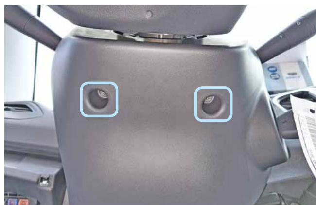
Фото 1.3. Саморезы крепления кожуха рулевого вала
