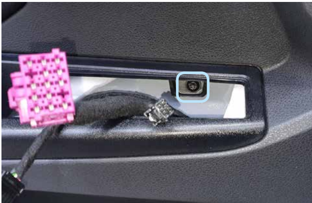
Фото 1.13. Саморез крепления внутренней обшивки двери водителя
