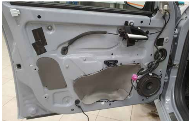
Фото 1.16. Обшивка двери водителя снята
