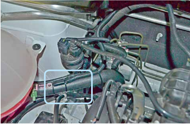
Фото 2.4. Место установки датчика температуры двигателя
