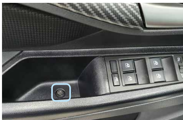
Фото 1.11. Саморез крепления ручки двери водителя
