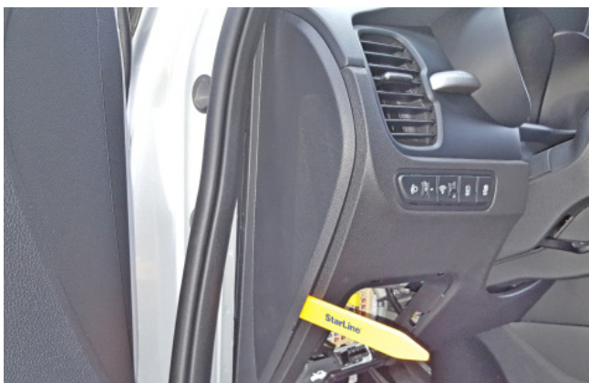
Фото 1.7. Снять левую боковую накладку передней панели
