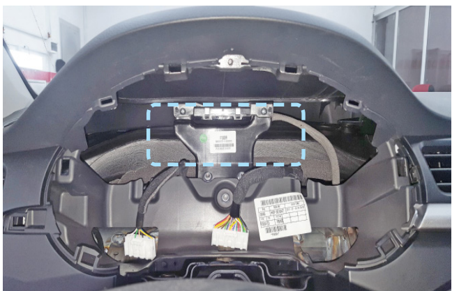
Фото 2.9. Пример расположения центрального блока охранно-телематического комплекса
