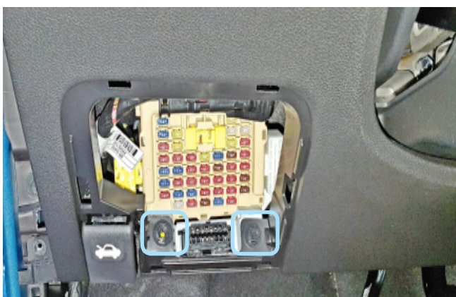
Фото 1.9. Болты крепления пластиковой накладки под рулевой колонкой
