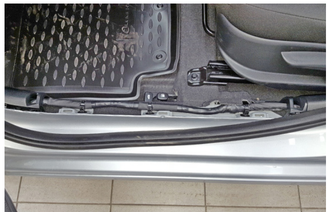
Фото 1.4. Накладка порога двери водителя снята
