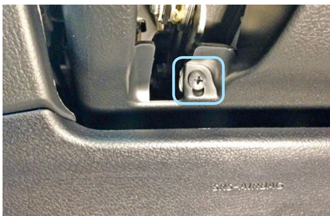
Фото 1.6. Саморез крепления кожуха рулевого вала снизу
