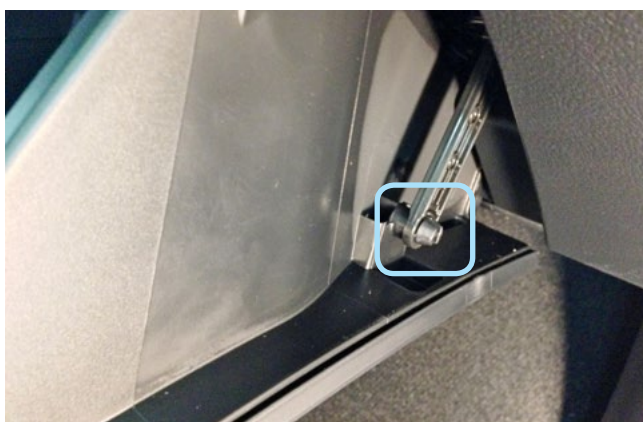
Фото 1.17. Ограничитель открытия перчаточного ящика
