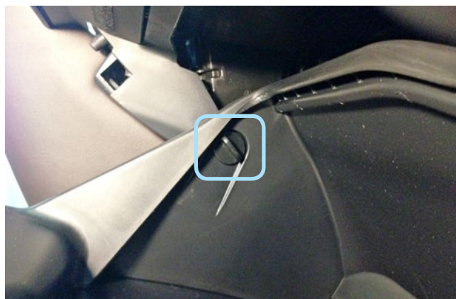
Фото 1.15. Ограничитель открытия перчаточного ящика
