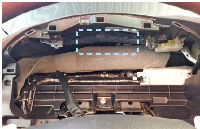
Фото 2.8. Пример расположения центрального блока охранно-телематического комплекса
