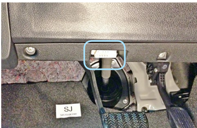
Фото 3.2. Местоположение диагностического разъёма
