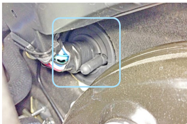
Фото 2.6. Штатный уплотнитель. Вид со стороны капота
