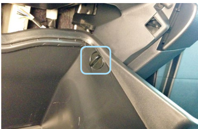
Фото 1.16. Ограничитель открытия перчаточного ящика
