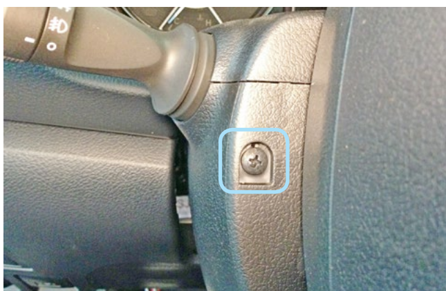
Фото 1.4. Саморез крепления кожуха рулевого вала слева
