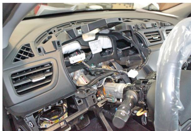
Фото 1.20. Панель приборов снята
