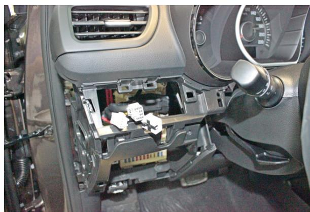
Фото 1.7. Блок кнопок управления снят
