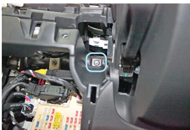
Фото 1.9. Гайка крепления пластиковой накладке под рулевой колонкой
