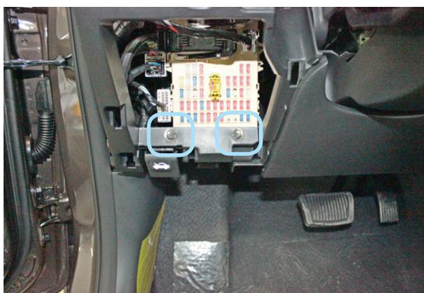
Фото 1.8. Болты крепления пластиковой накладке под рулевой колонкой
