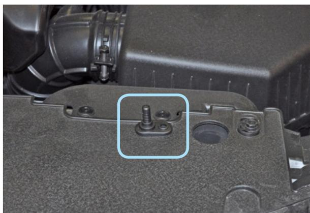
Фото 2.5. Возможное место установки концевика капота
