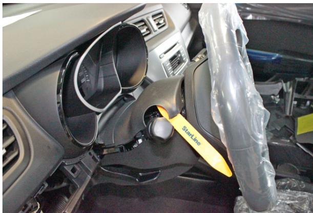
Фото 1.16. Снять верхнюю часть кожуха рулевого вала
