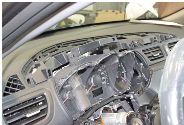
Фото 1.18. Накладка панели приборов снята
