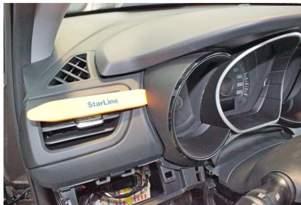
Фото 1.17. Снять декоративную накладку панели приборов
