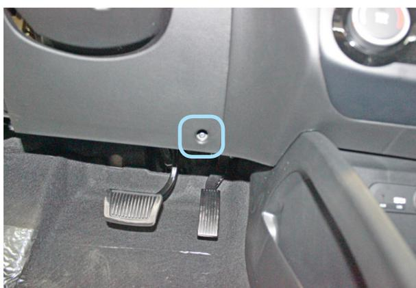
Фото 1.10. Саморез крепления пластиковой накладке под рулевой колонкой
