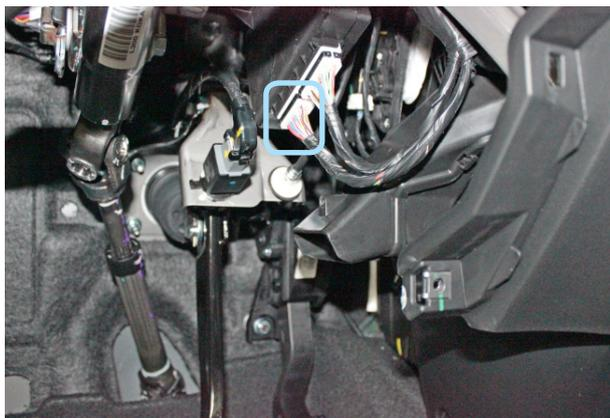
Фото 3.2. Местоположение разъёма на блоке BCM
