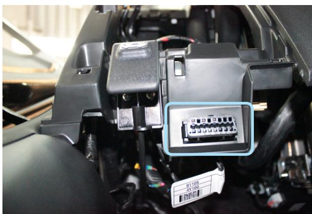
Фото 3.4. Местоположение диагностического разъёма
