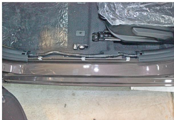
Фото 1.12. Накладка порога двери водителя снята
