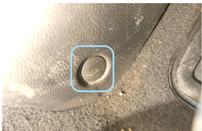
Фото 1.5. Клипса крепления накладки левой кик-панели
