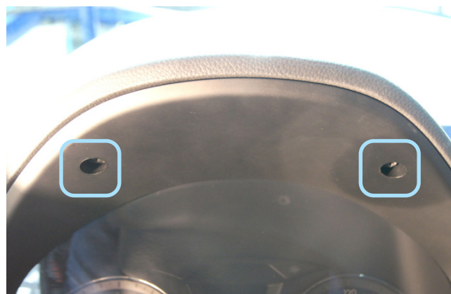
Фото 1.15. Крепление накладки панели приборов
