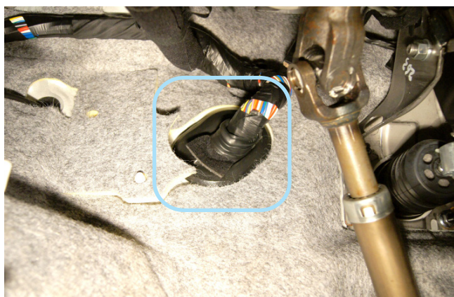
Фото 2.5. Штатный уплотнитель. Вид со стороны салона
