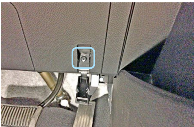
Фото 1.10. Саморез крепления в нижней части пластиковой накладки под рулевой колонкой
