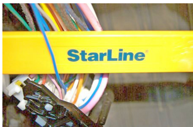
Фото 3.6. Шина данных штатного иммобилайзера (синий)
