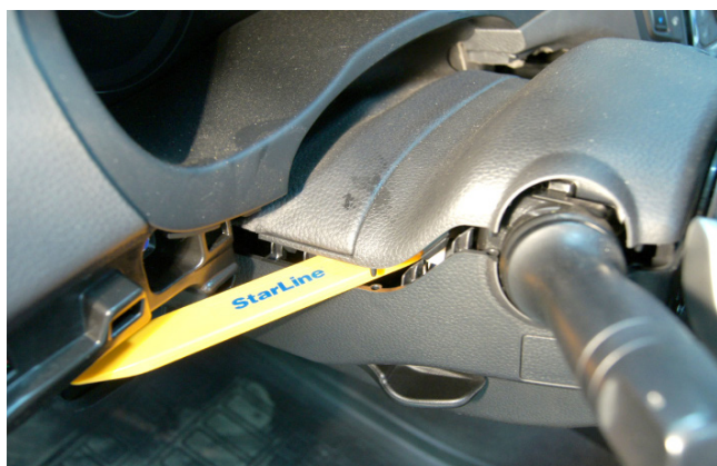
Фото 1.14. Снять верхнюю часть кожуха рулевого вала
