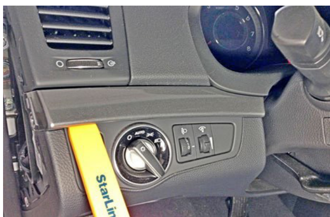
Фото 1.8. Снять декоративную накладку
