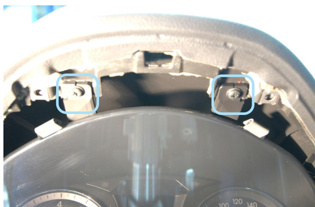
Фото 1.16. Саморезы крепления панели приборов
