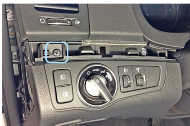
Фото 1.9. Саморез крепления в верхней части пластиковой накладки под рулевой колонкой
