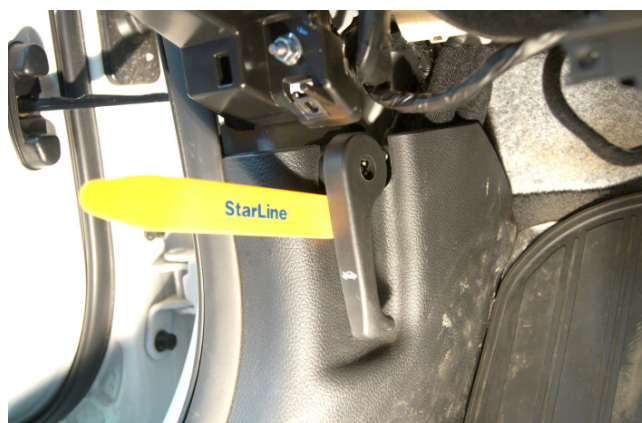
Фото 1.4. Снять ручку отпирания капота
