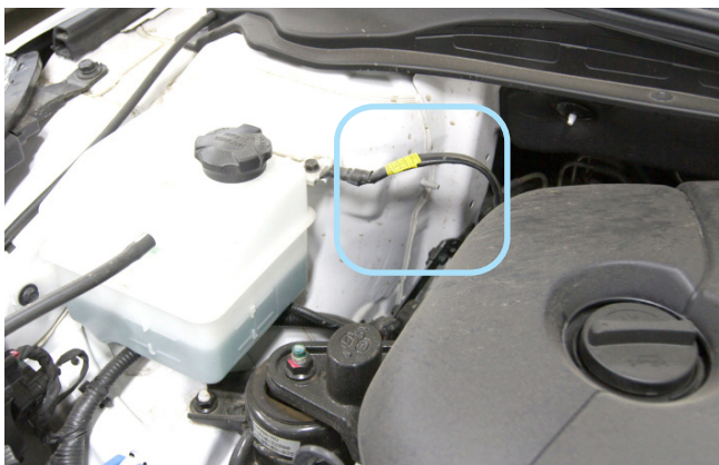
Фото 2.2. Возможное место установки сирены
