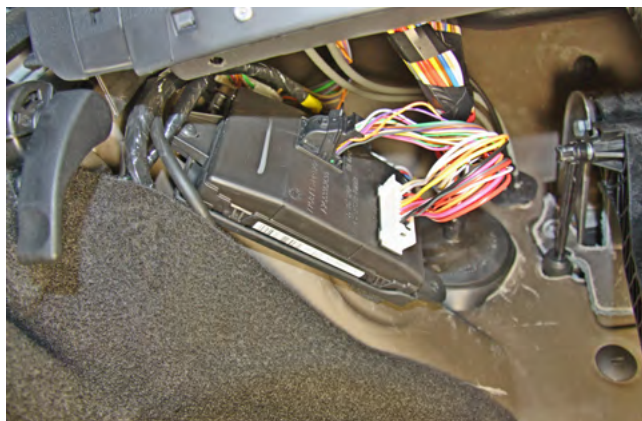
Фото 1.16. Защитная накладка снята
