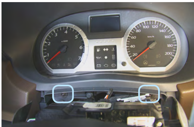
Фото 1.11. Саморезы крепления декоративной накладки панели приборов
