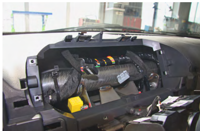
Фото 1.14. Панель приборов снята
