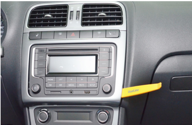
Фото 1.1. Снять декоративную рамку магнитолы
