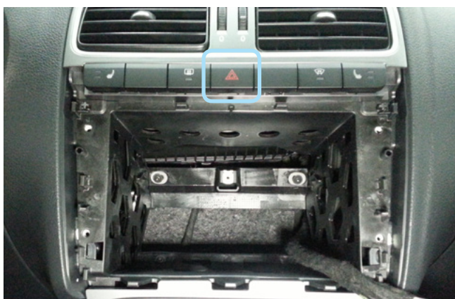
Фото 3.7. Местоположение кнопки аварийной сигнализации
