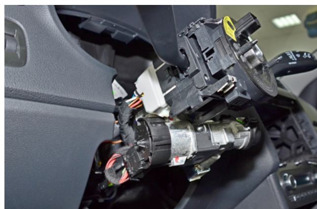
Фото 1.21. Кожух рулевого вала снят
