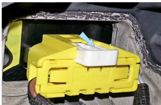
Фото 1.17. Отсоединить разъём подушки безопасности
