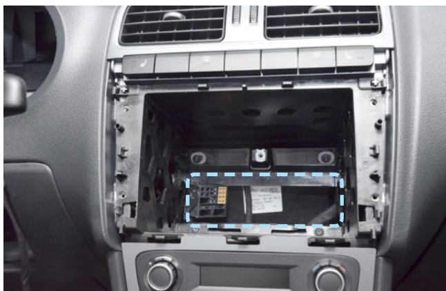
Фото 2.9. Пример расположения центрального блока охранно-телематического комплекса
