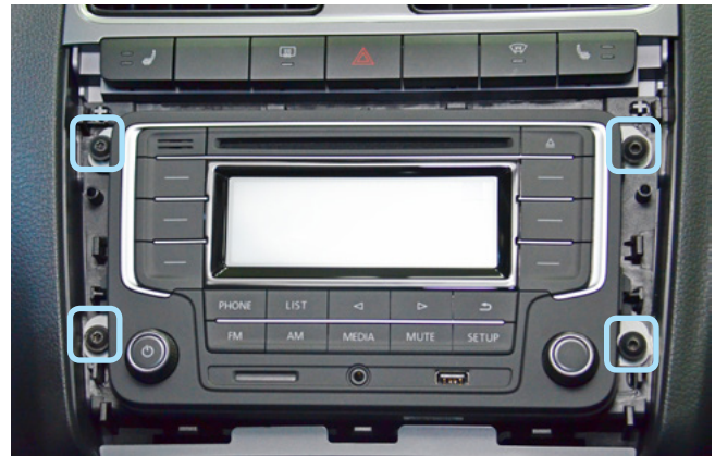
Фото 1.2. Саморезы крепления магнитолы
