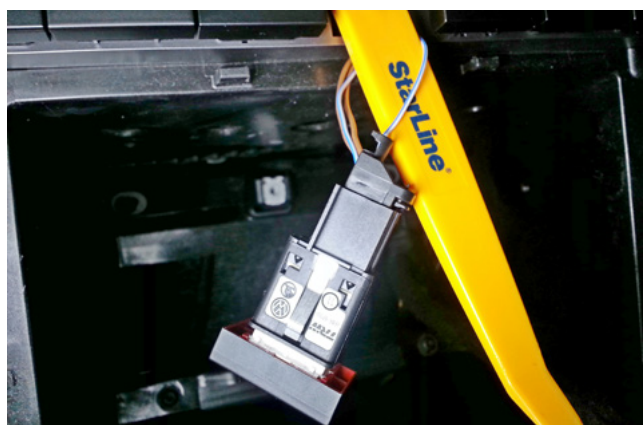
Фото 3.8. Управление световыми сигналами (бело-синий)
