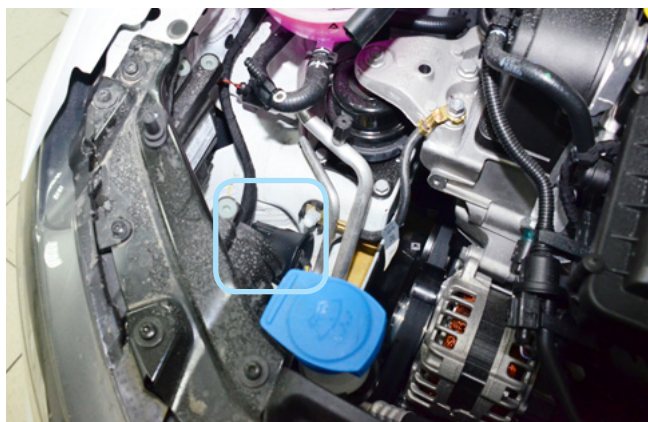
Фото 2.3. Возможное место установки сирены
