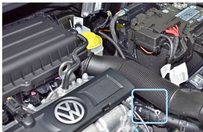
Фото 2.5. Место установки датчика температуры двигателя
