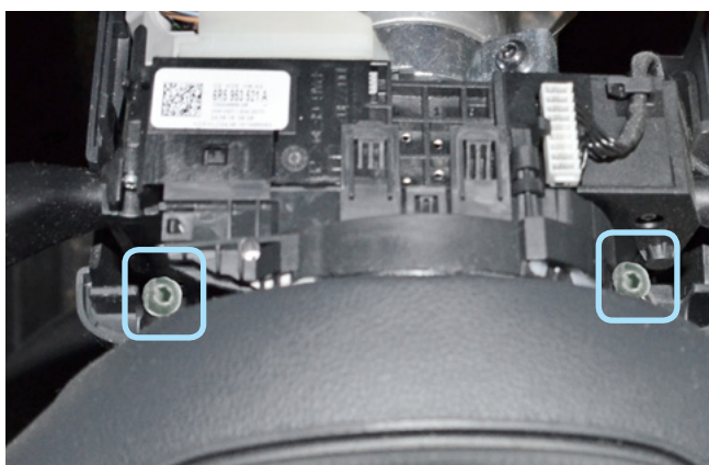
Фото 1.20. Саморезы крепления кожуха рулевого вала
