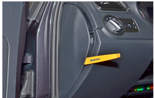
Фото 1.4. Снять левую боковую накладку передней панели
