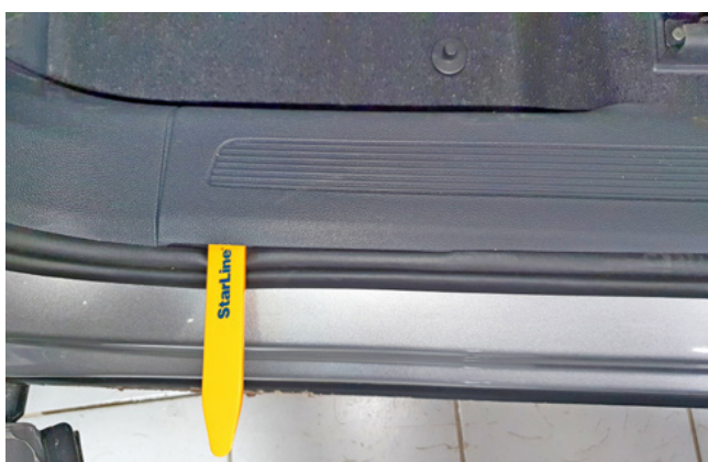
Фото 1.11. Частично снять пластиковую накладку порога двери водителя
