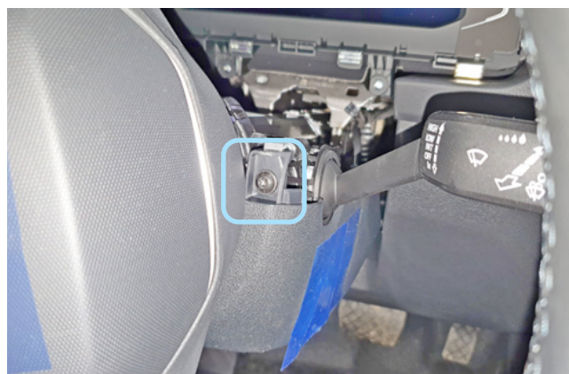
Фото 1.20. Винт крепления нижней части кожуха рулевого вала справа
