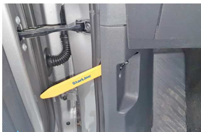
Фото 1.12. Снять пластиковую накладку левой кик-панели
