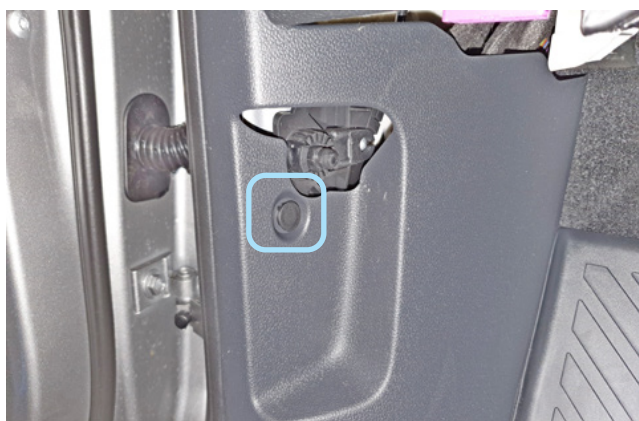
Фото 1.10. Ручка отпирания капота снята. Клипса крепления накладки левой кик-панели
