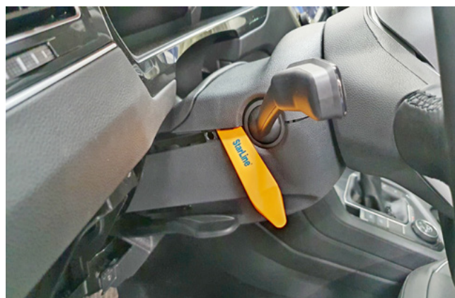
Фото 1.15. Снять верхнюю часть кожуха рулевого вала
