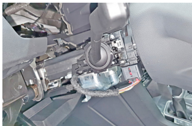
Фото 1.22. Кожух рулевого вала снят
