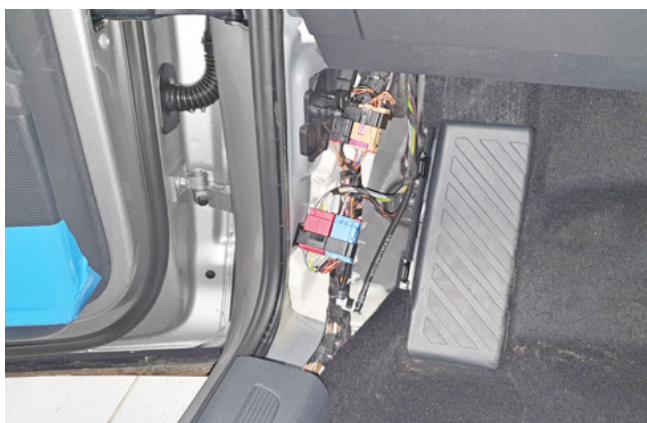
Фото 1.13. Пластиковая накладка левой кик-панели снята
