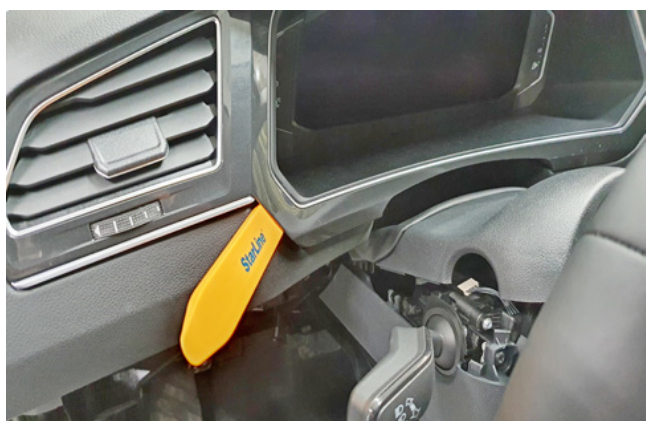
Фото 1.16. Снять декоративную накладку панели приборов
