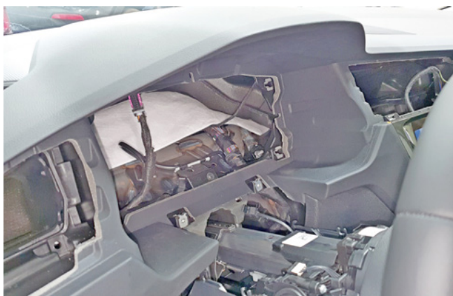
Фото 1.18. Панель приборов снята
