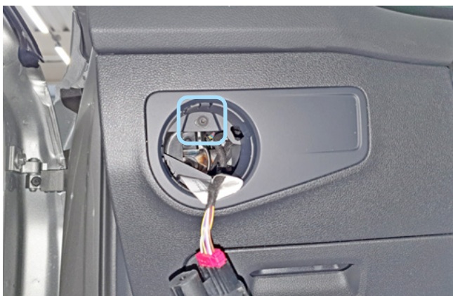
Фото 1.5. Переключатель света снят. Саморез
