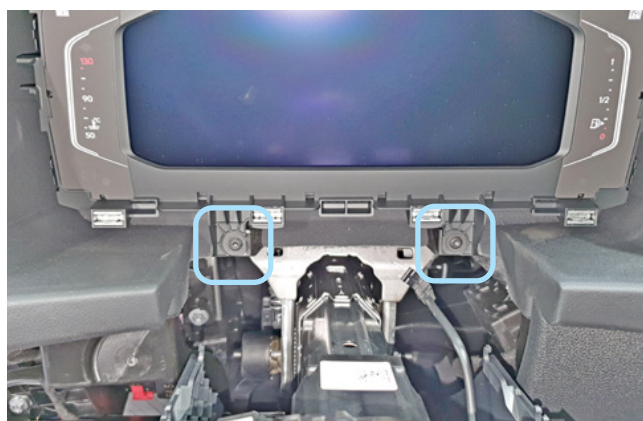
Фото 1.17. Накладка снята. Саморезы крепления панели приборов
