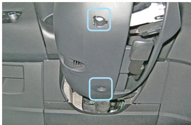
Фото 1.8. Крепление нижней части кожуха
