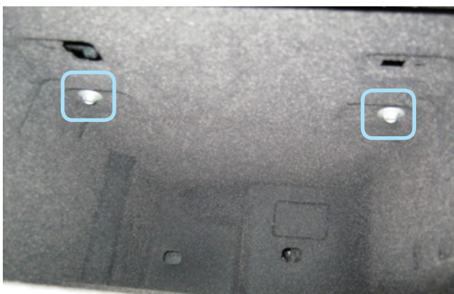
Фото 1.3. Болты крепления перчаточного ящика
