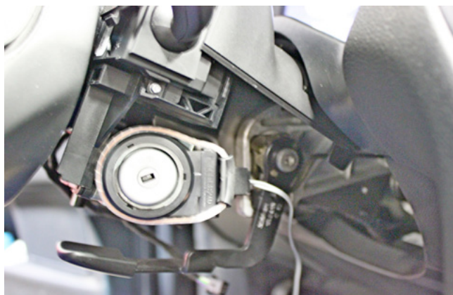
Фото 3.10. Расположение антенны модуля обхода иммобилайзера BP-03
