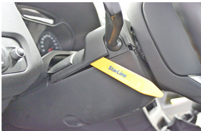
Фото 1.7. Снять верхнюю часть кожуха рулевого вала
