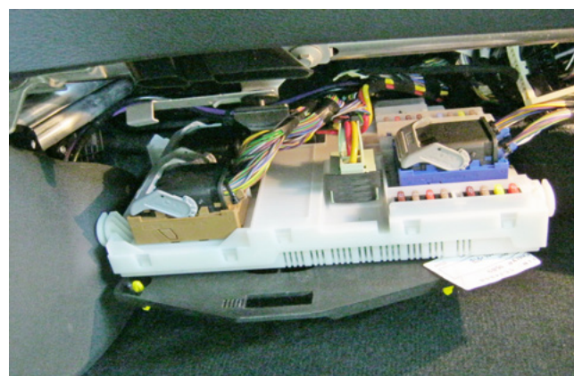
Фото 1.6. Блок ВСМ снят
