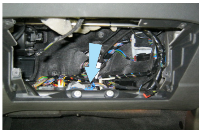
Фото 1.4. Перчаточный ящик снят. Блок ВСМ
