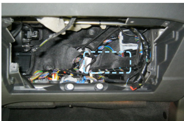
Фото 2.8. Пример расположения центрального блока охранно-телематического комплекса
