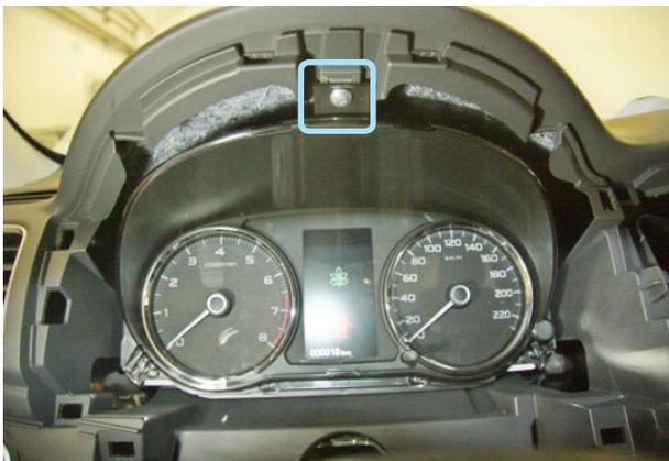
Фото 1.14. Декоративная накладка снята. Саморез
