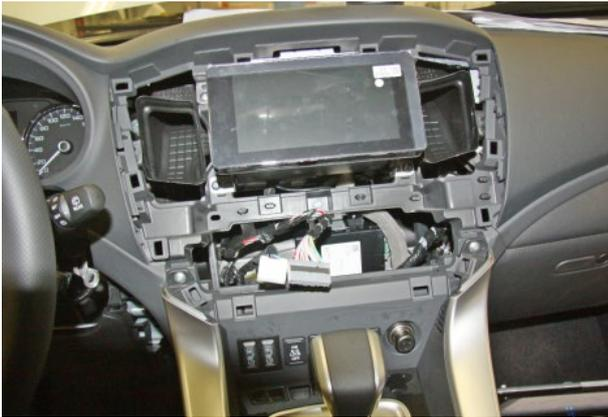
Фото 1.12. Блок управления системой климат-контроля снят
