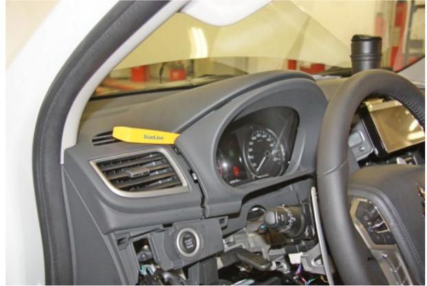
Фото 1.13. Снять декоративную накладку
