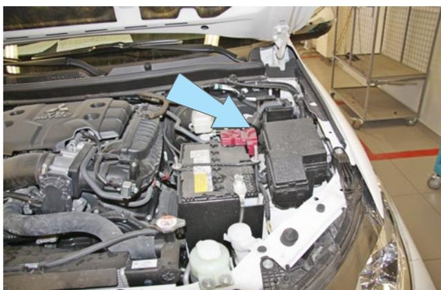
Фото 2.7. Возможное место установки подкапотного блока R6
