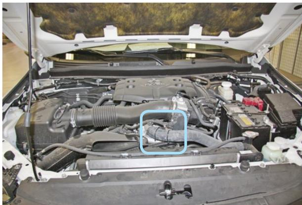
Фото 2.3. Место установки датчика температуры двигателя
