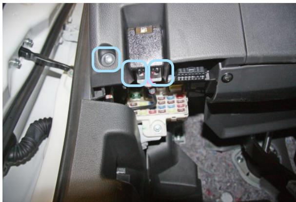
Фото 1.4. Саморезы крепления ручки отпирания лючка и пластиковой наклейки
