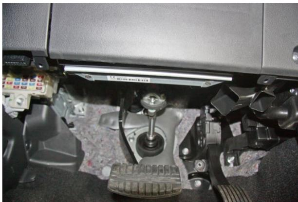
Фото 1.3. Защитная накладка снята
