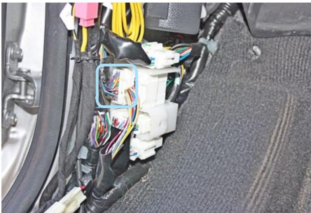
Фото 3.6. Местоположение разъёма
