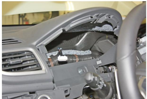
Фото 1.15. Панель приборов снята
