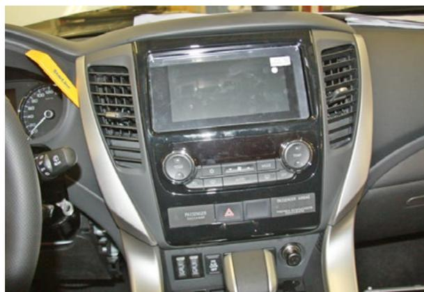
Фото 1.11. Снять блок управления системой климат-контроля
