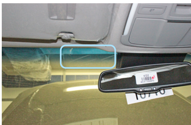
Фото 2.1. Возможное место установки антенного модуля
