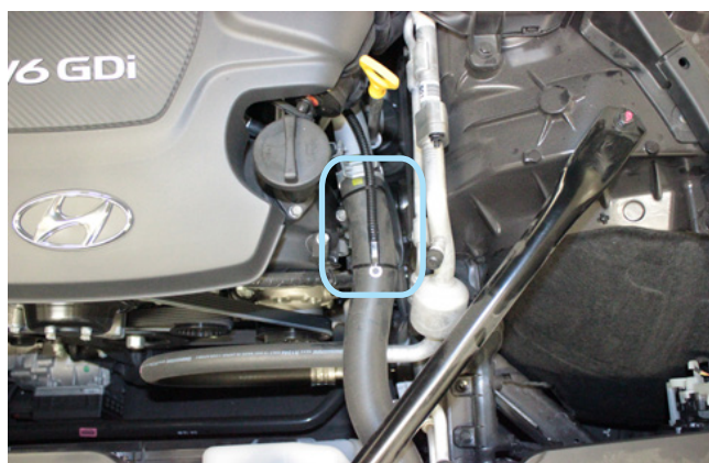
Фото 2.4. Место установки датчика температуры двигателя
