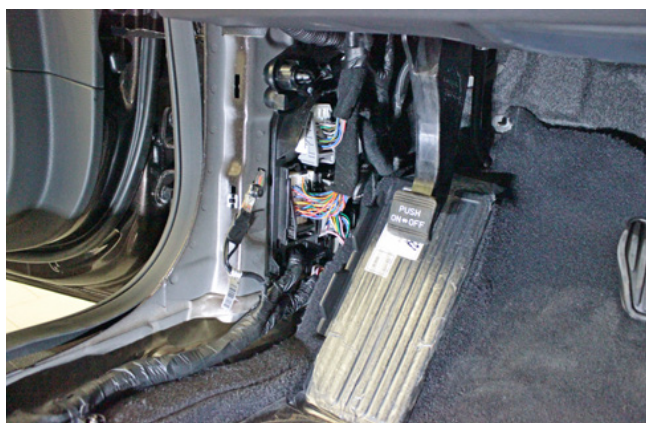
Фото 1.7. Накладка левой кик-панели снята
