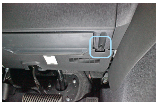
Фото 1.4. Саморез крепления накладки
