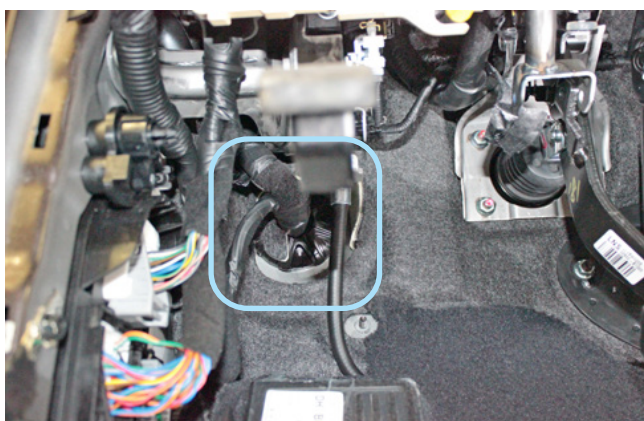
Фото 2.6. Штатный уплотнитель. Вид со стороны салона
