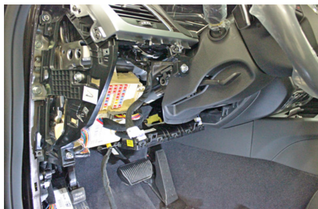
Фото 1.8. Накладка под рулевой колонкой снята
