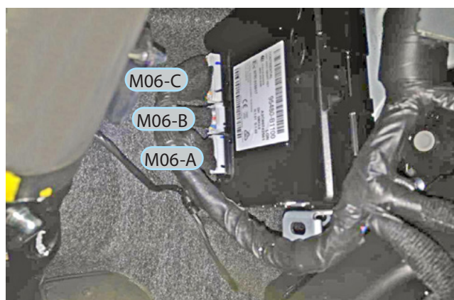
Фото 3.3. Заводская нумерация разъемов
