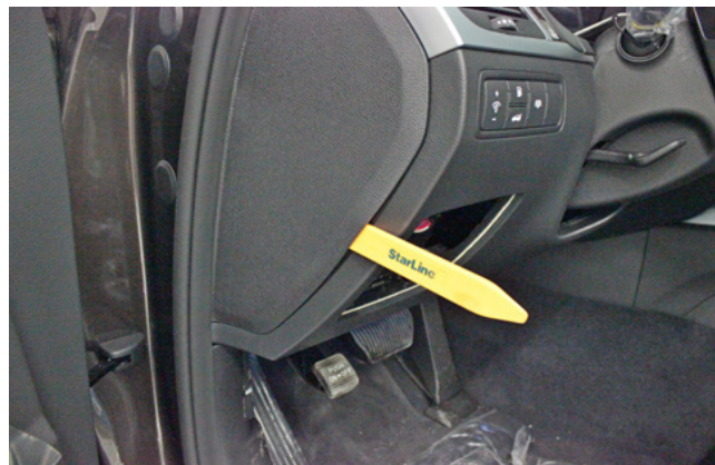
Фото 1.2. Снять боковую накладку передней панели
