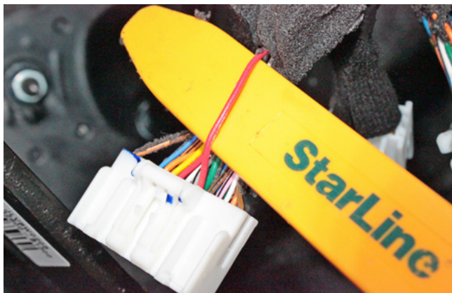
Фото 3.6. Шина данных штатного иммобилайзера (красный)
