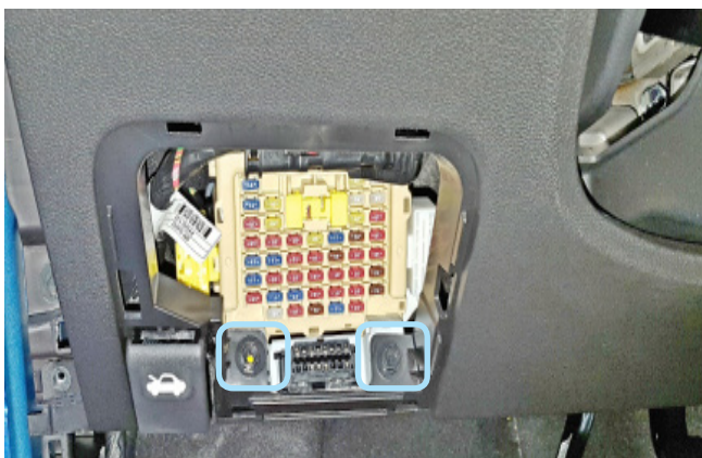
Фото 1.9. Болты крепления пластиковой накладки под рулевой колонкой
