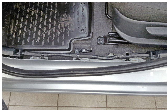
Фото 1.4. Накладка порога двери водителя снята
