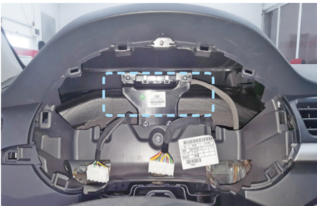
Фото 2.9. Пример расположения центрального блока охранно-телематического комплекса
