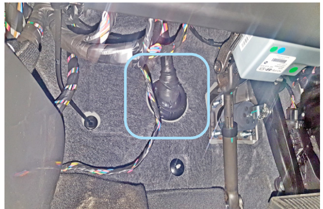
Фото 2.8. Штатный уплотнитель. Вид со стороны салона
