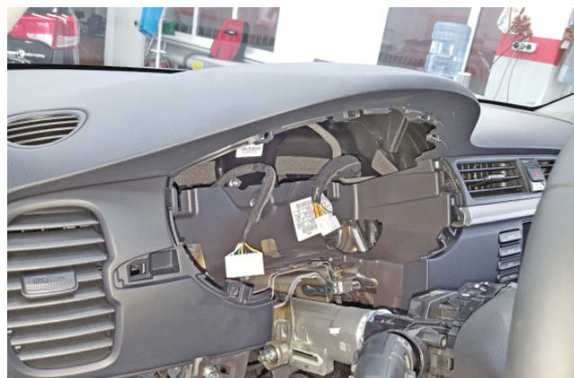
Фото 1.20. Панель приборов снята
