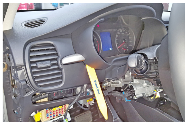
Фото 1.18. Снять накладку панели приборов
