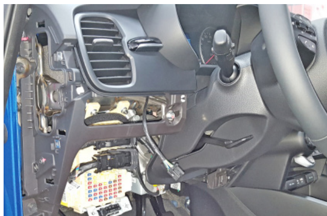
Фото 1.10. Пластиковая накладка под рулевой колонкой снята
