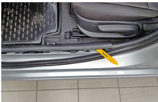
Фото 1.3. Снять накладку порога двери водителя
