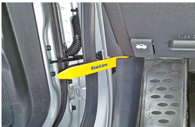
Фото 1.5. Снять накладку левой кик-панели
