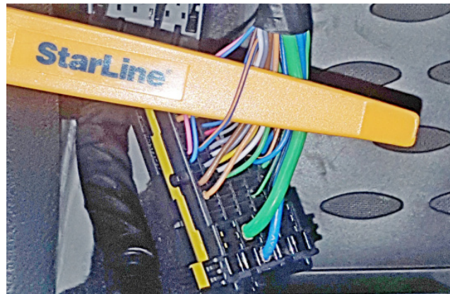
Фото 3.6. Шина данных штатного иммобилайзера (сине-оранжевый)
