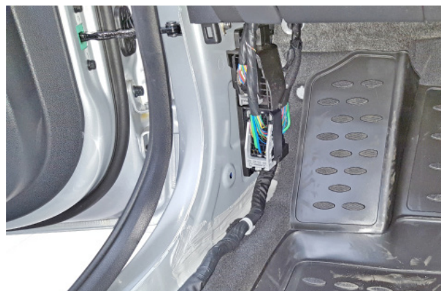
Фото 1.6. Накладка левой кик-панели снята
