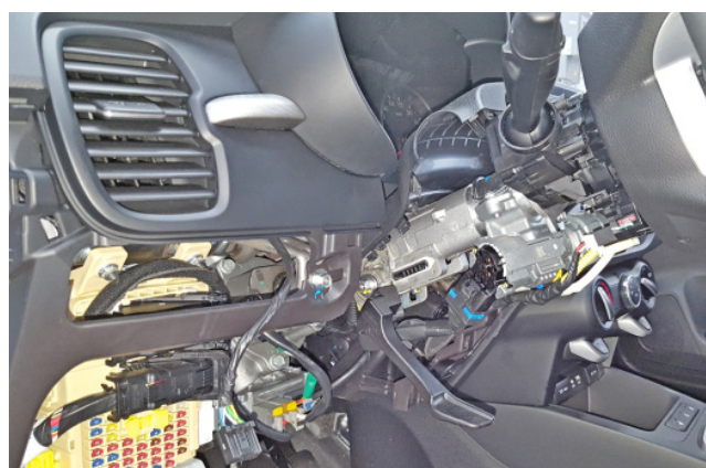
Фото 1.16. Кожух рулевого вала снят
