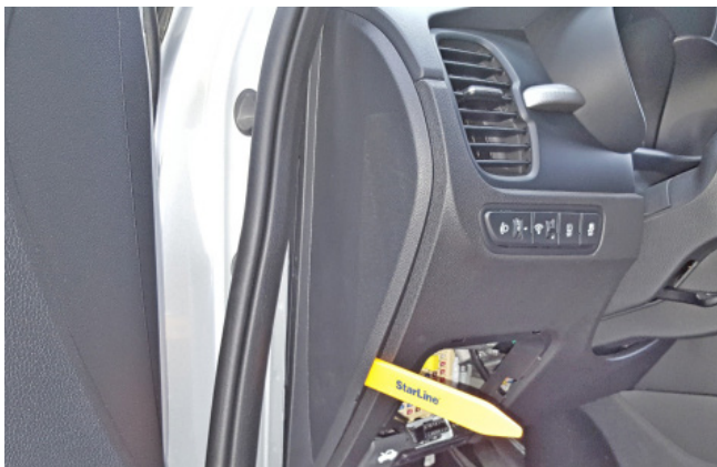
Фото 1.7. Снять левую боковую накладку передней панели
