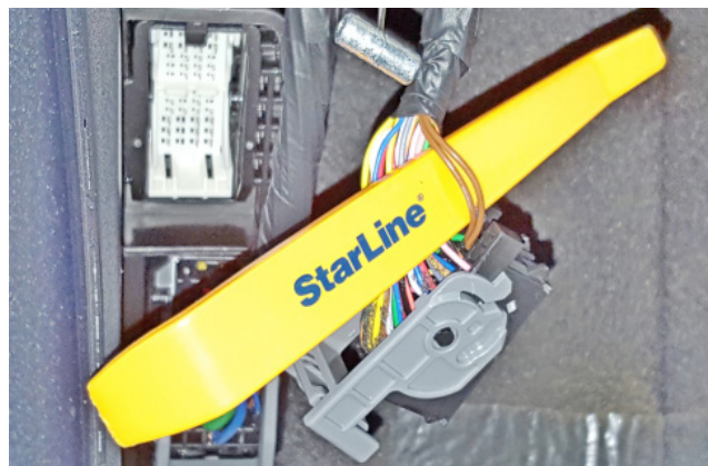
Фото 3.8. Концевик двери водителя (коричневый)
