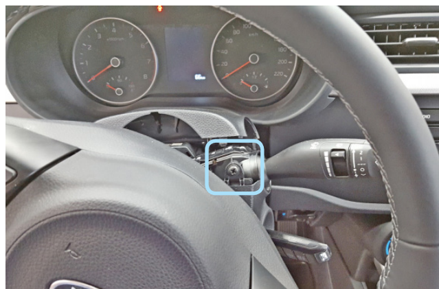
Фото 1.14. Саморез крепления нижней части кожану рулевого вала справа
