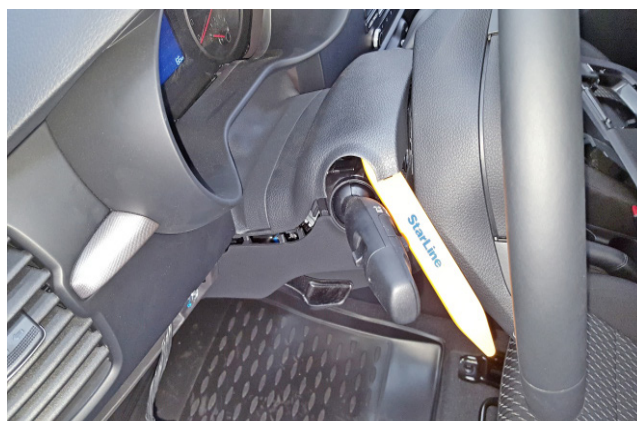
Фото 1.12. Снять верхнюю часть кожуха рулевого вала
