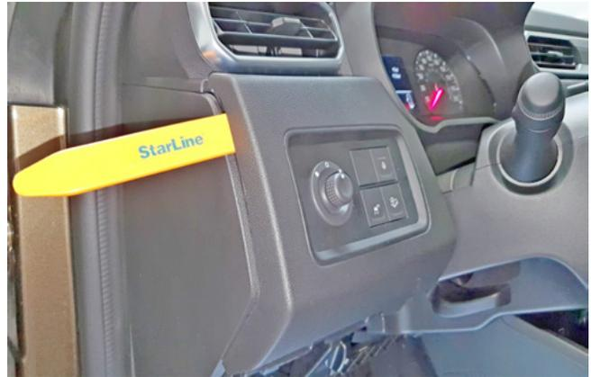
Фото 1.7. Снять пластиковую накладку слева от рулевой колонки
