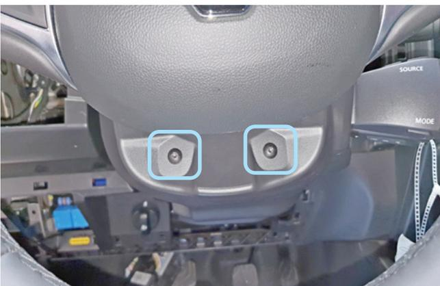
Фото 1.16. Саморезы крепления нижней части кожуха рулевого вала
