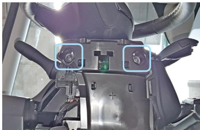
Фото 1.19. Саморезы крепления накладки под рулевым валом
