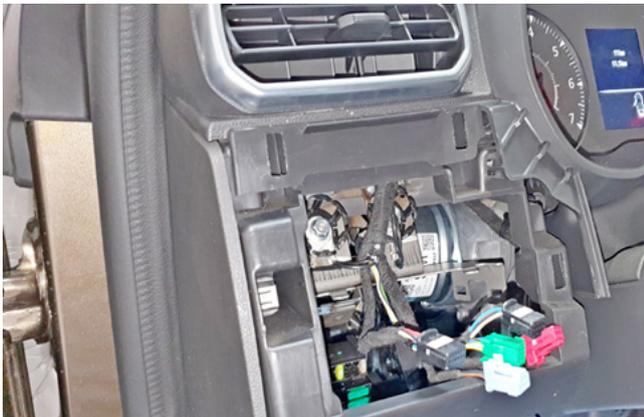
Фото 1.8. Накладка слева от рулевой колонки снята
