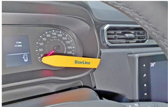
Фото 1.9. Снять пластиковую накладку справа от рулевой колонки
