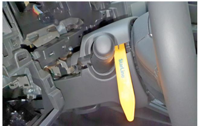
Фото 1.15. Снять верхнюю часть кожуха рулевого вала
