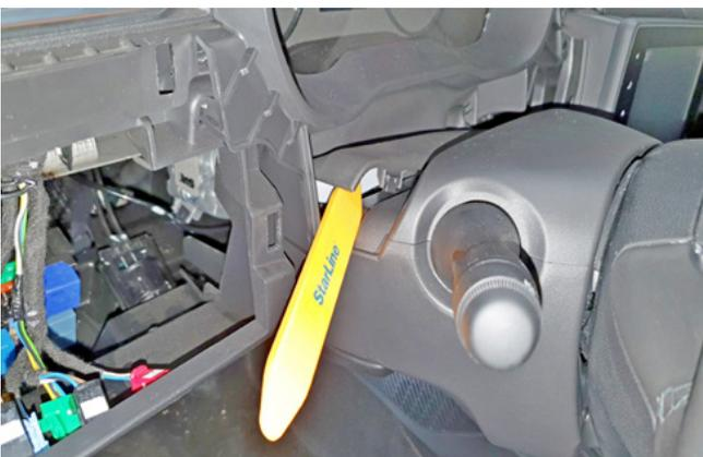
Фото 1.10. Снять пылезащитный кожух рулевой колонки
