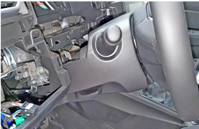
Фото 1.14. Кожух рулевого вала. Общий вид
