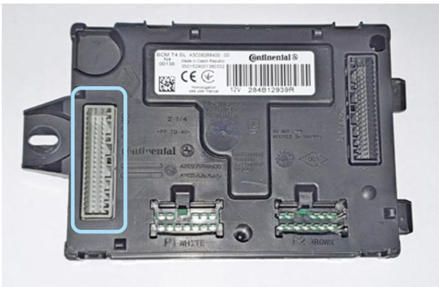
Фото 3.8. Местоположение разъёма на блоке BSI
