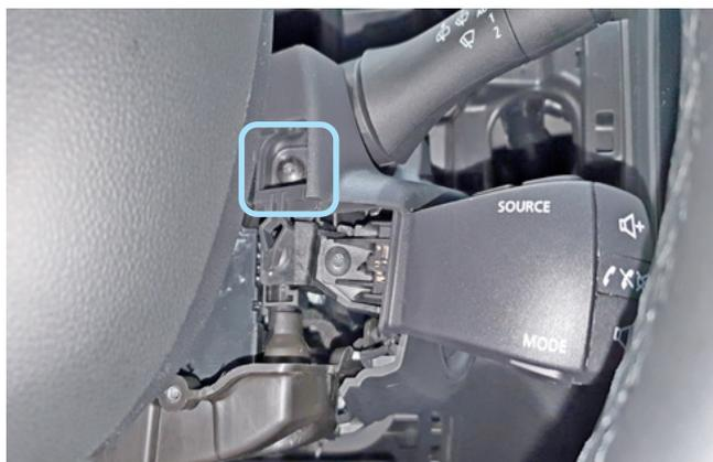
Фото 1.18. Саморез крепления накладки на замке зажигания
