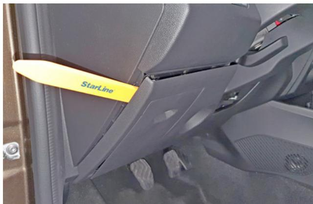
Фото 1.2. Снять пластиковую накладку под рулевой колонкой
