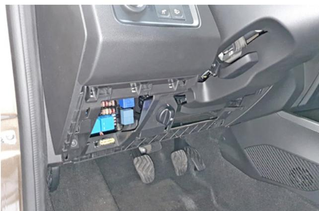
Фото 1.3. Пластиковая накладка под рулевой колонкой снята
