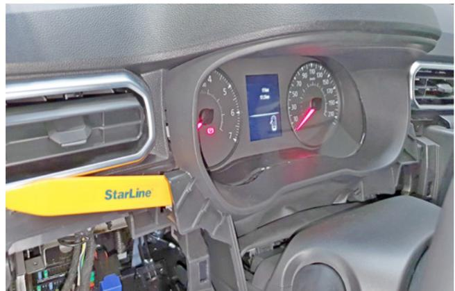
Фото 1.11. Снять накладку панели приборов
