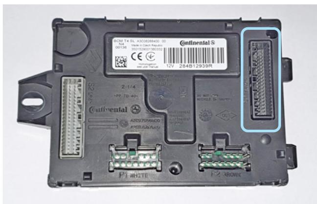
Фото 3.2. Местоположение разъёма на блоке BSI
