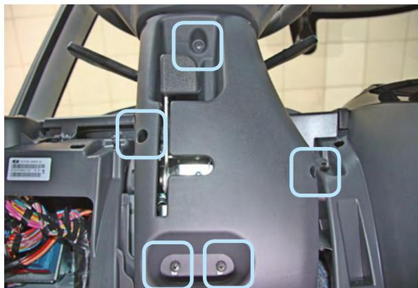
Фото 1.4. Саморезы и винты крепления кожуха рулевого вала
