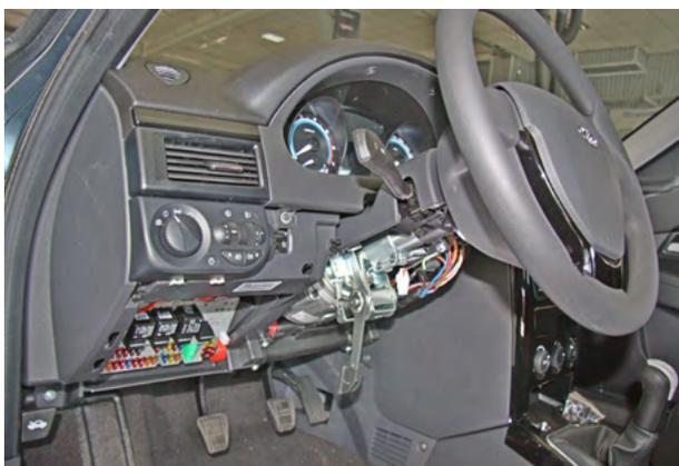
Фото 1.5. Нижняя часть кожуха рулевого вала снята
