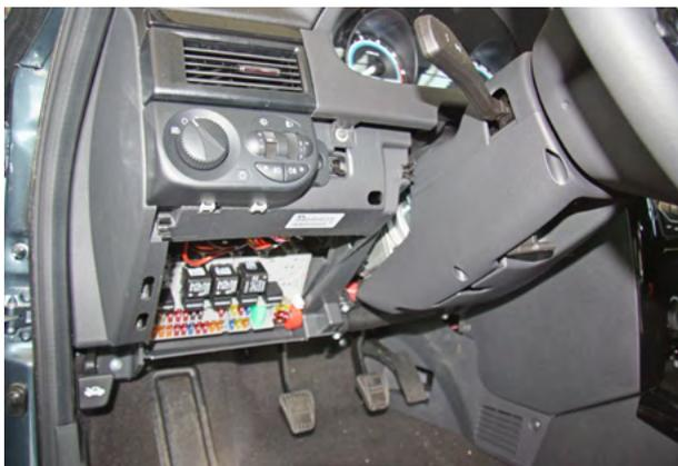
Фото 1.3. Пластиковая накладка снята
