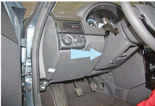
Фото 1.1. Кожух рулевого вала. Общий вид
