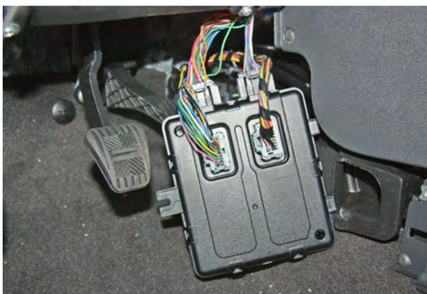
Фото 1.10. Блок ВСМ снят
