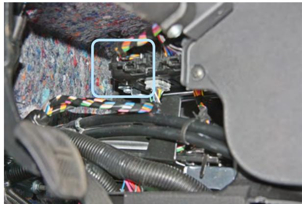
Фото 1.9. Болт и гайка крепления блока ВСМ
