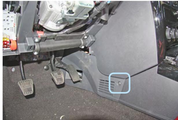
Фото 1.7. Саморез крепления боковой накладки
