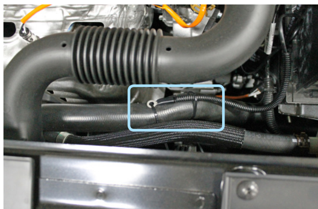
Фото 2.4. Крепление датчика температуры двигателя
