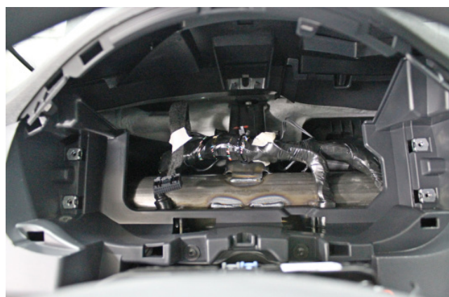
Фото 1.9. Панель приборов снята
