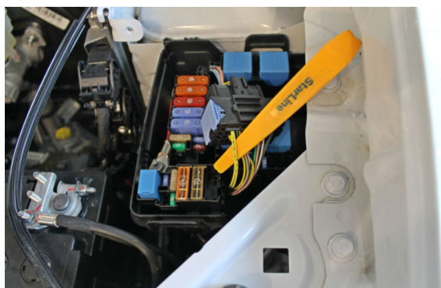
Фото 2.9. Подключение цепи зажигания (жёлтый)
