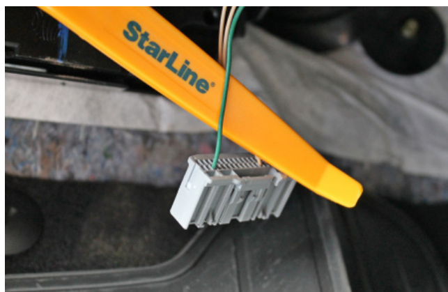
Фото 3.5. Управление реле стартера (зелёный)
