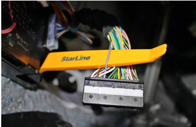
Фото 3.10. Управление подогревом заднего стекла и боковых зеркал (серый)
