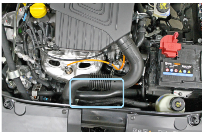
Фото 2.3. Место установки датчика температуры двигателя
