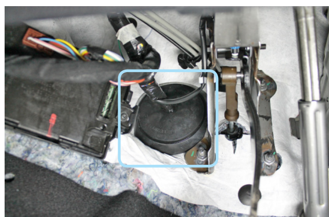
Фото 2.6. Штатный уплотнитель. Вид со стороны салона
