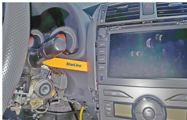
Фото 1.18. Снять верхнюю накладку центральной консоли
