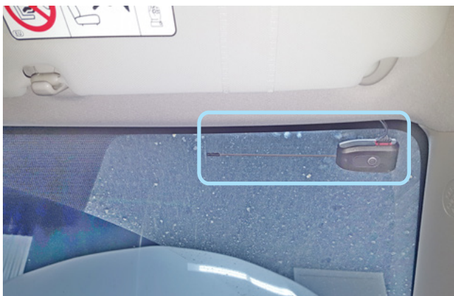
Фото 2.1. Возможное место установки антенного модуля
