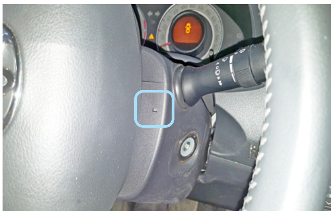
Фото 1.9. Фиксатор нижней части кожуха справа
