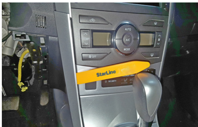
Фото 1.17. Снять нижнюю накладку центральной консоли
