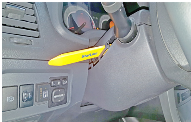
Фото 1.10. Снять нижнюю часть кожуха рулевого вала
