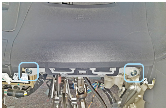
Фото 1.13. Болты крепления подушки безопасности снизу
