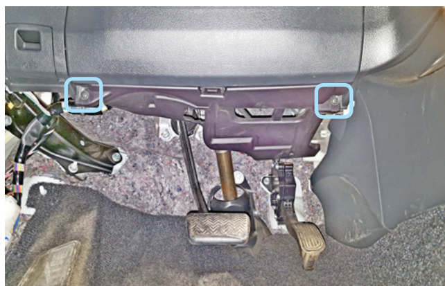
Фото 1.6. Саморезы крепления накладки педального узла
