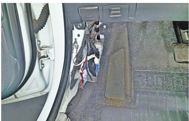
Фото 1.5. Накладка левой кик-панели снята
