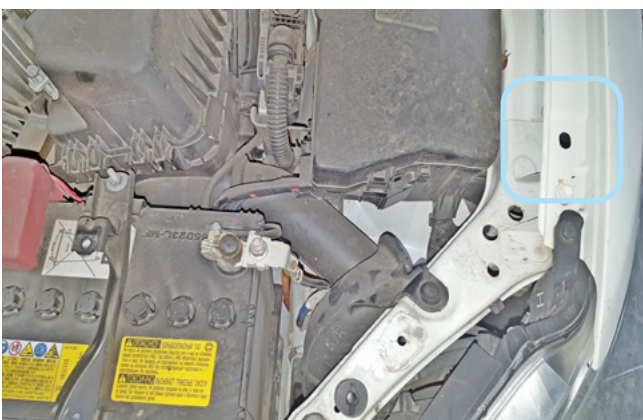
Фото 2.5. Возможное место установки концевика капота
