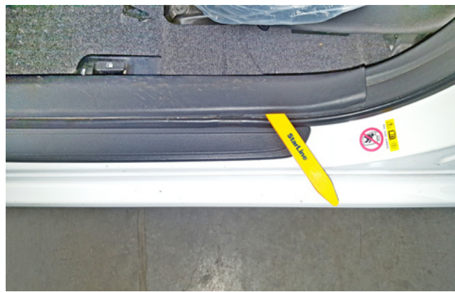
Фото 1.2. Снять накладку порога двери водителя
