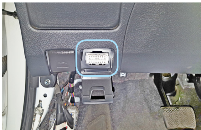
Фото 3.2. Местоположение диагностического разъёма
