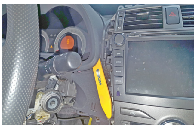
Фото 1.19. Снять накладку панели приборов
