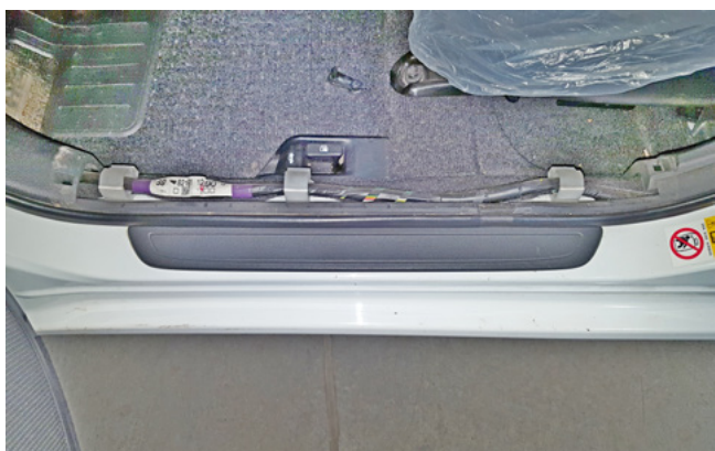
Фото 1.3. Накладка порога снята
