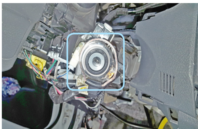
Фото 3.11. Расположение антенны модуля VP-03 на замке зажигания
