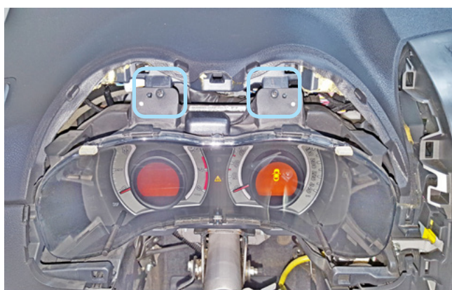
Фото 1.21. Накладка снята. Саморезы крепления панели приборов
