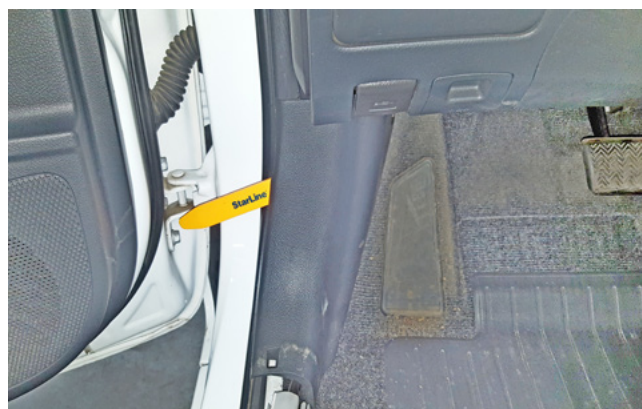
Фото 1.4. Снять накладку левой кик-панели
