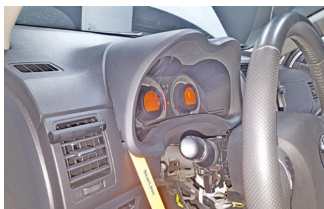
Фото 1.20. Снять накладку панели приборов
