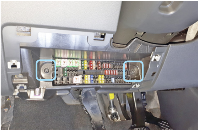
Фото 1.9. Саморезы блока предохранителей
