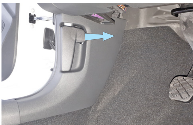
Фото 1.3. Сдвинуть фиксатор ручки отпирания капота
