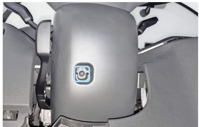
Фото 1.11. Винт крепления нижней части кожуха рулевого вала
