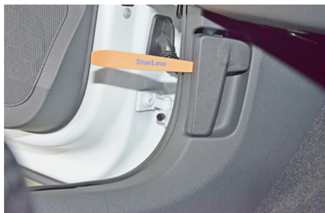
Фото 1.4. Снять ручку отпирания капота
