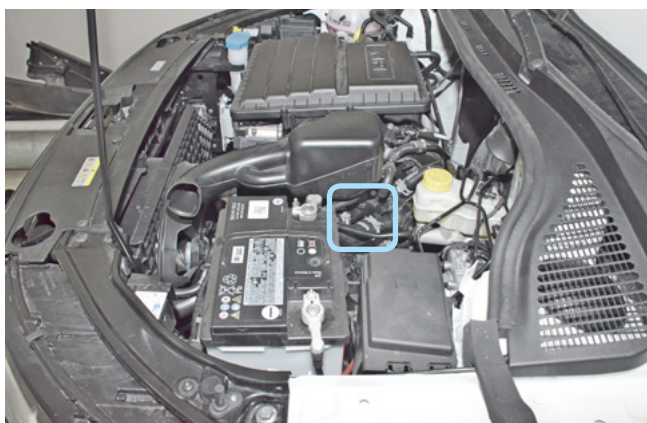
Фото 2.5. Место установки датчика температуры двигателя
