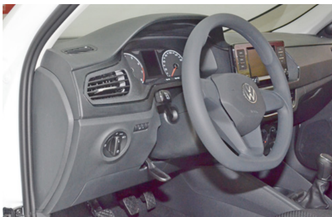
Фото 1.1. Пластиковая накладка под рулевой колонкой. Общий вид
