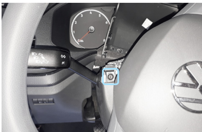
Фото 1.12. Винт крепления нижней части кожаной рулевого вала слева
