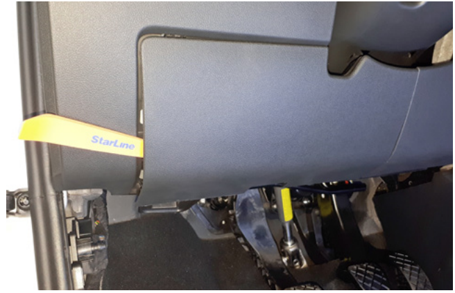
Фото 1.8. Снять крышку блока предохранителей
