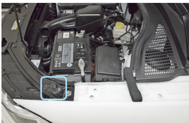
Фото 2.7. Возможное место установки концевика капота
