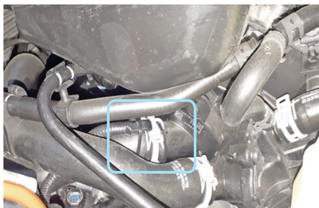
Фото 2.6. Крепление датчика температуры двигателя
