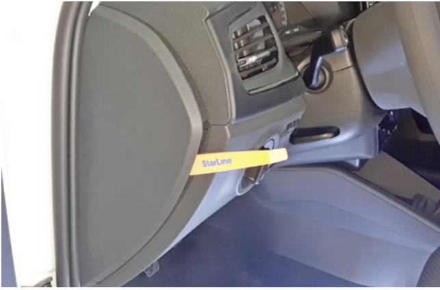
Фото 1.7. Снять левую боковую накладку передней панели
