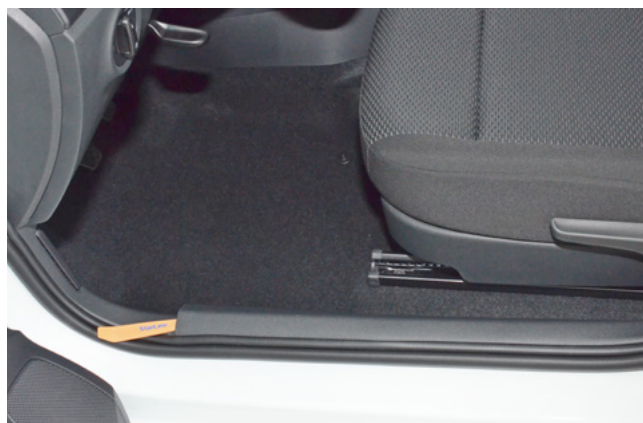
Фото 1.2. Снять декоративную накладку порога двери водителя
