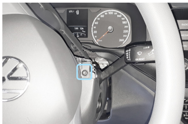
Фото 1.13. Винт крепления нижней части кожаной рулевого вала справа
