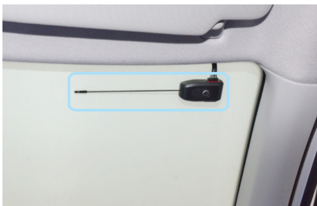
Фото 2.1. Возможное место установки антенного модуля
