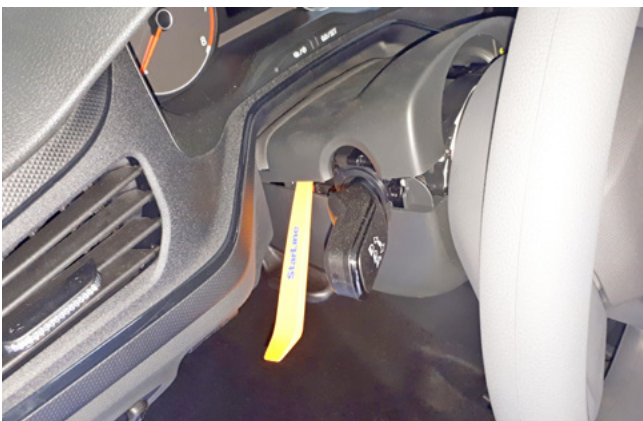
Фото 1.10. Снять верхнюю часть кожуха рулевого вала
