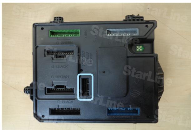
Фото 8.3. Местоположение разъёма A BLACK на блоке BCM
