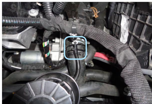
Фото 3.4. Крепление датчика температуры двигателя
