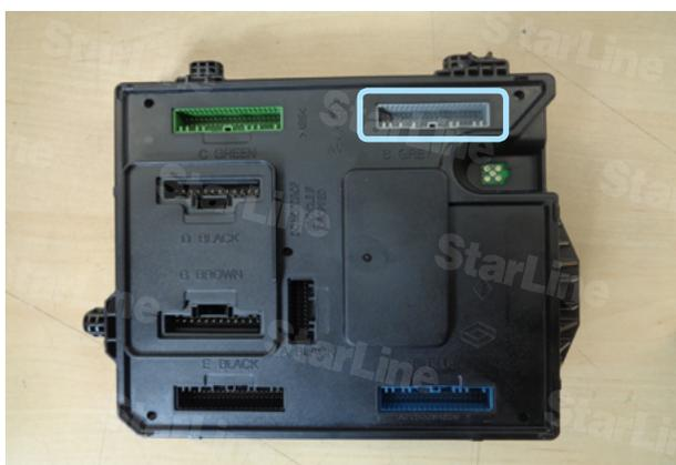
Фото 6.1. Местоположение разъёма B GRAY на блоке BCM
