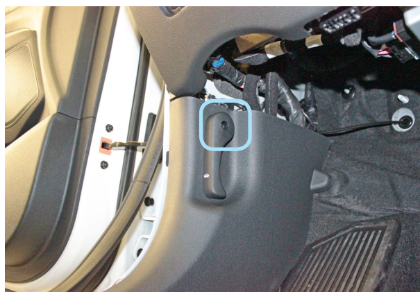
Фото 1.6. Винт крепления ручки отпирания капота
