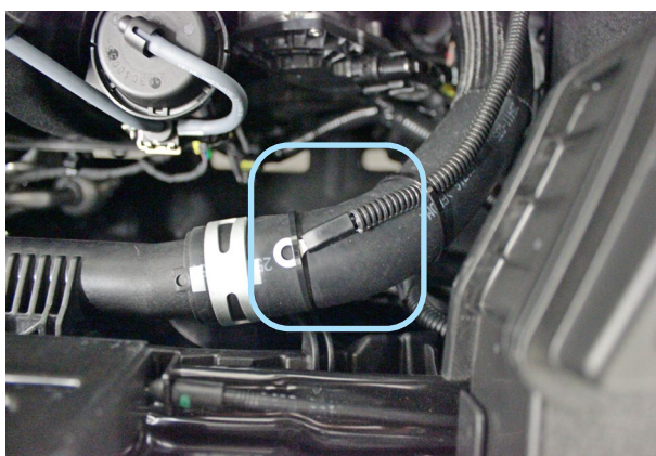
Фото 3.4. Крепление датчика температуры двигателя
