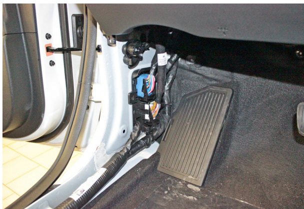
Фото 1.7. Накладка левой кик-панели снята
