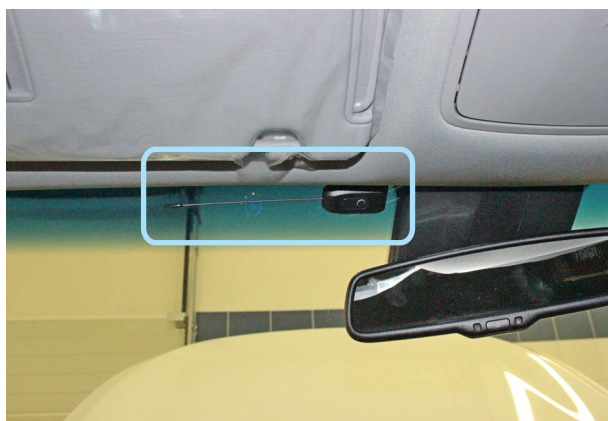
Фото 2.1. Возможное место установки антенного модуля
