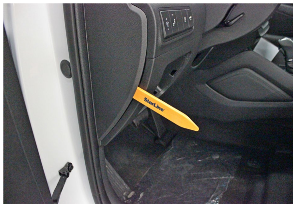
Фото 1.2. Снять боковую накладку передней панели
