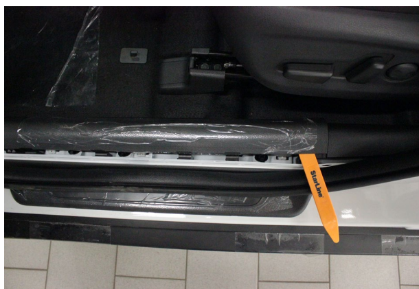
Фото 1.5. Снять накладку левого порога
