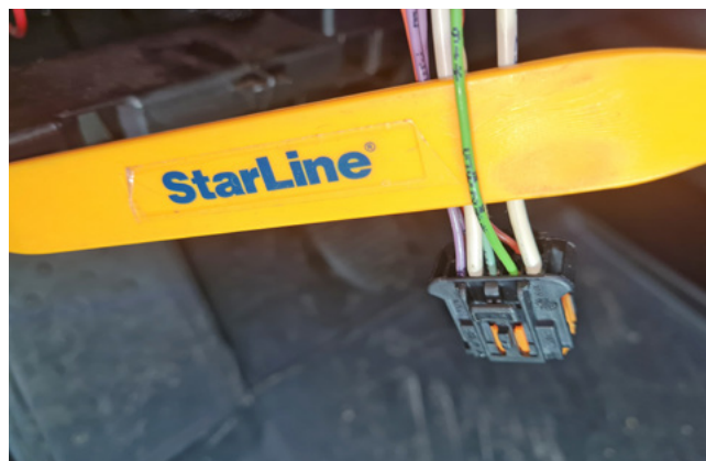
Фото 3.7. Альтернативное управление световыми сигналами (зелёный)
