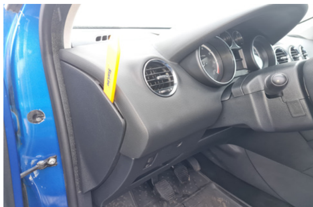
Фото 1.2. Снять левую боковую накладку передней панели
