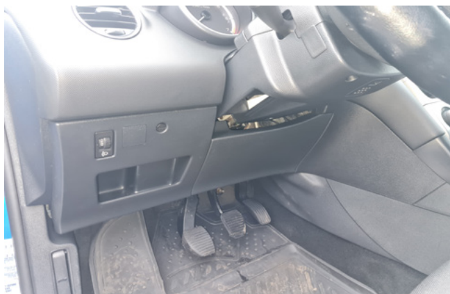
Фото 1.1. Пластиковая накладка слева от рулевой колонки. Общий вид
