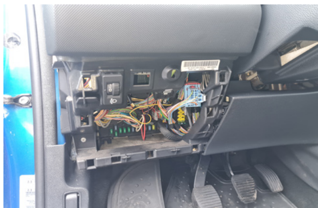
Фото 1.5. Накладка слева от рулевой колонки снята
