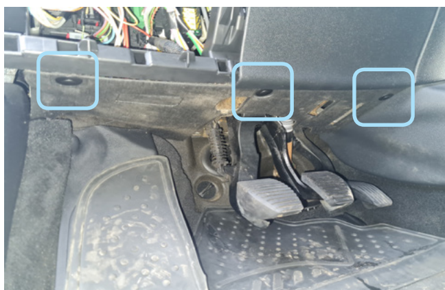
Фото 1.6. Пластиковая накладка педального узла. Клипсы крепления
