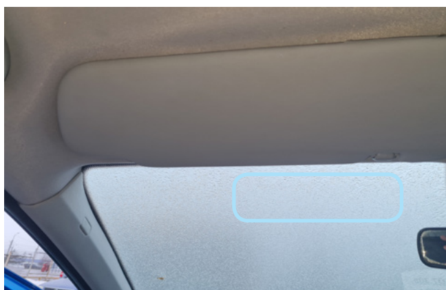
Фото 2.1. Возможное место установки антенного модуля
