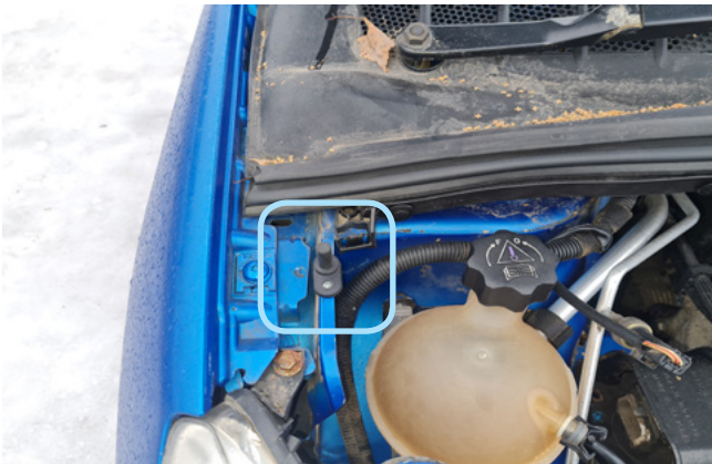
Фото 2.6. Возможное место установки концевика капота
