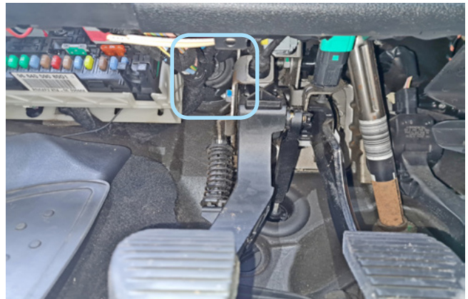
Фото 2.7. Штатный уплотнитель. Вид со стороны салона
