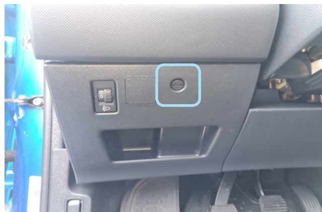
Фото 1.4. Повернуть фиксатор на 90 градусов
