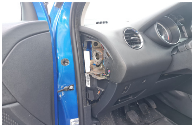
Фото 1.3. Боковая накладка снята
