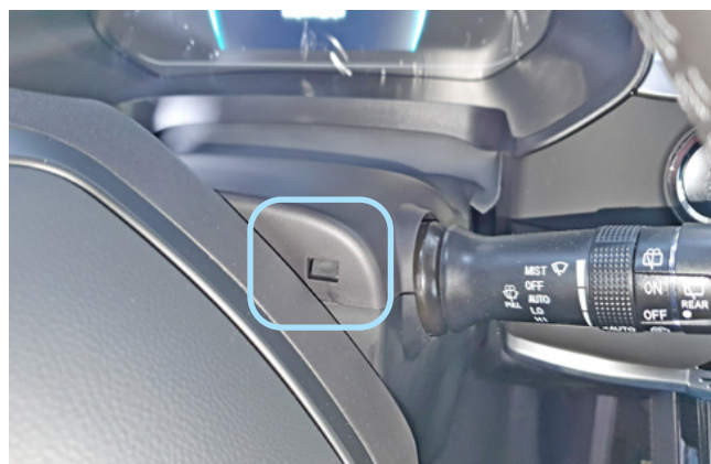
Фото 1.13. Защёлка крепления нижней части кожуха рулевого вала справа
