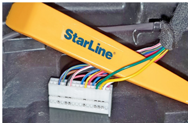
Фото 3.3. Шина CAN-A (жёлтый и зелёный)
