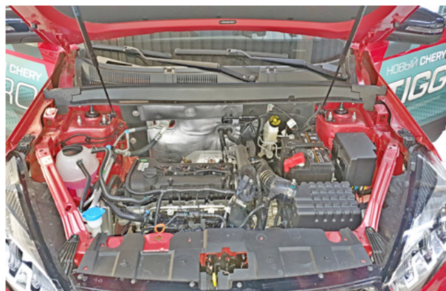
Фото 2.3. Пластиковая декоративная накладка снята
