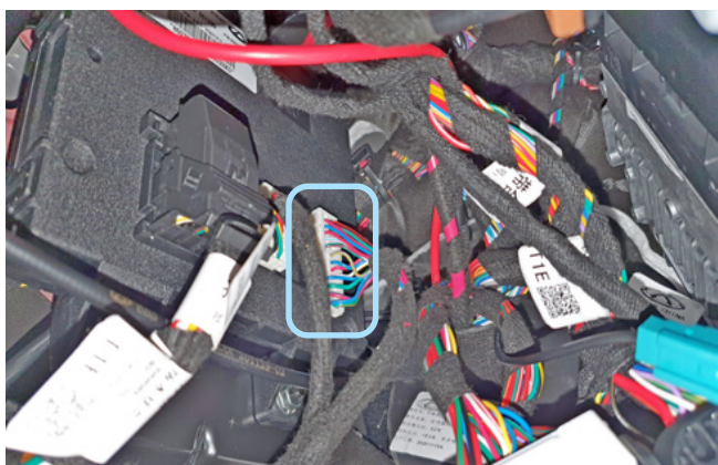
Фото 3.4. Местоположение разъёма на блоке BCM
