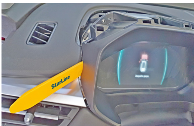
Фото 1.18. Снять декоративную накладку панели приборов
