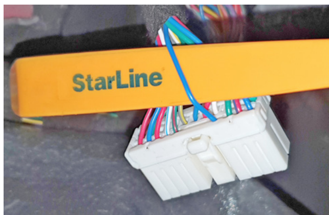
Фото 3.5. Управление штатной сиреной (синий)
