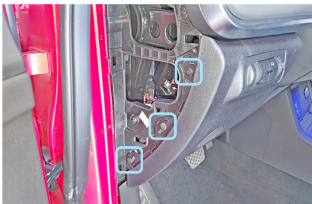
Фото 1.3. Саморезы крепления пластиковой накладки под рулевой колонкой
