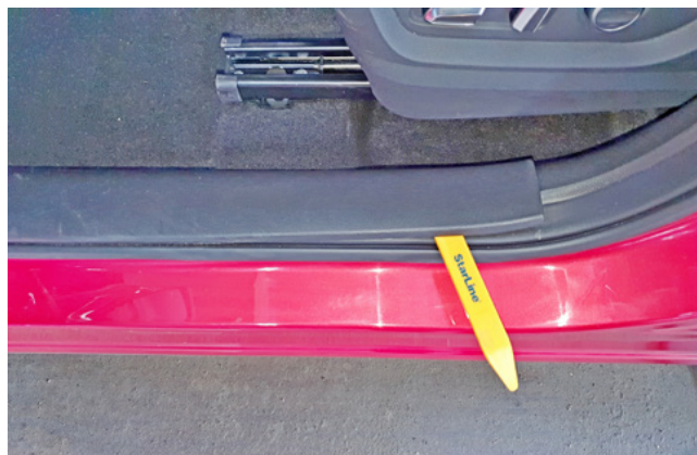
Фото 1.6. Снять накладку порога двери водителя
