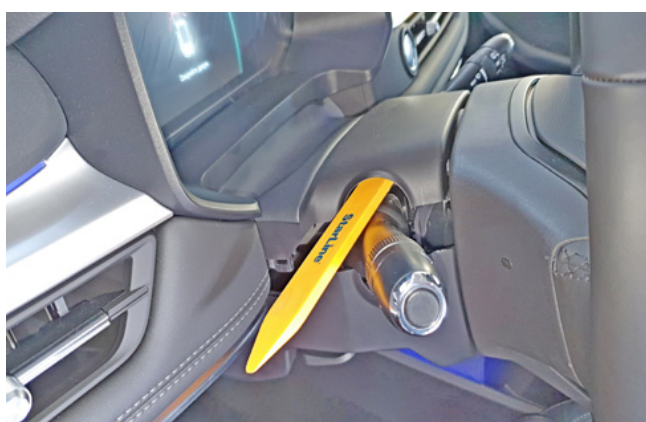
Фото 1.14. Снять нижнюю часть кожуха рулевого вала
