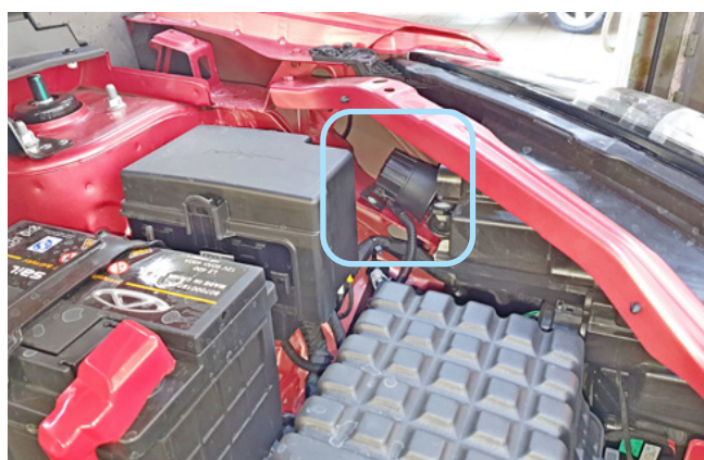
Фото 2.4. Возможное место установки сирены
