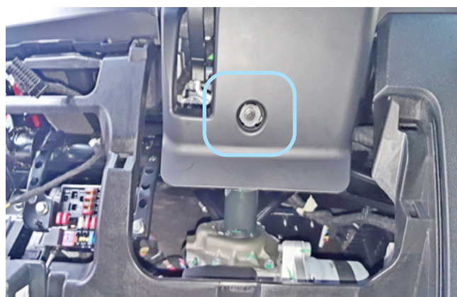
Фото 1.11. Саморез крепления нижней части кожуха рулевого вала
