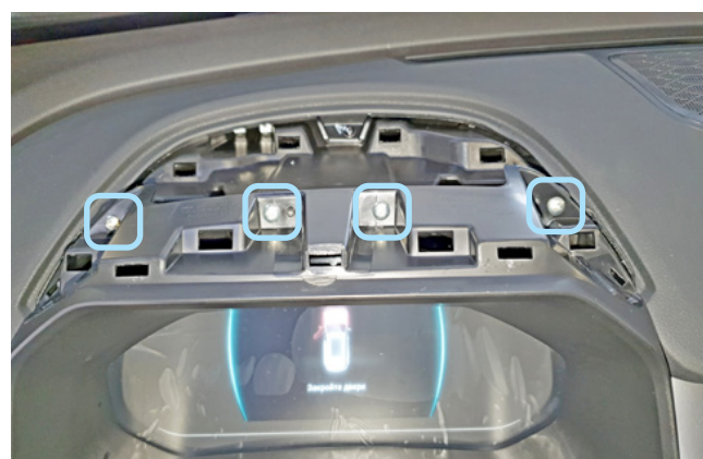
Фото 1.17. Саморезы крепления декоративной наклад-ки панели приборов
