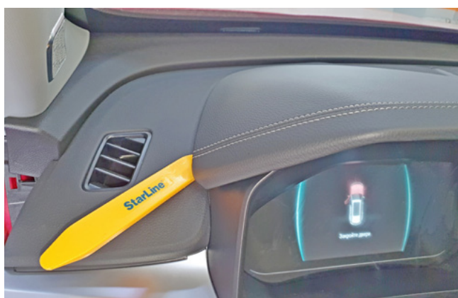
Фото 1.16. Снять солнцезащитный козырёк панели приборов
