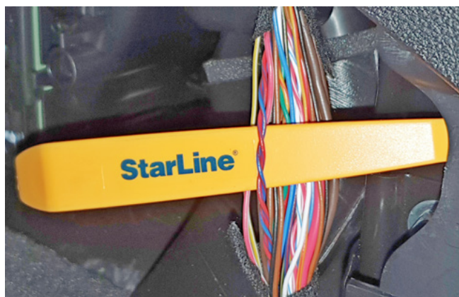
Фото 3.12. Провода антенны штатного иммобилайзера (красно-синий и сине-красный)
