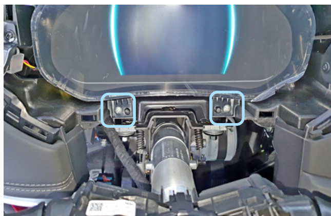
Фото 1.19. Саморезы крепления панели приборов
