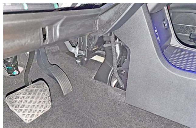
Фото 1.22. Накладка центрального тоннеля снята
