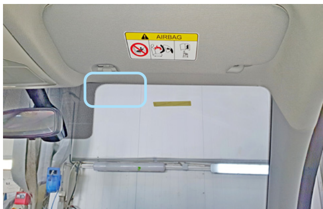
Фото 2.1. Возможное место установки антенного модуля
