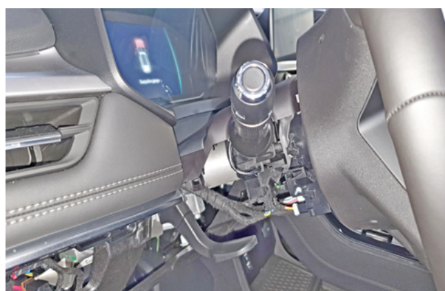
Фото 1.15. Нижняя часть кожуха рулевого вала снята
