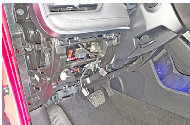
Фото 1.4. Пластиковая накладка под рулевой колонкой снята
