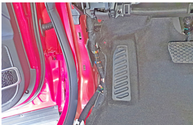
Фото 1.9. Накладка левой кик-панели снята
