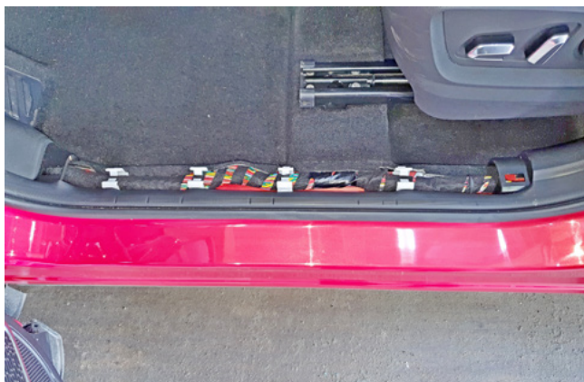
Фото 1.7. Накладка порога двери водителя снята
