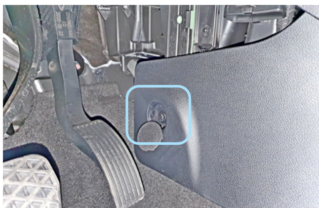
Фото 1.21. Болт крепления накладки центрального тоннеля
