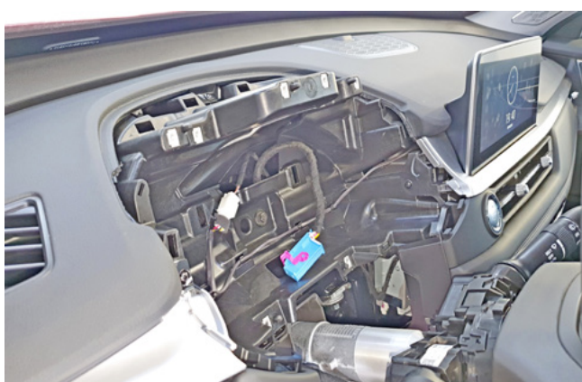
Фото 1.20. Панель приборов снята
