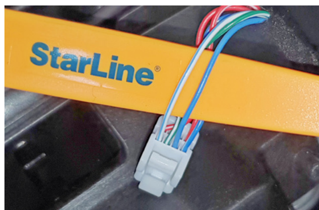
Фото 3.7. Управление кнопкой Старт-Стоп (синий и бело-синий)
