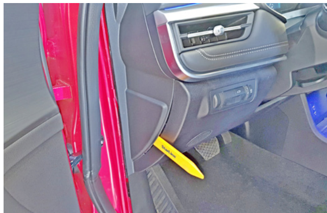
Фото 1.2. Снять боковую накладку передней панели
