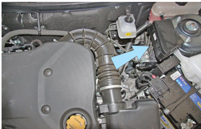
Фото 2.6. Возможное место установки подкапотного блока R6
