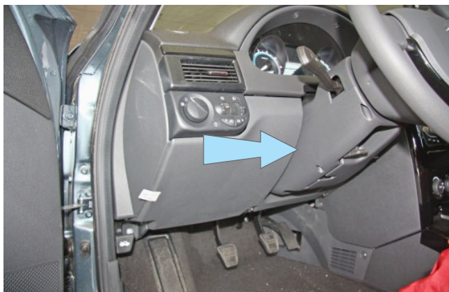
Фото 1.1. Кожух рулевого вала. Общий вид
