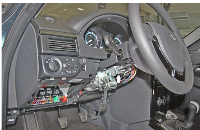
Фото 1.5. Нижняя часть кожуха рулевого вала снята
