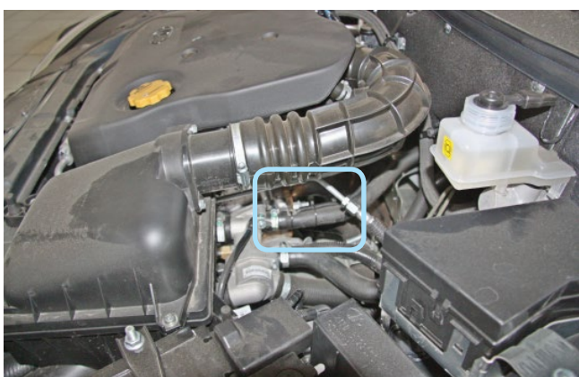
Фото 2.3. Место установки датчика температуры двигателя
