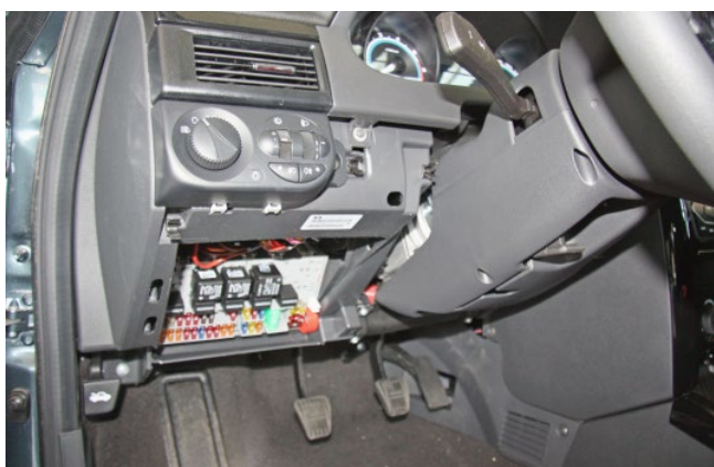
Фото 1.3. Пластиковая накладка снята
