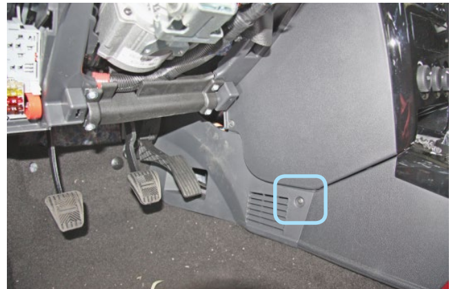
Фото 1.7. Саморез крепления боковой накладки
