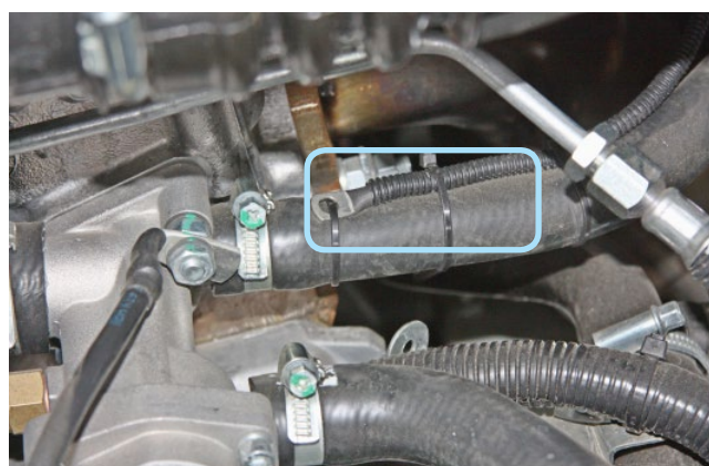
Фото 2.4. Крепление датчика температуры двигателя
