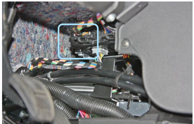
Фото 1.9. Болт и гайка крепления блока ВСМ
