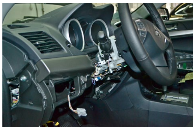
Фото 1.18. Кожух рулевого вала снят
