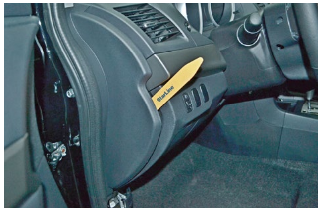
Фото 1.8. Снять левую боковую накладку передней панели
