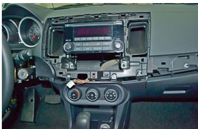
Фото 1.27. Декоративная накладка магнитолы снята
