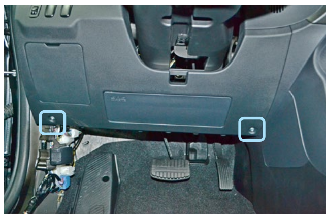
Фото 1.10. Саморезы крепления накладки под рулевой колонкой
