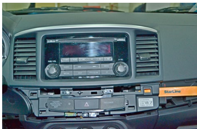
Фото 1.26. Снять декоративную накладку магнитолы
