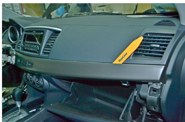
Фото 1.22. Снять продольную декоративную накладку передней панели
