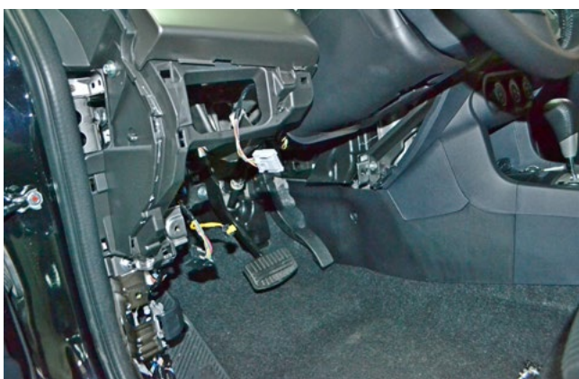
Фото 1.13. Подушка безопасности снята
