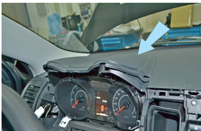
Фото 1.29. Верхняя накладка панели приборов
