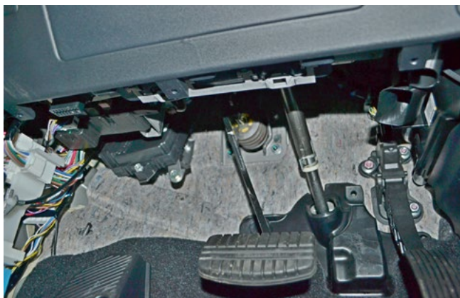
Фото 1.7. Накладка педального узла снята
