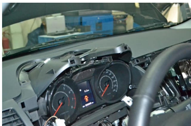
Фото 1.30. Верхняя накладка панели приборов снята
