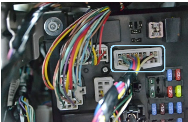
Фото 3.3. Местоположение разъёма на блоке ETACS
