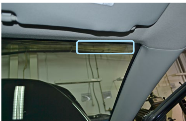
Фото 2.1. Возможное место установки антенного модуля
