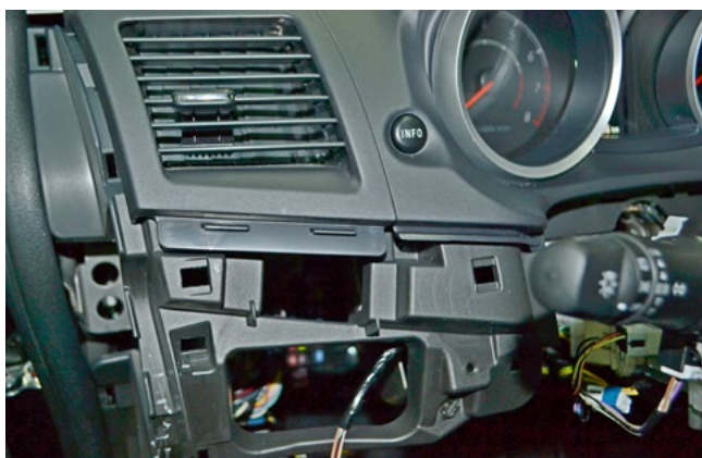
Фото 1.25. Левая накладка передней панели снята
