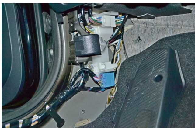
Фото 1.4. Пластиковая накладка левой кик-панели снята
