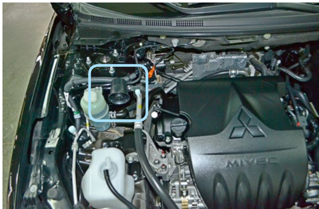
Фото 2.3. Возможное место установки сирены
