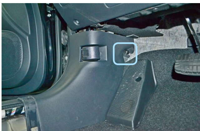
Фото 1.3. Клипса крепления накладки левой кик-панели
