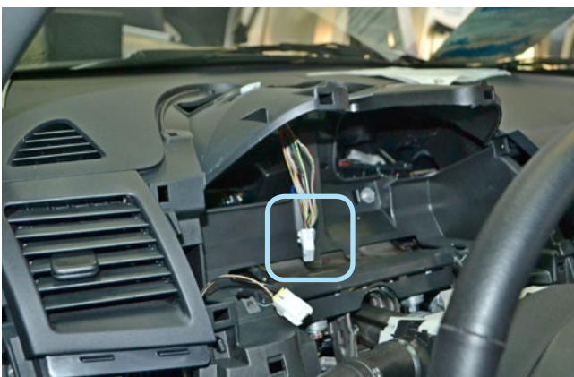
Фото 3.2. Местоположение разъёма панели приборов
