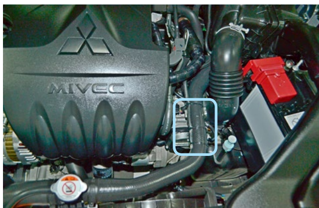
Фото 2.5. Место установки датчика температуры двигателя
