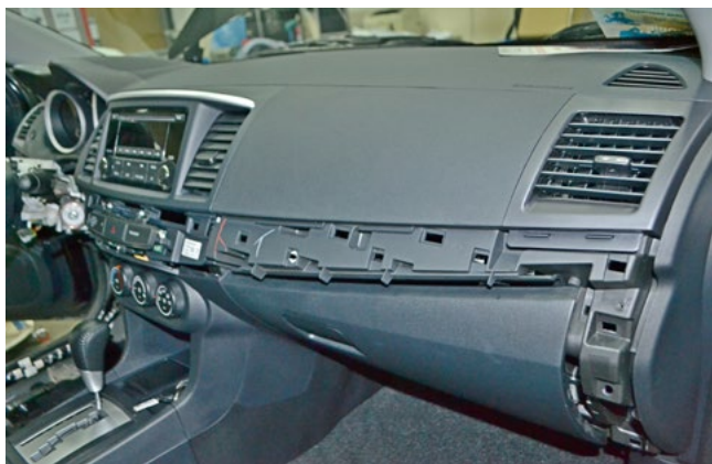
Фото 1.23. Продольная накладка передней панели снята
