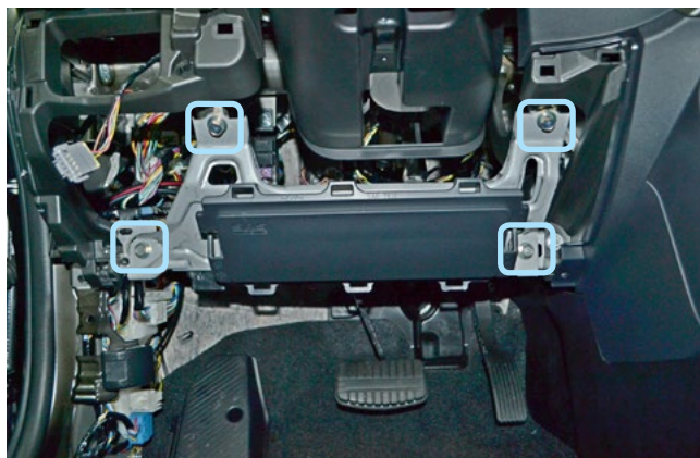
Фото 1.12. Болты крепления коленной подушки безопасности водителя
