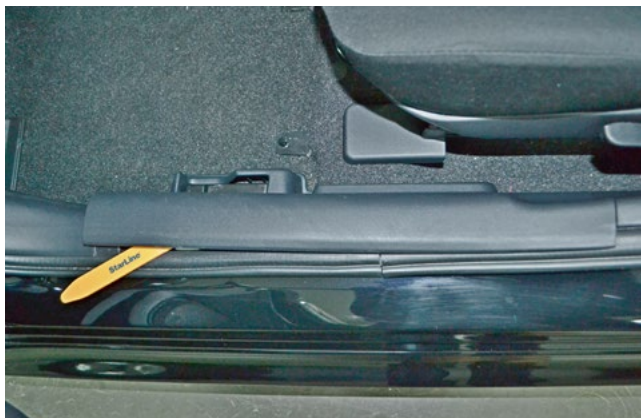
Фото 1.1. Снять накладку порога двери водителя
