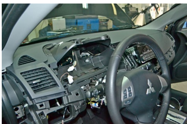
Фото 1.32. Панель приборов снята
