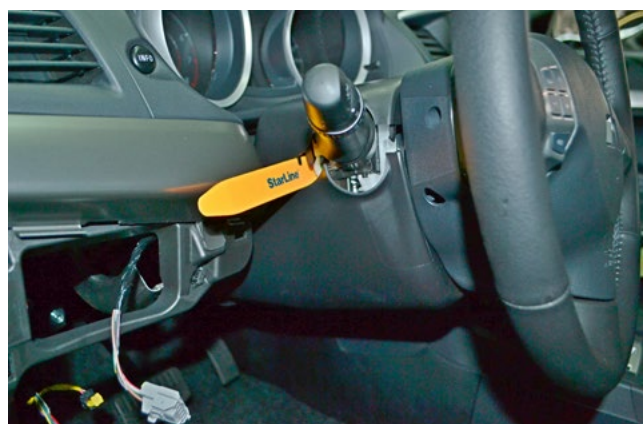
Фото 1.16. Снять верхнюю часть кожуха рулевого вала
