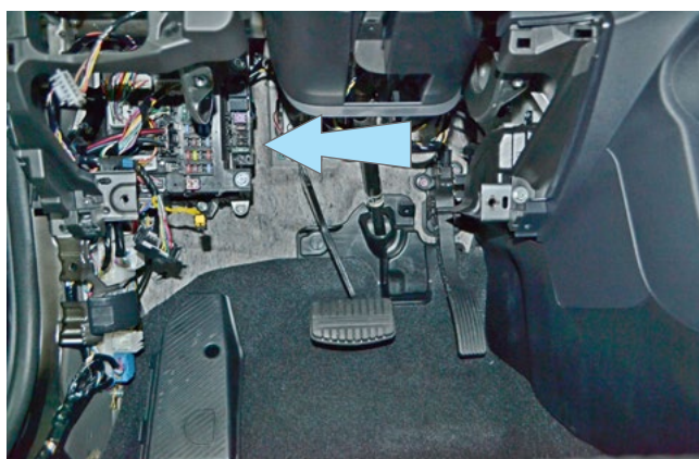
Фото 1.14. Местоположение блока ETACS
