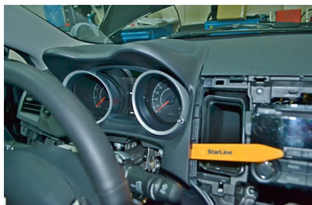
Фото 1.28. Снять пластиковую накладку панели приборов
