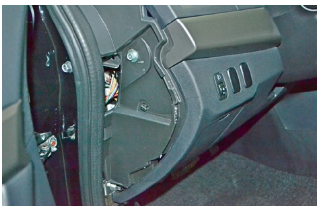
Фото 1.9. Левая боковая накладка передней панели снята
