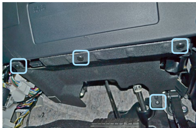
Фото 1.6. Клипсы крепления накладки педального узла
