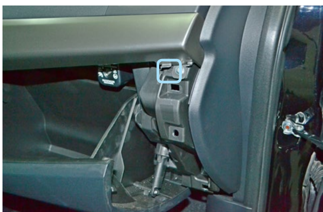
Фото 1.21. Пластиковая накладка справа от перчаточного ящика снята. Саморез
