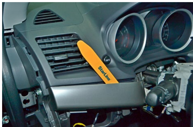
Фото 1.24. Снять левую декоративную накладку передней панели
