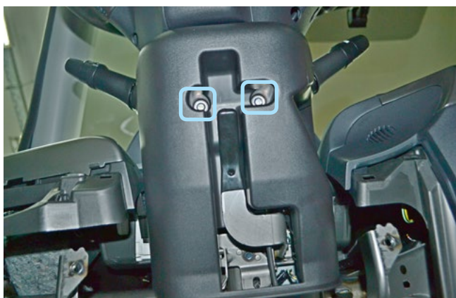
Фото 1.17. Саморезы крепления нижней части кожуха рулевого вала
