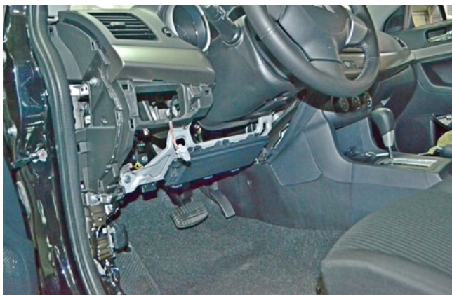
Фото 1.11. Накладка под рулевой колонкой снята
