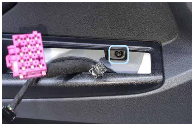
Фото 1.13. Саморез крепления внутренней обшивки двери водителя
