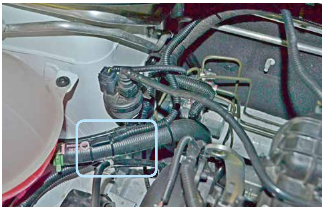
Фото 2.4. Место установки датчика температуры двигателя
