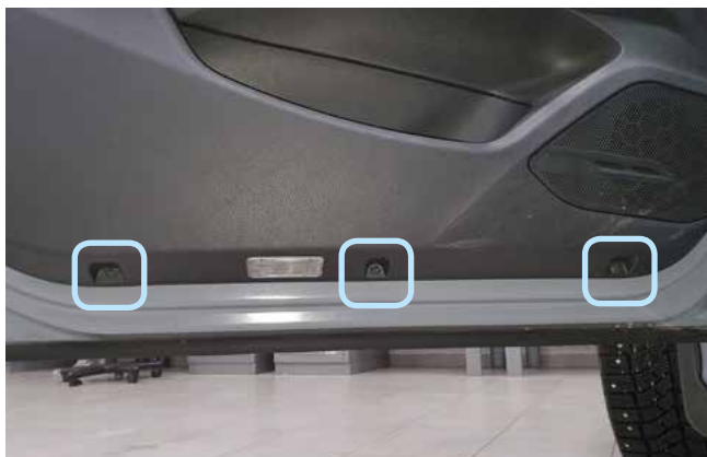
Фото 1.15. Саморезы крепления внутренней обшивки двери водителя
