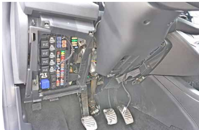
Фото 1.2. Накладка под рулевой колонкой снята
