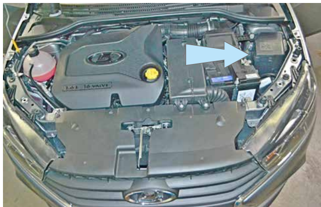
Фото 2.9. Возможное место установки подкапотного блока R6
