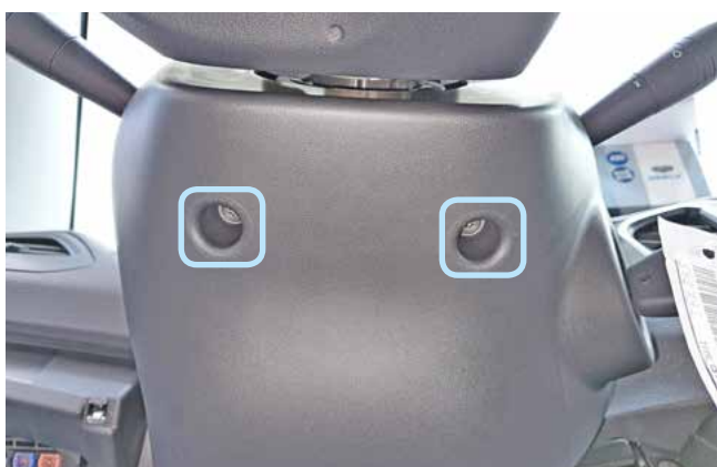
Фото 1.3. Саморезы крепления кожуха рулевого вала
