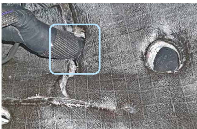
Фото 2.6. Штатный уплотнитель. Вид со стороны салона
