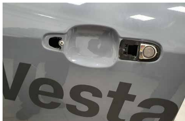
Фото 1.18. Ручка двери водителя снята
