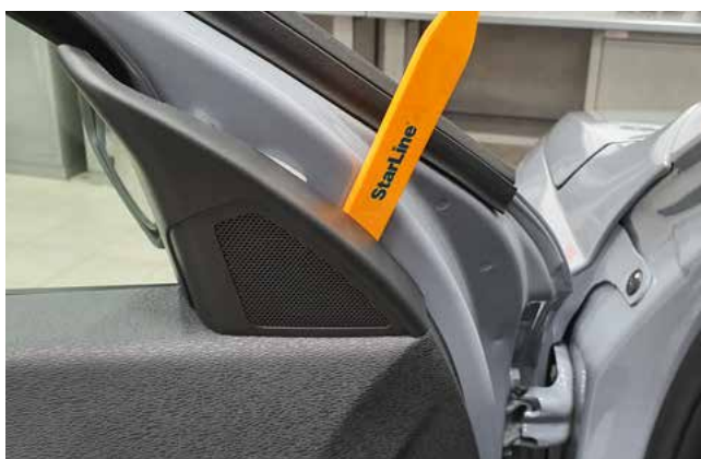
Фото 1.9. Снять пластиковую накладку динамика
