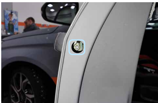
Фото 1.17. Саморез крепления ручки двери водителя
