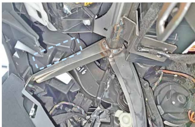
Фото 2.10. Пример расположения центрального блока охранно-телематического комплекса
