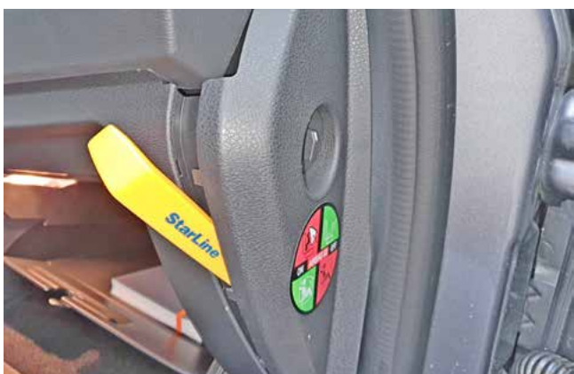
Фото 1.5. Снять правую накладку передней панели
