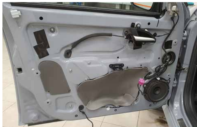
Фото 1.16. Обшивка двери водителя снята
