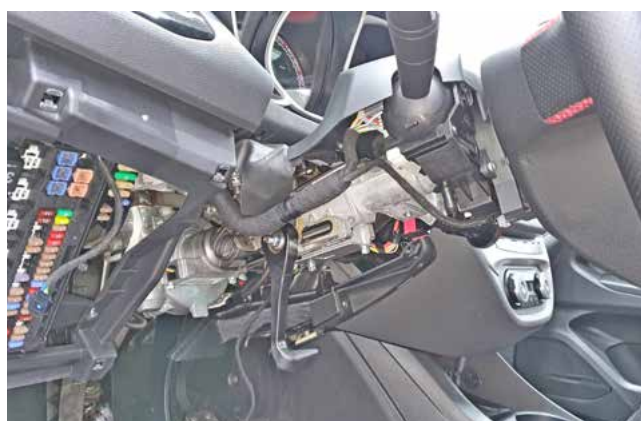
Фото 1.4. Нижняя часть кожуха рулевого вала снята
