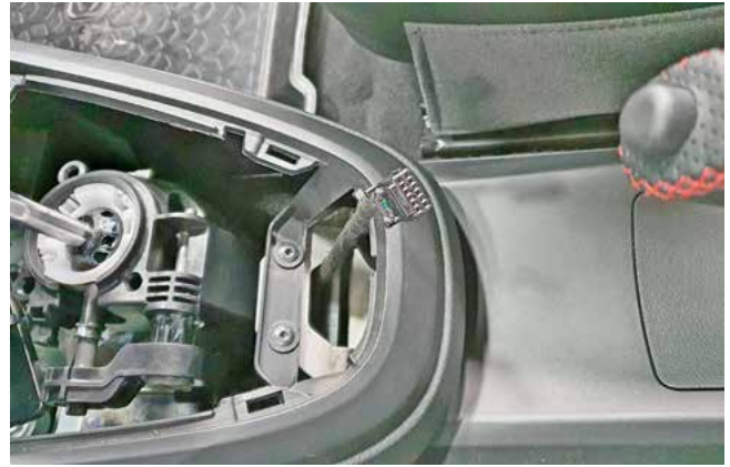
Фото 1.20. Накладка коробки передач снята
