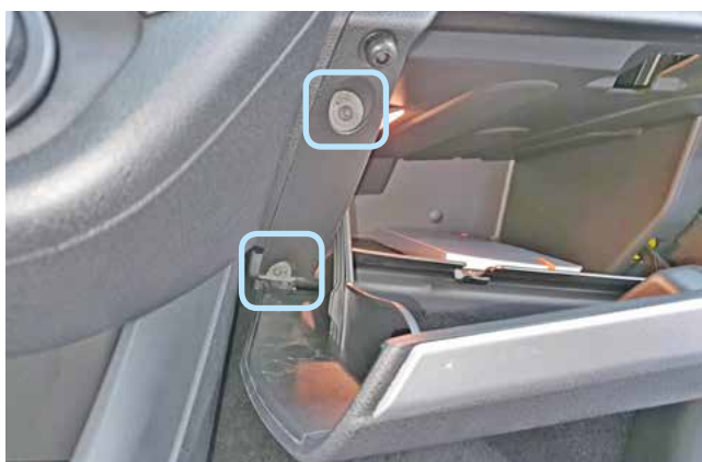
Фото 1.6. Саморезы крепления перчаточного ящика слева
