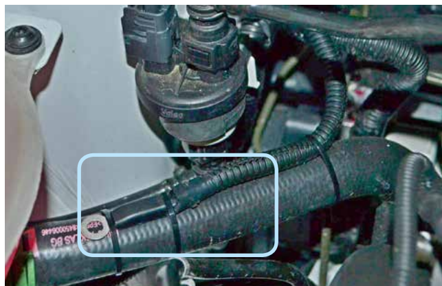
Фото 2.5. Крепление датчика температуры двигателя
