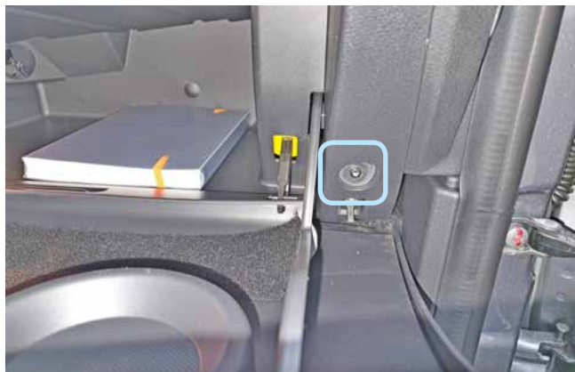
Фото 1.7. Саморез крепления перчаточного ящика справа
