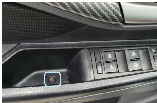
Фото 1.11. Саморез крепления ручки двери водителя
