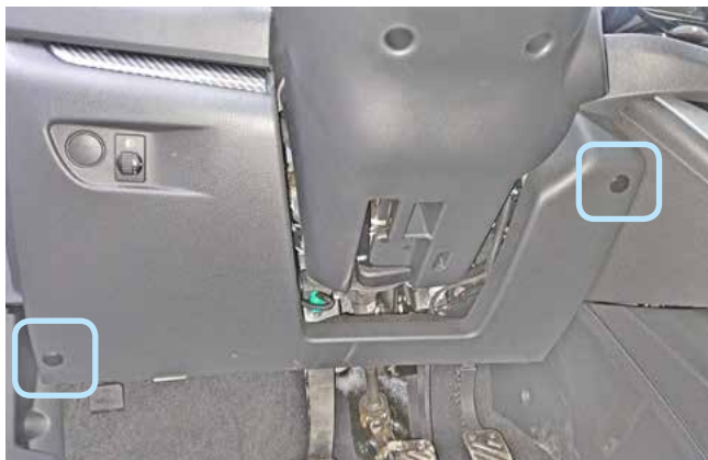
Фото 1.1. Клипсы крепления накладки под рулевой колонкой
