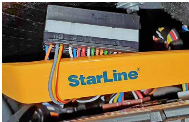
Фото 3.4. Шина CAN-A (жёлто-красный и серый)
