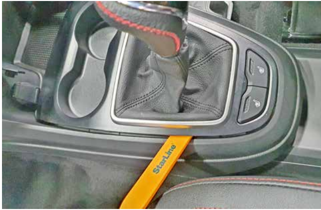
Фото 1.19. Снять накладку коробки передач
