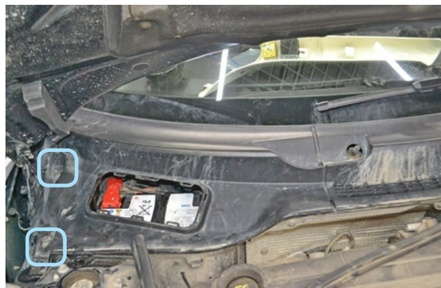
Фото 2.7. Гайки крепления накладки под правым дворником
