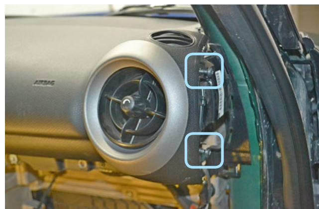
Фото 1.21. Саморезы крепления накладки правого воздуховода
