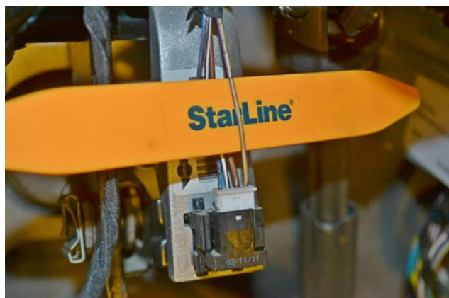
Фото 3.10. Концевик педали тормоза (фиолетово-жёлтый)
