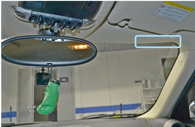
Фото 2.1. Возможное место установки антенного модуля
