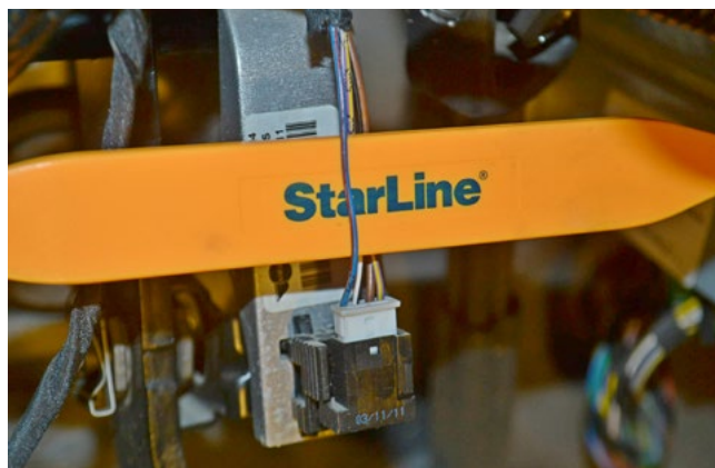
Фото 3.8. Концевик педали тормоза (сине-красный)
