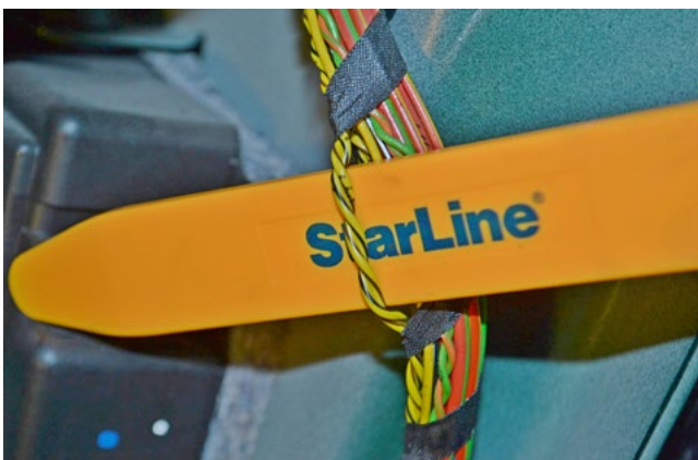
Фото 3.4. Шина CAN-B (жёлто-чёрный и жёлто-коричневый)
