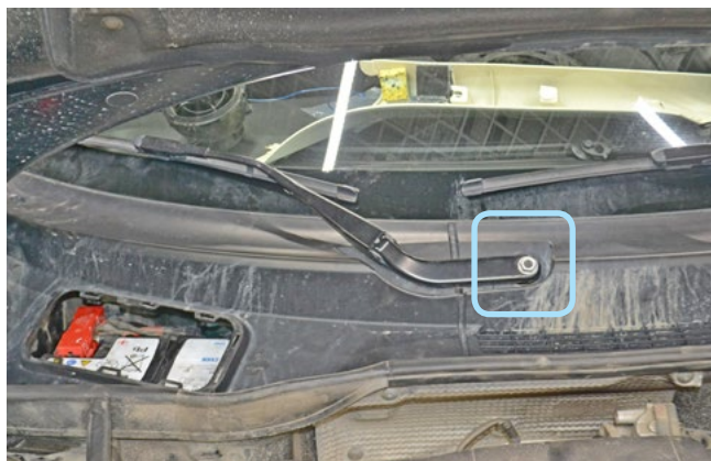
Фото 2.6. Гайка крепления переднего правого дворника
