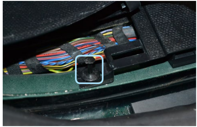
Фото 1.13. Клипса крепления накладки правой кик-панели и порога передней правой двери
