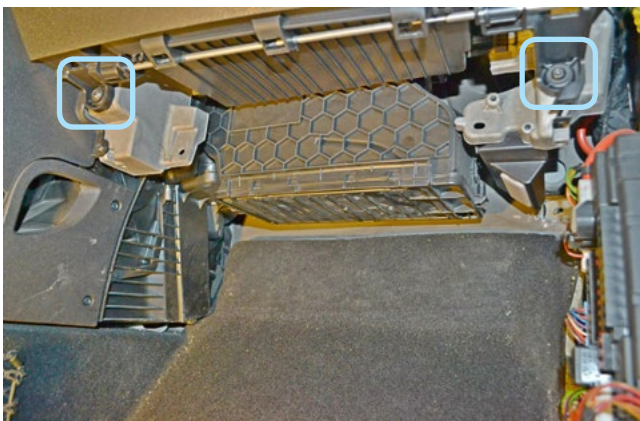
Фото 1.16. Саморезы крепления перчаточного ящика
