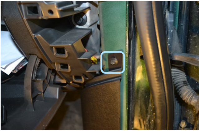
Фото 1.12. Болт крепления накладки правой кик-панели и порога передней правой двери
