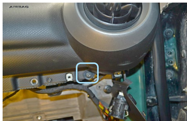
Фото 1.20. Саморез крепления накладки правого воздуховода
