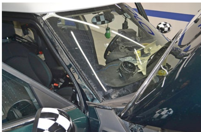
Фото 2.5. Наружная накладка передней правой стойки снята
