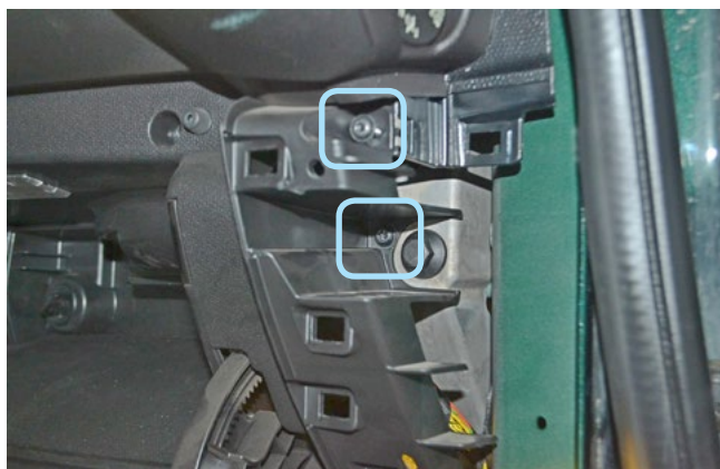
Фото 1.18. Саморезы крепления перчаточного ящика
