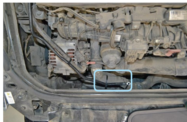
Фото 2.11. Место установки датчика температуры двигателя
