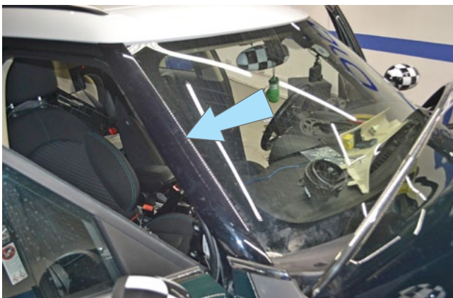
Фото 2.3. Наружная накладка передней правой стойки
