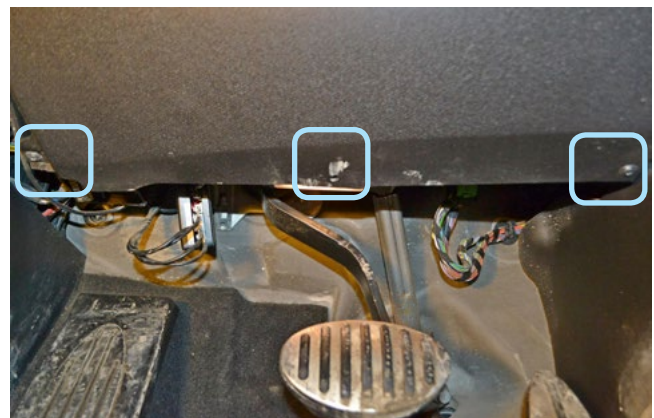
Фото 1.4. Саморезы крепления накладки под рулевой колонкой
