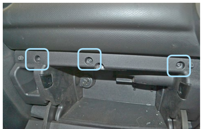
Фото 1.17. Саморезы крепления перчаточного ящика
