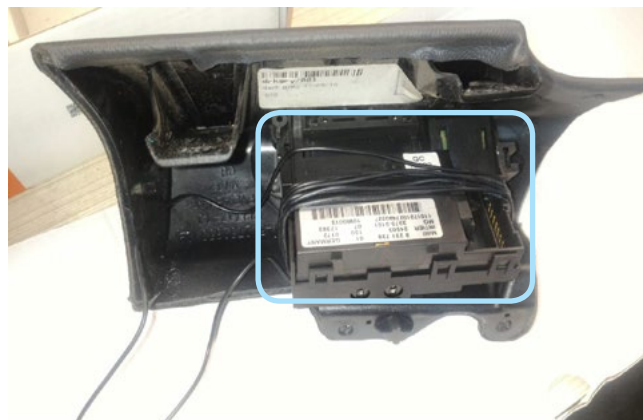
Фото 3.12. Расположение антенны модуля BP-03 на слоте ключа
