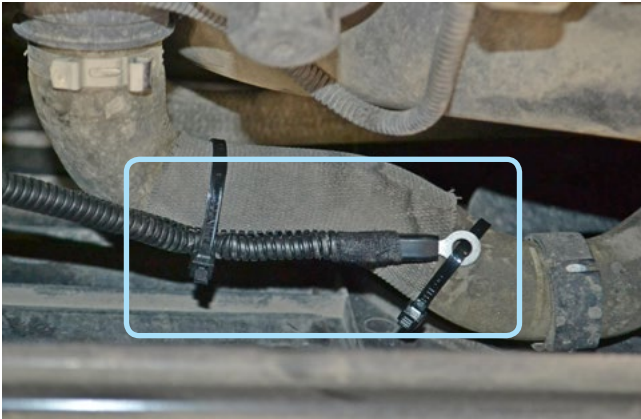
Фото 2.12. Крепление датчика температуры двигателя
