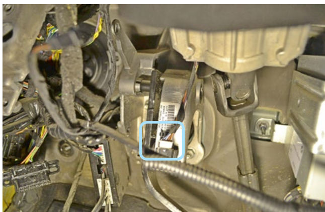
Фото 3.7. Местоположение разъёма педали тормоза
