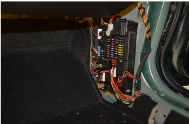
Фото 1.14. Накладка правой кик-панели и порога передней правой двери снята
