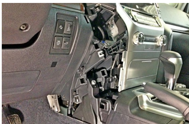
Фото 1.4. Декоративная накладка с кнопкой Старт-Стоп снята
