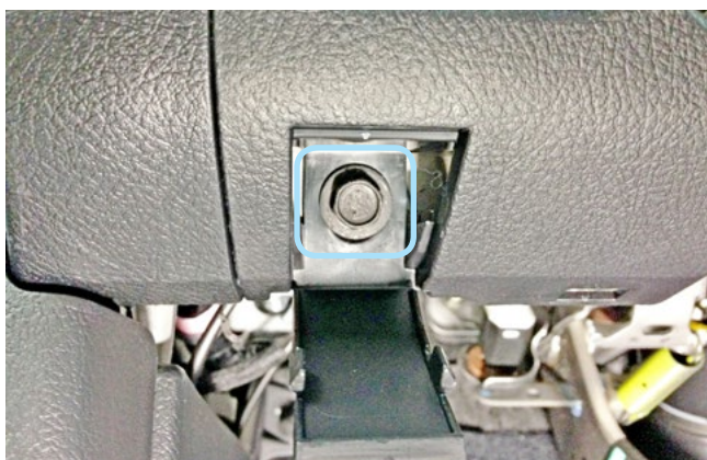
Фото 1.9. Болт крепления накладки под рулевой колонкой слева
