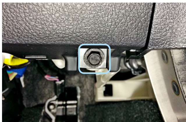
Фото 1.10. Болт крепления накладки под рулевой колонкой справа
