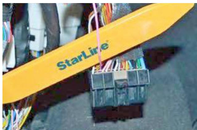
Фото 3.5. Шина данных штатного иммобилайзера (розовый)
