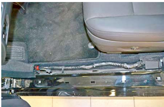
Фото 1.3. Накладка левого порога снята
