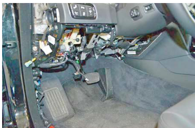
Фото 1.12. Накладка педального узла снята
