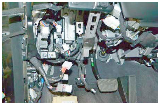
Фото 1.14. Монтажный блок предохранителей снят
