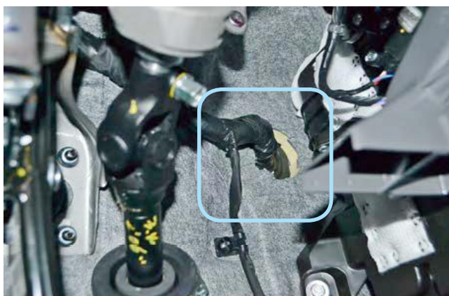
Фото 2.5. Штатный уплотнитель. Вид со стороны салона
