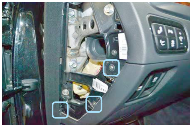
Фото 1.8. Накладка снята. Саморезы
