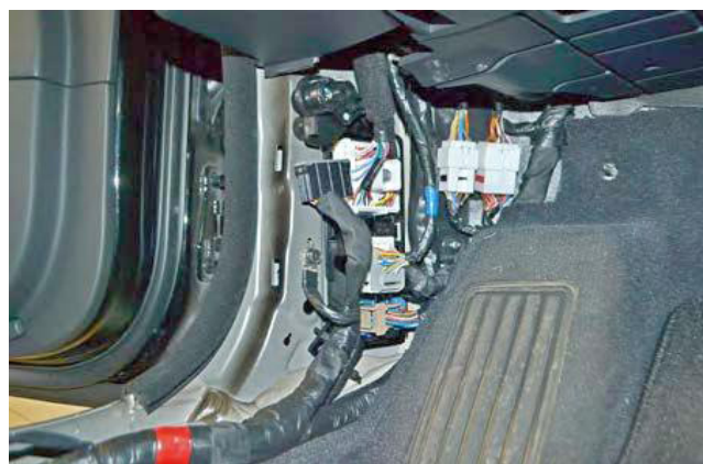
Фото 1.6. Накладка левой кик-панели снята
