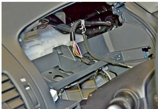
Фото 4.7. Панель приборов снята
