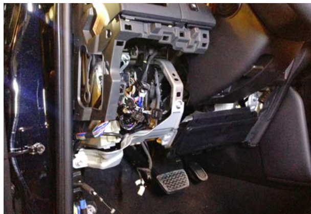
Фото 1.14. Накладка под рулевой колонкой снята
