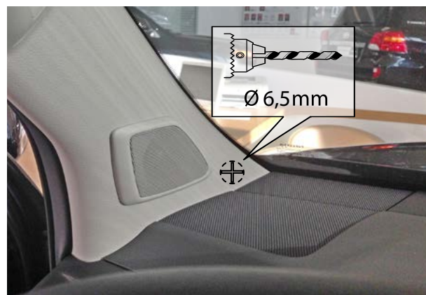
Фото 5.2. Место установки светодиода
