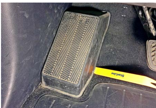
Фото 1.3. Снять площадку для ноги водителя
