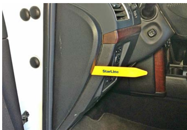
Фото 1.6. Снять левую боковую накладку передней панели
