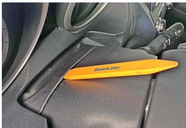
Фото 4.3. Снять пылезащитный кожух
