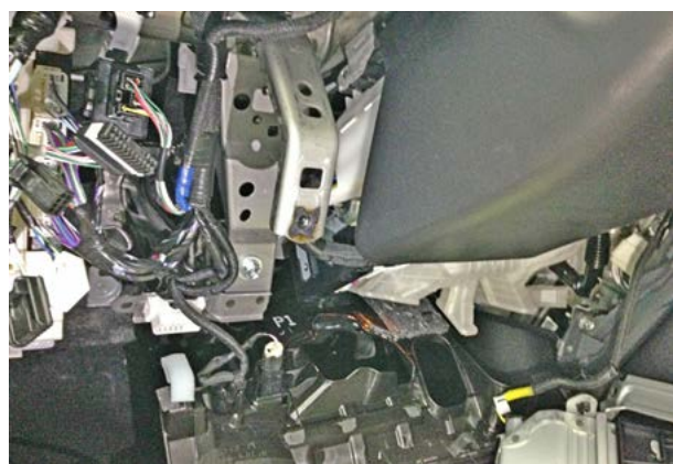
Фото 2.3. Коленная подушка безопасности водителя снята
