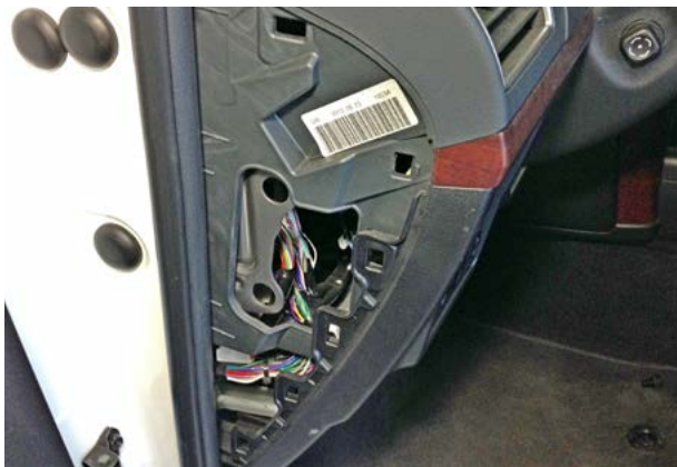
Фото 1.7. Левая боковая накладка передней панели снята
