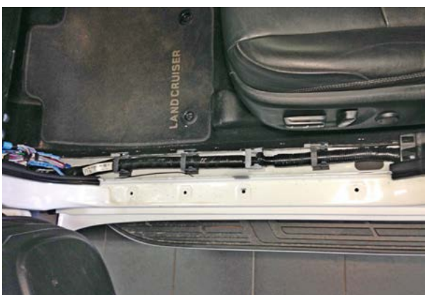
Фото 1.5. Накладки порога двери водителя и кик-панели сняты
