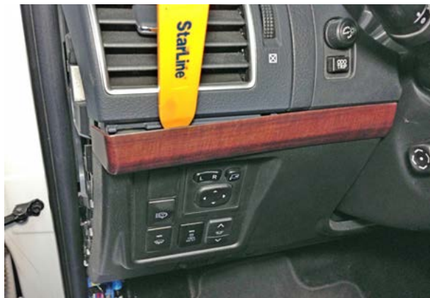
Фото 1.8. Снять декоративную накладку слева от рулевой колонки
