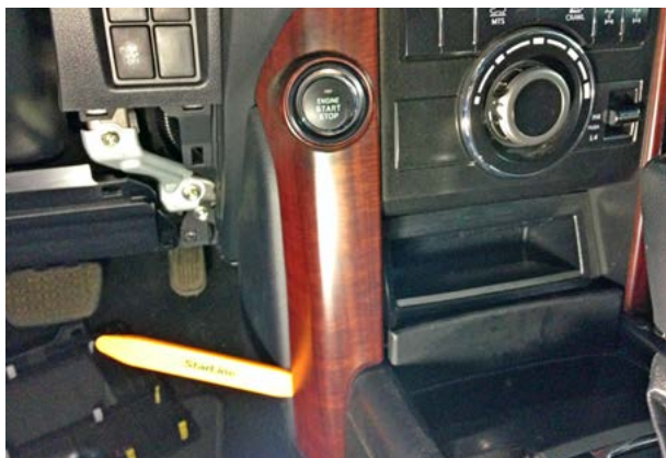
Фото 3.1. Снять декоративную накладку центральной консоли слева
