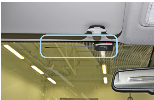
Фото 2.1. Возможное место установки антенного модуля
