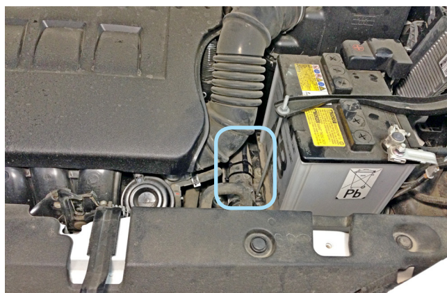
Фото 2.5. Место установки датчика температуры двигателя
