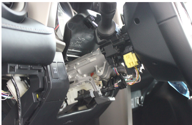
Фото 1.16. Кожух рулевого вала снят
