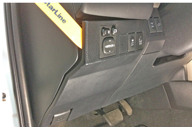
Фото 1.4. Снять декоративную накладку слева от рулевой колонки
