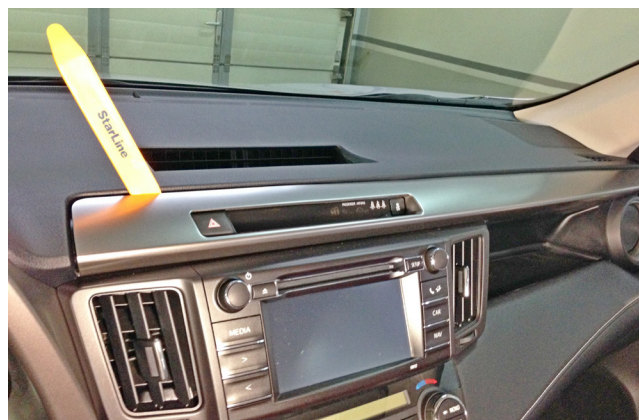
Фото 1.7. Снять верхнюю декоративную накладку
