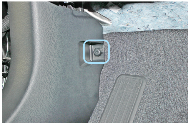
Фото 1.2. Клипса крепления накладки левой кик-панели
