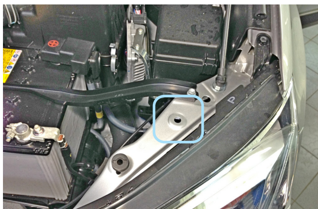
Фото 2.7. Возможное место установки концевика капота
