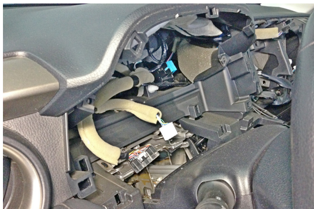
Фото 1.13. Панель приборов снята
