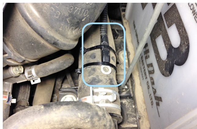
Фото 2.6. Крепление датчика температуры двигателя
