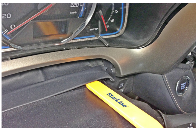
Фото 1.10. Снять пылезащитный кожух
