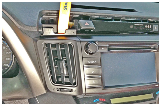
Фото 1.8. Снять воздуховод слева от магнитолы
