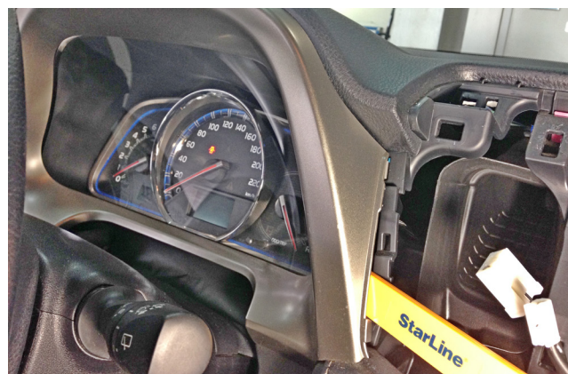
Фото 1.11. Снять декоративную накладку панели приборов
