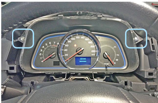
Фото 1.12. Саморезы крепления панели приборов
