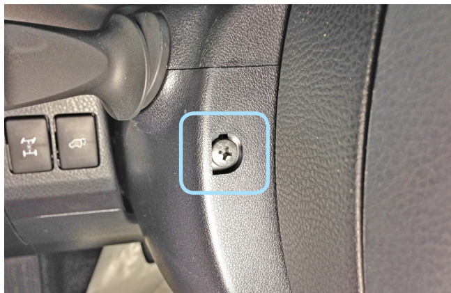
Фото 1.14. Саморез крепления кожуха рулевого вала слева
